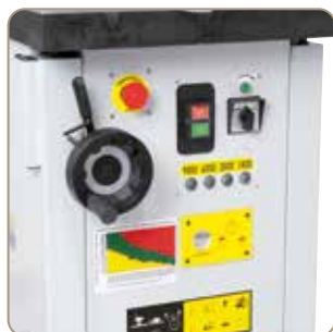
Minden lényeges kapcsolási és kezelői alkotóelem a gép jobb oldalán van elhelyezve
