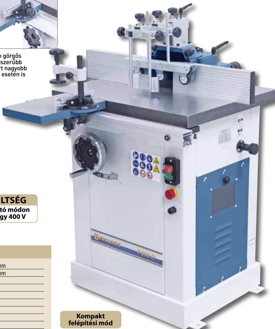
A maró-védősapka eloxált alumínium ütközősínekkel felszerelt
