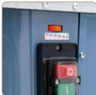
A fordulatszám egyszerű beállítása elektromos fordulatszám-szabályozóval.
