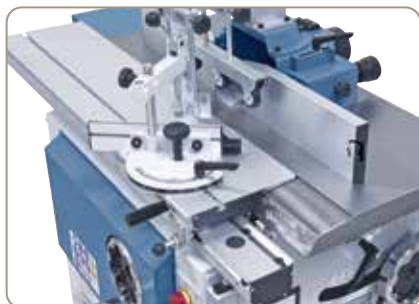
A sorozatszerű formázó-asztal megkönnyíti a nagyobb munkadarabok megmunkálását
