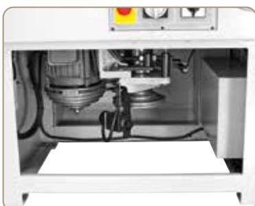
Egyszerű szíjcsere a sebesség kiválasztásához, a nagyméretű nyíláson keresztül a gép elülső oldalán
