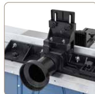
Szériászerűen elszívócsonkokkal, 100 mm átmérő.
