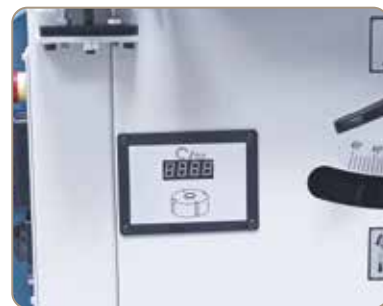
A beállított orsó-fordulatszám elektronikus kijelzése
