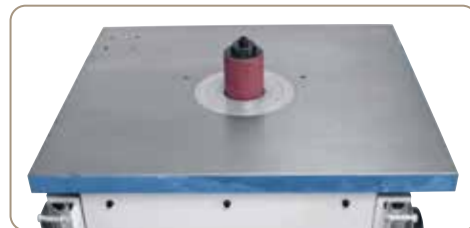
Köszörű henger diam. 75 mm a szállítási terjedelemben
