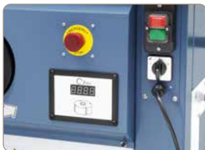
A beállított orsó-fordulatszám elektronikus kijelzése.
