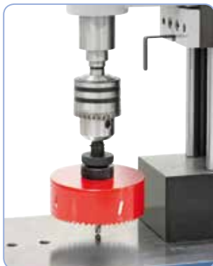
Alapkitételben MK3-as kúppal van ellátva a legkülönbözőbb szerszámok befogatásához
