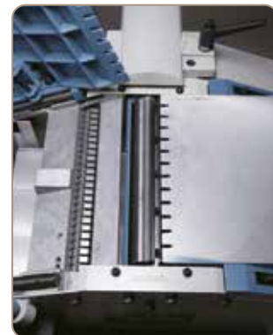
A precíziósan csapágyazott képes henger és a bordás behúzóhenger által a legjobb gyalulási eredmények célozhatók meg
