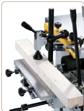
Az opciós hosszlyukfúró-berendezés ideális hosszlyukakhoz, csap- és ferde lyukfuratokhoz, ...
