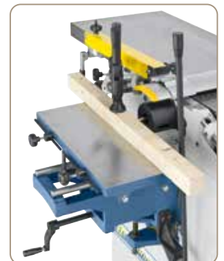
A hosszlyukfúró-berendezés ideális hosszlyukakhoz, csap és ferde lyukfuratokhoz, ...
