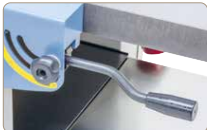
A forgácslevétel gyors és egyszerű beállítása max. 3,5 mm-ig
