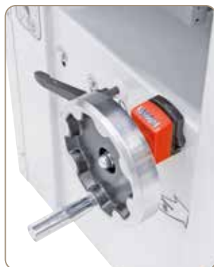
A vastagsági asztal magasságának beállítása digitális mutató segítségével történik 1/10 mm pontosan
