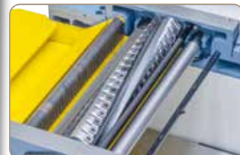
A precíziósan csapágyazott spirálkéses gyalutengellyel ellátott stabil gyaluegység a legjobb gyalulási eredményről gondoskodik.
