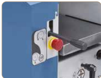
Előretolás egyengető gyaluláshoz kikapcsolható
