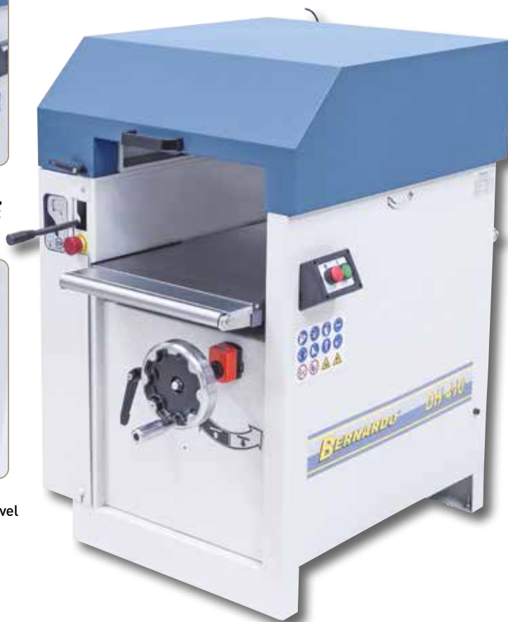
Stabil vastagsági asztal szegnyereg-vezetéssel és támasztással deszkák, lécek, pallók, ... egzakt gyalulásához
