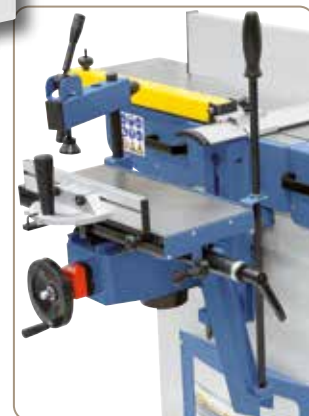
Az opciósan kapható hosszlyukfúró-berendezés ideális hosszlyukakhoz, csap és ferde lyukfuratokhoz
