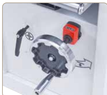
A vastagsági asztal magasságának beállítása digitális mutató segítségével történik 1/10 mm pontosan
