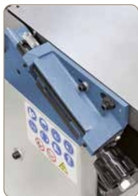
A kívánt forgácslevétel gyors és egyszerű beállítása.
