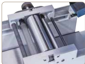
A precíziósan csapágyazott 4-kései henger és az egyenes fogazatú behúzóhenger által a legjobb gyalulási eredmények célzó-hatók meg.
