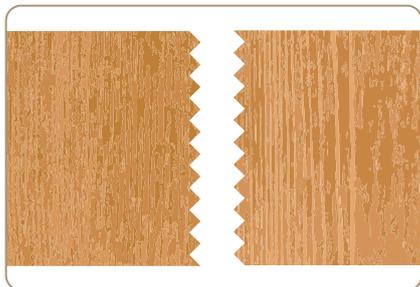
Assemblage lamellé-collé, très résistant et indéformable
