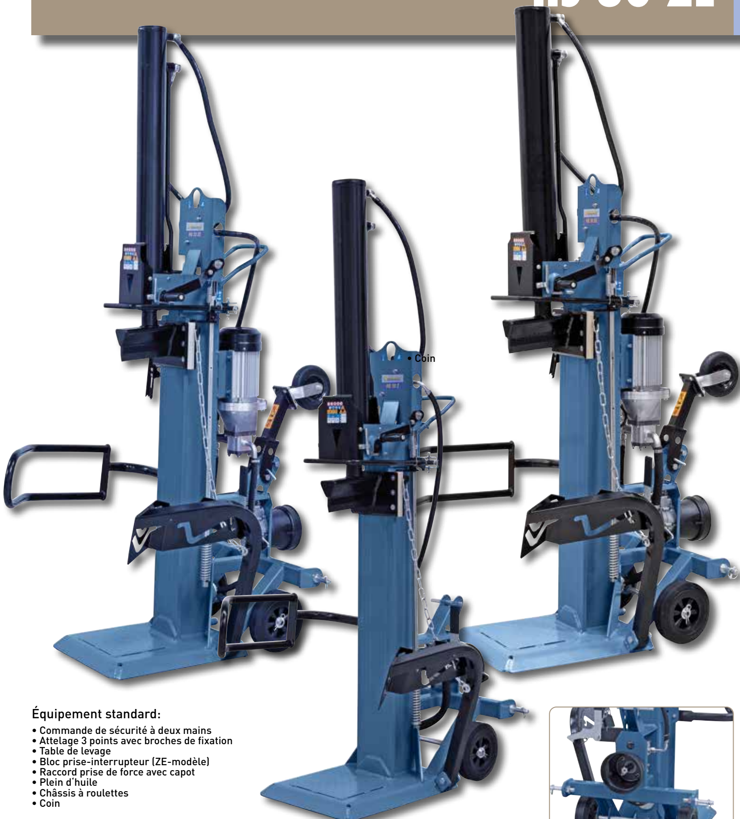
De série avec attelage 3 points cat. I/II et broches de fixation.
