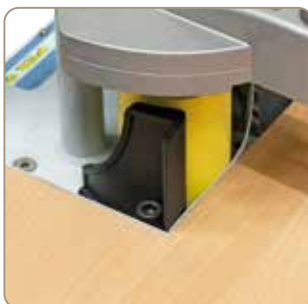
De série avec plaque de guidage pour l'amenée des chants dans les angles.
