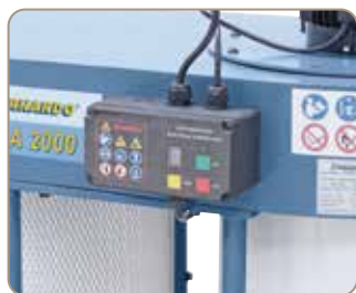
La mise en route et l'arrêt du système d'aspiration peuvent être réglés grâce à une minuterie.
