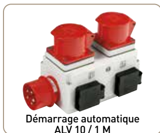
Au démarrage ou à l'arrêt de la machine à bois, l'aspirateur démarre ou s'arrête avec une temporisation
