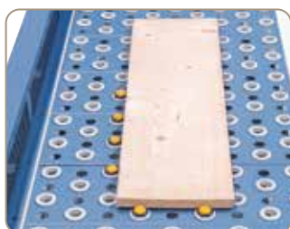
De série avec butées pour le positionnement de la pièce à usiner.
