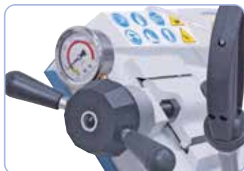
Réglage optimal de la tension de lame par manomètre
