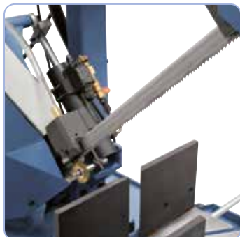
Guide-lame à roulements et brosse à copeaux pour une découpe optimale
