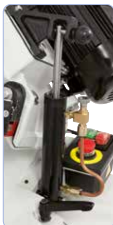
De série avec vérin hydraulique pour une descente souple de l'archet
