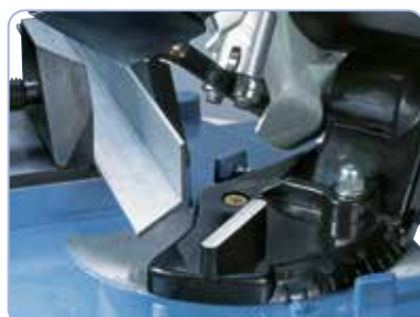
Archet réglable pour les coupes en onglet.
