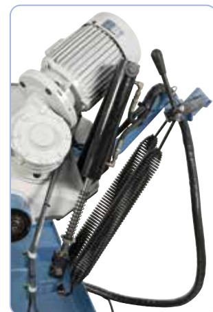
Ressort à levier de réglage pour le passage en mode manuel.
