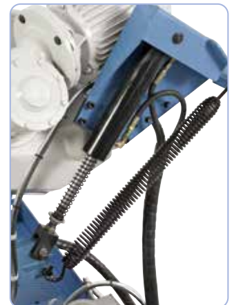
De série avec vérin hydraulique pour une descente souple de l'archet
