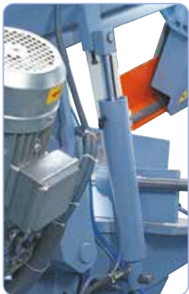
Vérin hydraulique stable pour une descente souple de l'archet.
