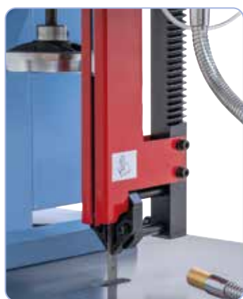
Guide lame en V trempé et rectifié
