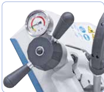
Réglage optimal de la tension de lame par manomètre
