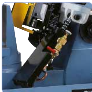
De série avec vérin hydraulique pour une descente souple de l'archet.
