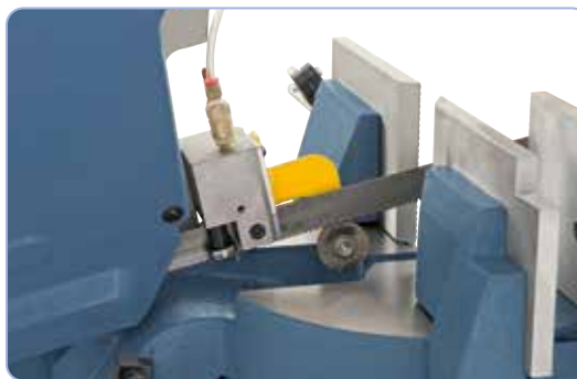
Un guidage métal dur - rouleau combiné empêche une usure rapide du ruban de scie.
