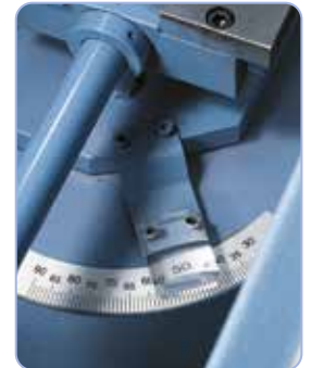
Réglage simple et rapide de l'angle de coupe sur la graduation
