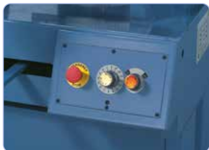
Réglage confortable de la pression de coupe par valve de réglage
