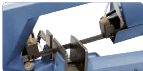
Guide-lame à roulements à billes pour un résultat précis
