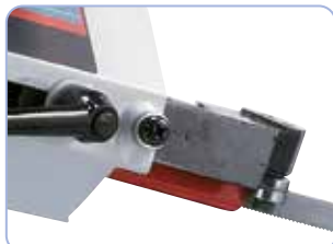
Guide-lame à roulements à billes pour une découpe optimale
