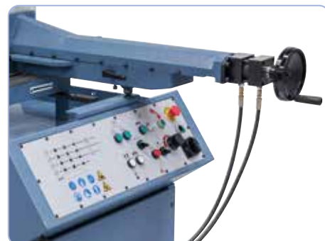
Étau réglable à serrage manuel ou hydraulique
