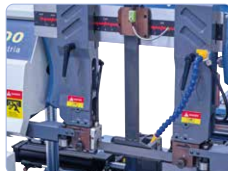
Le guidage du ruban de scie réglable empêche un déport latéral ou un blocage du ruban de scie.
