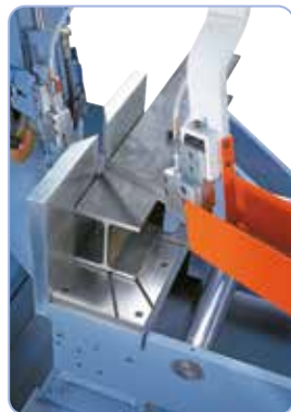
Guide-lame avec réglage rapide selon la largeur des pièces, garantit un résultat optimal
