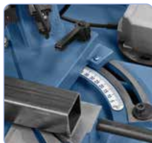
Archet inclinable pour les coupes en onglet jusqu'à 60°
