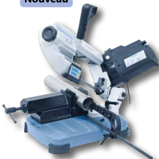
Archet réglable pour les coupes en onglet jusqu'à 60°
