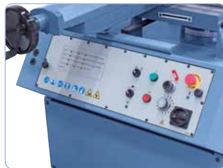
Armoire électrique clairement organisée à l'avant de la machine pour un travail confortable
