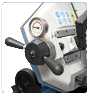
Manomètre de série pour un réglage optimal de tension du ruban.
