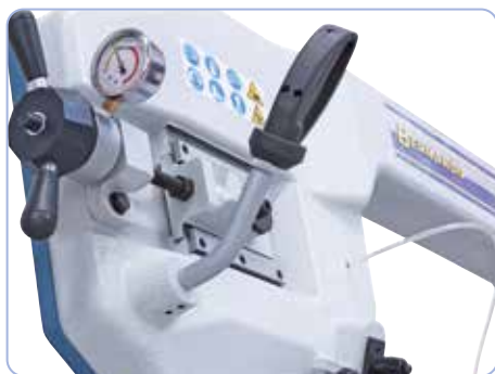
Manomètre de série pour un réglage optimal de tension du ruban.
