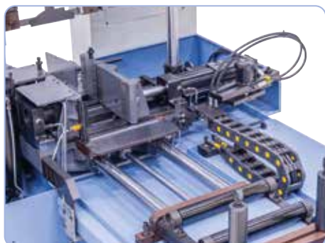
Avance du matériau par un dispositif de serrage hydraulique et un guidage rond précis
