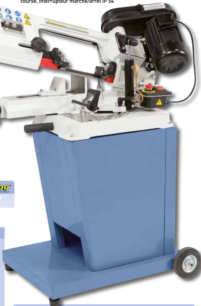
De série avec coupure automatique en fin de course, interrupteur marche/arrêt IP 54
