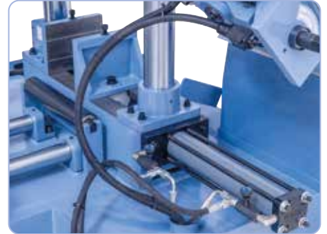
Robuste étau en fonte grise à serrage hydraulique
