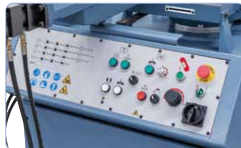
Commandes de variateur de vitesse et de valve de réglage de la pression de coupe sur pupitre ergonomique
