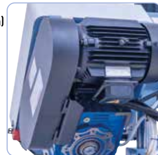
Entraînement à courroie avec 3 vitesses de coupe réglables.
