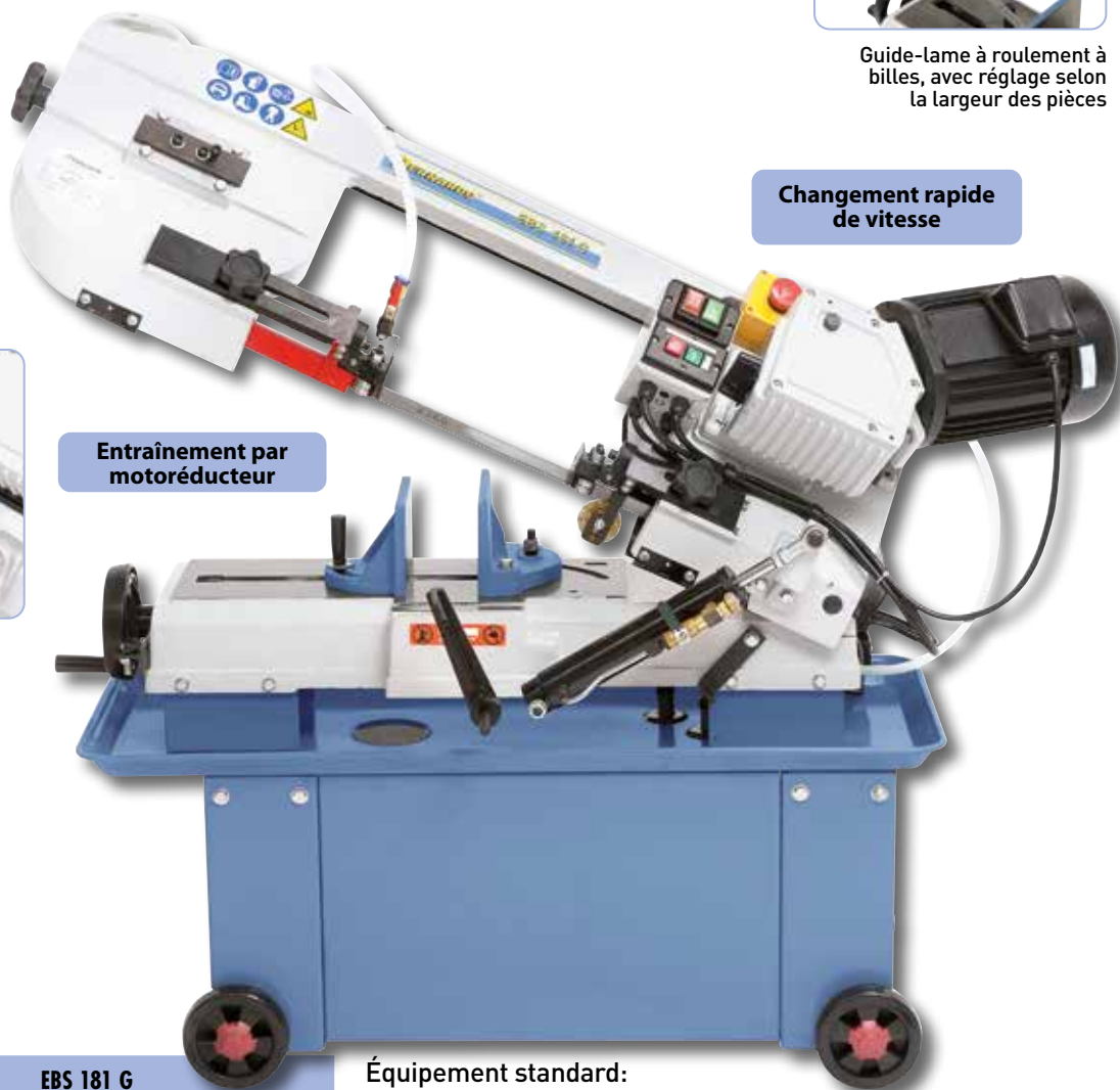
De série avec vérin hydraulique pour une descente souple de l'archet
