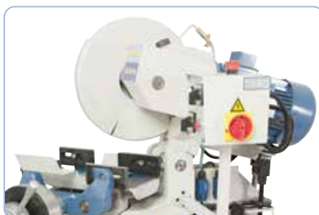
Tête orientable à droite et à gauche de 90°
