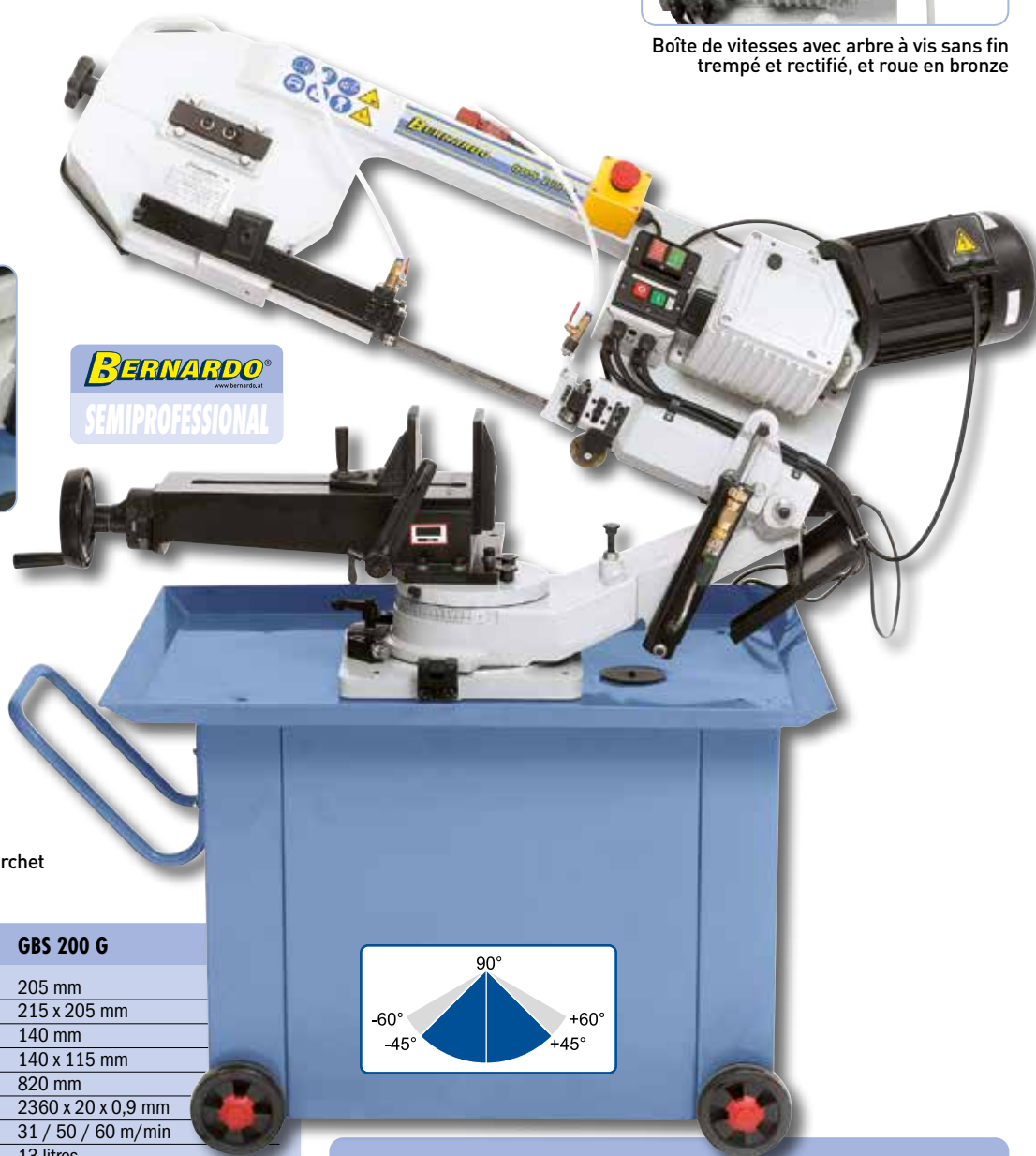
Archet inclinable pour les coupes en onglet de -45^\circ à 45^\circ
