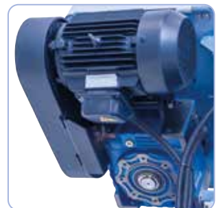
Entraînement à courroie avec 3 vitesses de coupe réglables.
