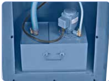
Dispositif d'arrosage puissant intégré dans le socle
