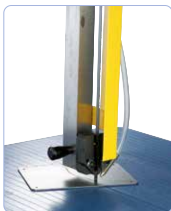
Guide-lame à roulement à billes, avec réglage selon la hauteur des pièces
