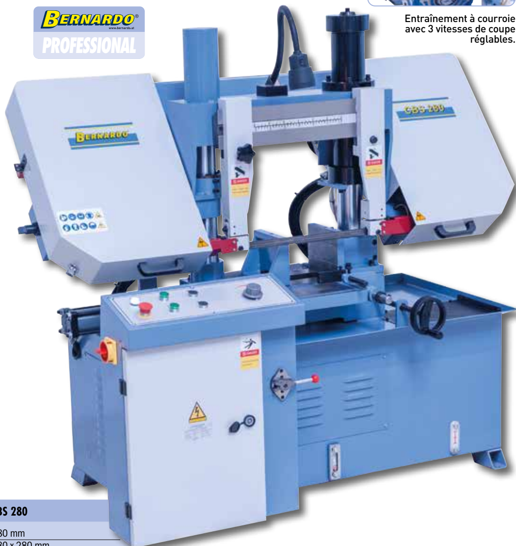
Le guidage du ruban de scie réglable empêche un déport latéral ou un blocage du ruban de scie.
