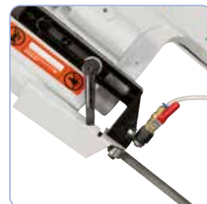
Guide-lame à roulement à billes, avec réglage selon la largeur des pièces
