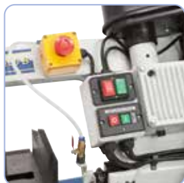
Commandes centralisées sur l'archet
