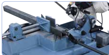
Réglage simple de l'étau par levier de serrage rapide
