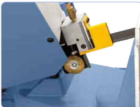
Guide-lame combiné à roulements et mors avec inserts carbure
