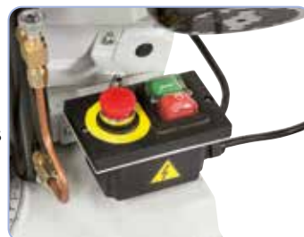
De série avec coupure automatique en fin de course, interrupteur marche/arrêt IP 54
