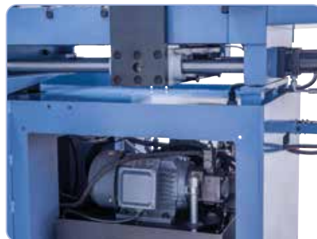
Groupe hydraulique logé de manière peu encombrante dans le bâti machine.
