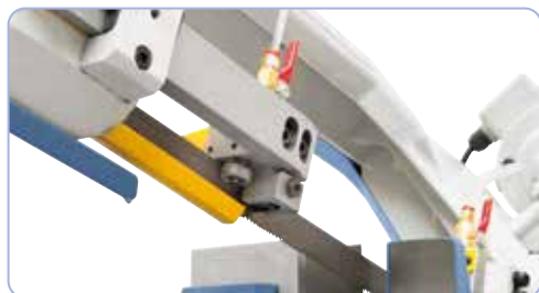
Guide-lame combiné à roulements et mors avec inserts carbure pour éviter une usure rapide du ruban
