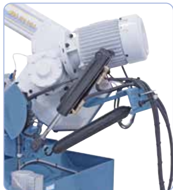
De série avec vérin hydraulique pour descente progressive de l'archet et coupure automatique en fin de course
