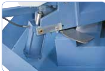
Blocage de l'archet à l'angle de coupe réglé par vérin hydraulique
