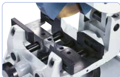
Étai massif auto-centrant avec réglage longitudinal des mors
