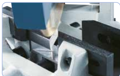
Tête orientable (45° gauche/droite), idéale pour les coupes en onglet
