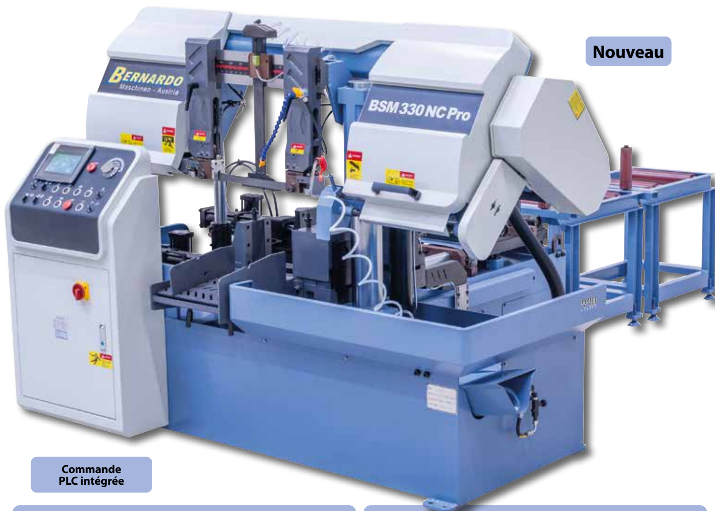
Vérin hydraulique stable pour une descente souple de l'archet.
