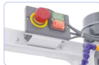
Interrupteur de sécurité avec bobine à manque de tension et bouton d'arrêt d'urgence séparé
