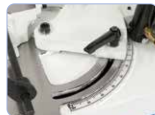
Archet inclinable pour les coupes en double onglet de -45° à +60°
