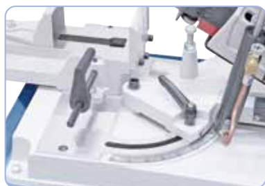
Archet inclinable pour les coupes en onglet de +45° à -60°
