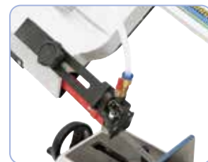
Guide-lame à roulement à billes, avec réglage selon la largeur des pièces
