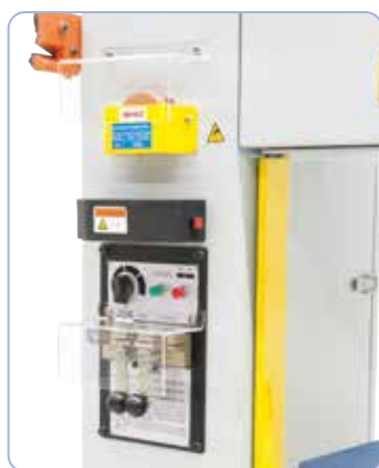
Y compris dispositif de soudage de ruban, cisaille et pierre à aiguiser
