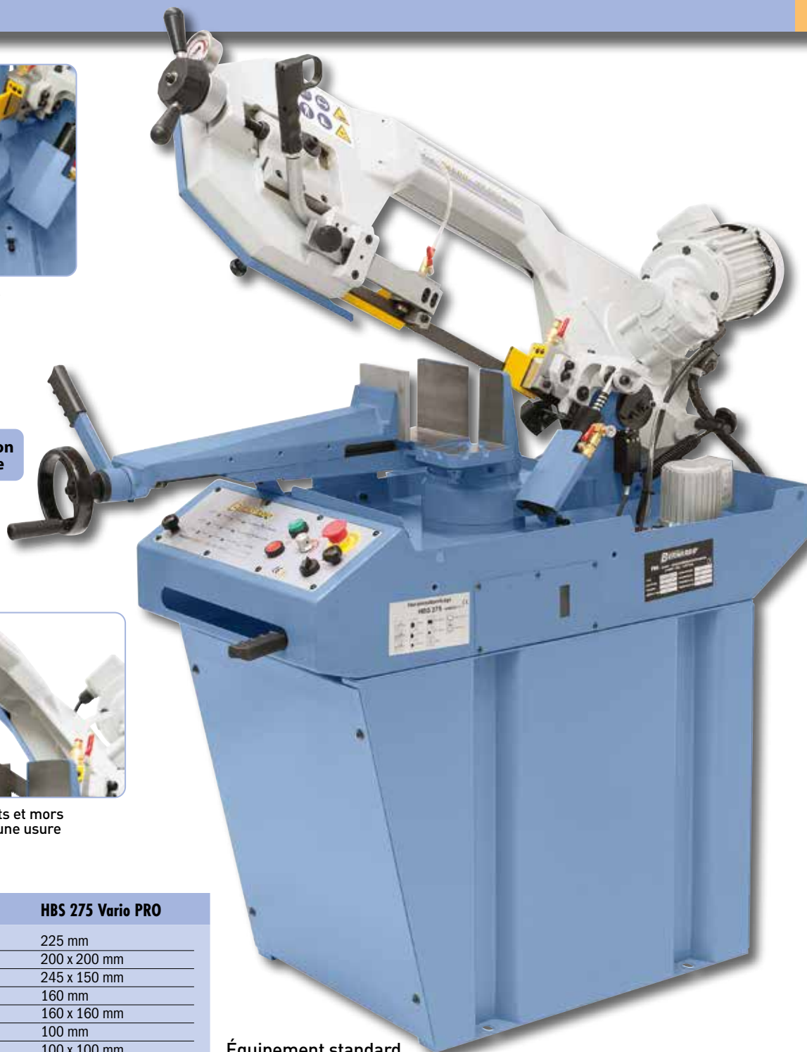
Archet inclinable pour les coupes en onglet de -90^\circ à +60^\circ
