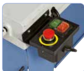
Interrupteur de sécurité avec bobine à manque de tension et bouton d'arrêt d'urgence séparé, arrêt automatique en fin de course
