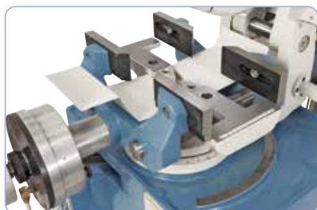
Étau pneumatique à serrage rapide pour réduire les temps morts
