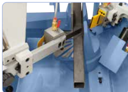
Archet inclinable pour les coupes en onglet de -90^\circ à +60^\circ
