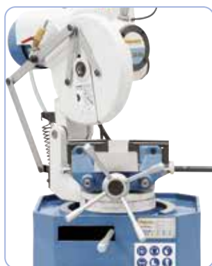
Tête orientable (45° gauche/droite), idéale pour les coupes en onglet
