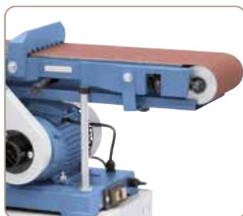
Grande surface de ponçage plane avec butée
