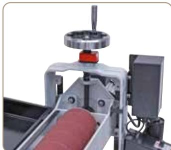
Système de guidage stable, réglage de hauteur par manivelle
