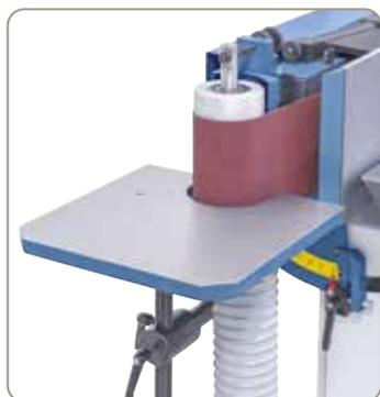
La table complémentaire réglable en hauteur avec aspiration permet le ponçage de contours au niveau du rouleau
