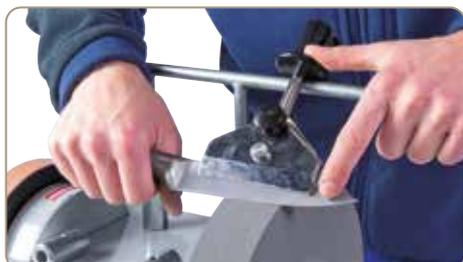
05-2057 Dispositif pour couteaux longs: pour couteaux avec une longueur de lame à partir de 100 mm
