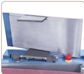
Guide de ponçage avec réglage fin et blocage automatique
