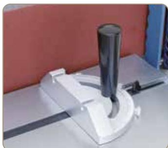
De série avec guide d'onglet gradué pour un ponçage précis
