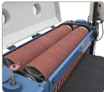
Deux cylindres à bande pour la rectification grossière et de finition en une seule passe.
