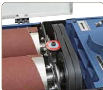
Réglage fin du cylindre de rectification arrière.
