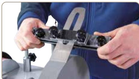
05-2054 Dispositif pour meulage rectiligne: pour les fers de rabot, avec une largeur maxi de 70 mm, épaisseur maxi 6.5 mm.
