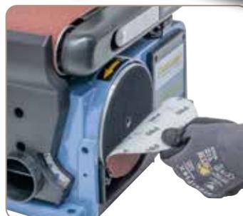
Avec plateau Velcro pour la fixation des disques
