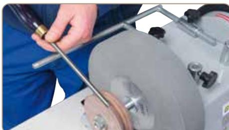
05-1809A Meule de morfilage profilée en cuir: pour la finition et le polissage de gouges
