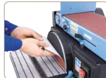
Remplacement facile et rapide de la meule grâce à une bande velcro
