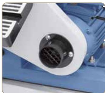
2 tubulures d'aspiration de série diam. 50 mm.
