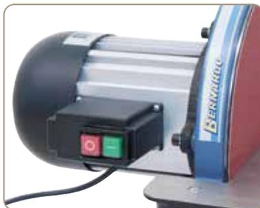
Interrupteur marche/arrêt IP54 avec bobine à manque de tension
