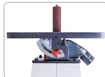
De série avec buse d'aspiration pour le raccordement d'un aspirateur
