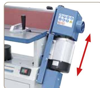
Guidage linéaire du bloc de ponçage en position verticale (au lieu d'un mouvement d'inclinaison) pour un résultat parfait
