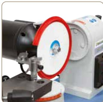
Meule corindon pour les lames de scie au carbure.
