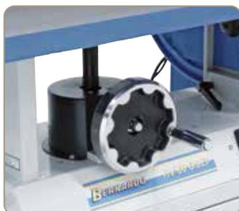
Réglage de la table en hauteur par une manivelle ergonomique à l'avant de la machine
