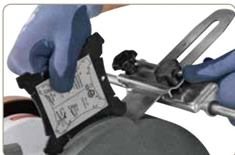
Réglage aisé de l'angle optimal grâce à la jauge d'angle WL-60 (standard)
