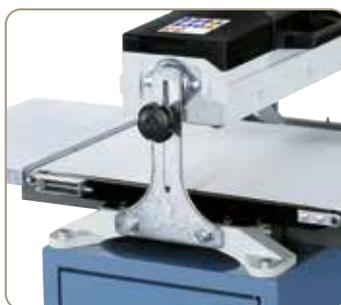
Système de blocage pour maintenir l'unité de ponçage en place
