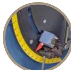
Inclinaison variable du bloc de ponçage pour le ponçage horizontal ou vertical
