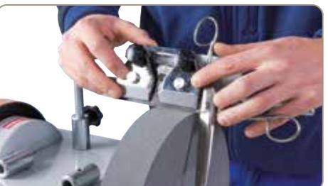
05-2055 Dispositif d'affûtage pour ciseaux: optimal pour ciseaux droit et secateurs
