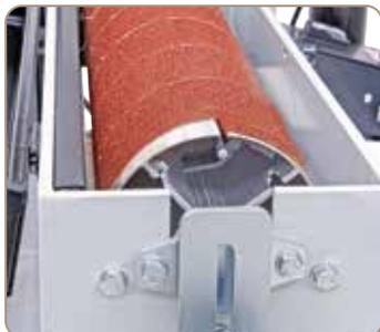
Système de fixation rapide de la bande abrasive
