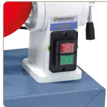
Interrupteur marche/arrêt IP54 avec bobine à manque de tension.
