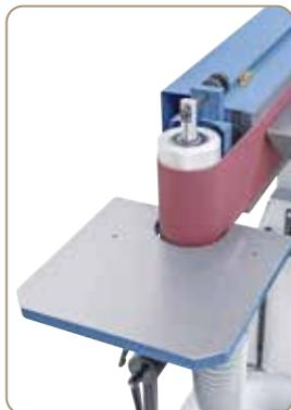
Table ronde avec buse d'aspiration, idéale pour le ponçage des arcs de cercle et des contours
