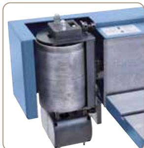
Bloc de ponçage oscillant avec course de 10 mm
