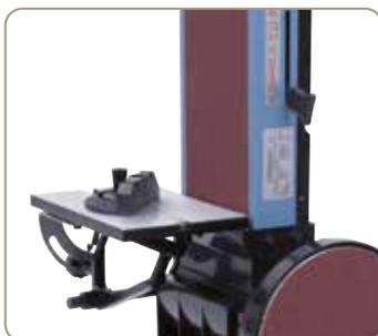
La table de ponçage peut s'utiliser avec le disque et la bande.
