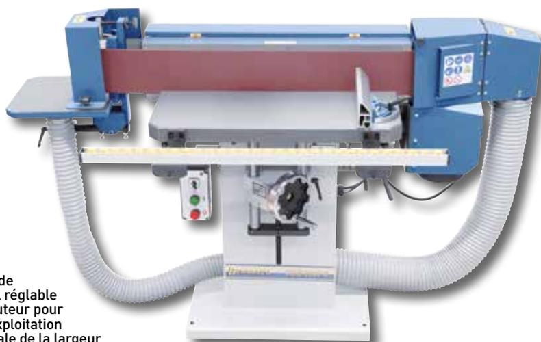
Table de travail réglable en hauteur pour une exploitation optimale de la largeur de la bande abrasive. Illustration avec élargissement de table extensible (option)
