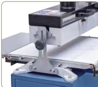
Système de blocage pour maintenir l'unité de ponçage en place
