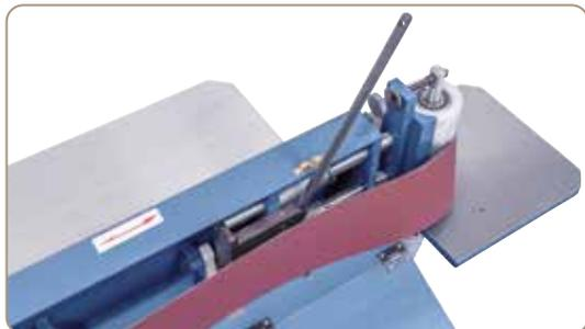
Remplacement aisé de la bande abrasive grâce à un dispositif de serrage rapide.
