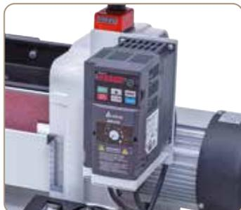
Le convertisseur de fréquences de qualité supérieure permet un réglage en continu de la vitesse de rotation de la broche.
