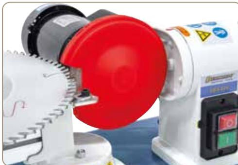
Capot de protection fermé conforme CE pour une sécurité optimale.
