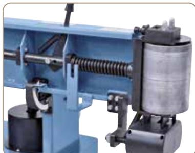
Serrage de la bande par ressort, compensation automatique des différences de longueur de bande
