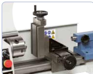
Disponible en option : support de fraisage vertical avec surface de bridage de 64 x 130 mm
