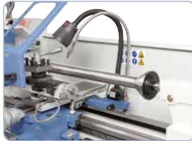
Cône de centrage diam. 100 mm, idéal pour le bridage des tubes et corps creux (en option)
