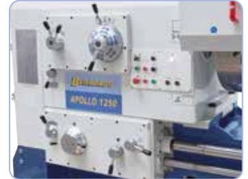
Disposition ergonomique des éléments de commande sur la tête, pignons trempés et rectifiés pour un fonctionnement silencieux
