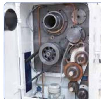
La broche principale trempée avec un alésage de 130 mm est supportée par des paliers à rouleaux coniques et un palier à galets radiaux.
