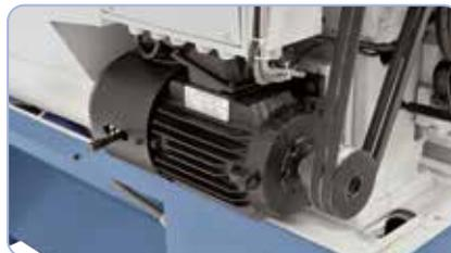
Puissant moteur à frein magnétique conforme CE
