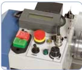
Pour régler la vitesse de rotation avec précision, la machine peut être équipée d'un affichage digital de vitesse
