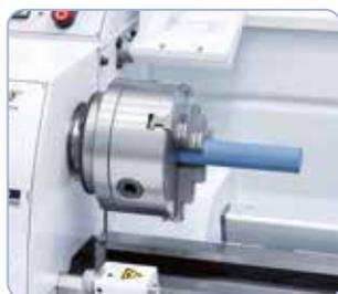
De série avec passage de broche 38 mm pour l'usinage des forts diamètres d'arbre (700 Top)
