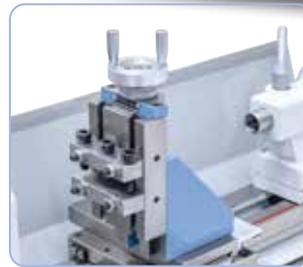
Possibilité d'ajouter un support de fraisage vertical pour plus de solutions d'usinage.
