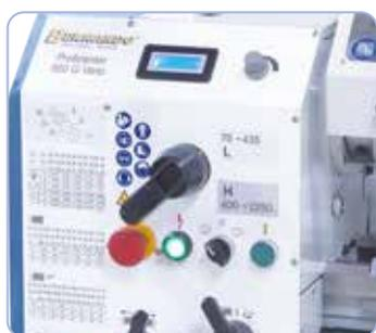
Présélection de l'étage de vitesse par transmission intermédiaire, réglage de la vitesse de rotation par potentiomètre
