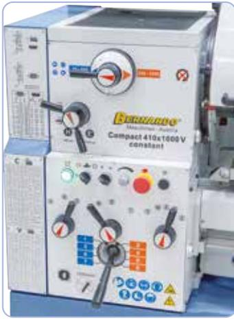
Utilisation simple, disposition ergonomique des éléments de commande sur la tête. Vitesse d'avance facile à changer, pignons dans bain d'huile
