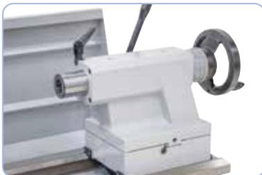
Robuste poupée mobile avec fourreau de contre-pointe à cône CM 4, réglable pour le tournage de pièces coniques
