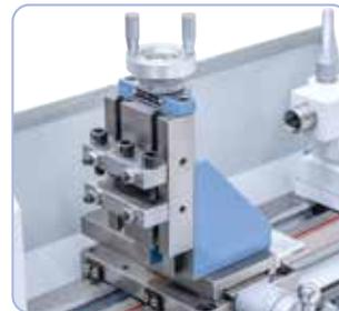
Possibilité d'ajouter un support de fraisage vertical pour plus de solutions d'usinage.
