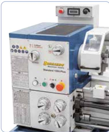
Utilisation simple, disposition ergonomique des éléments de commande sur la tête. Vitesse d'avance facile à changer, pignons dans bain d'huile
