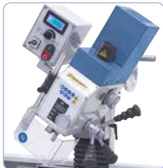
De série, tête de fraiseage avec affichage de profondeur et de vitesse de rotation. Perçage et fraiseage sous tous les angles.
