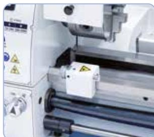
De série avec limiteur de couple et guide longitudinal micro-métrique (700 Top)
