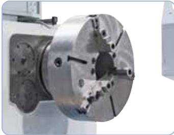
En option : mandrin à 3 mâchoires Ø 630 mm avec disque de serrage.
