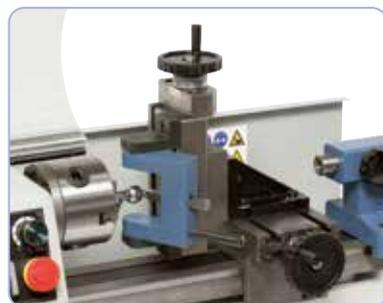
Support de fraisage vertical avec dispositif de tournage conique monté (en option)
