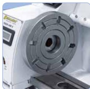
Pour le bridage de pièces aux formes spécifiques, la machine peut être équipée d'un flange de montage de 170 mm
