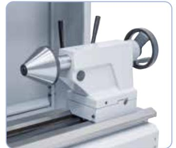
En option : cône de centrage diam. 130 mm pour le bridage de tubes
