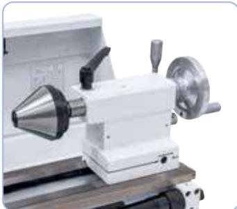
La poupée mobile à levier de serrage peut être réglée pour l'usinage de pièces coniques, sur demande disponible avec cône de centrage
