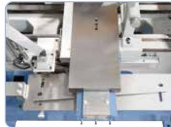
Dispositif pour tournage conique en option, longueur de tournage 455 mm, angle réglable  $\pm 8^\circ$
