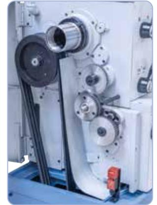
Excellente concentricité assurée par une robuste broche trempée à roulements coniques de précision, transmission optimale du couple par courroie trapézoïdale dentée Optibelt
