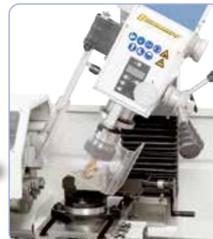
La tête de fraiseuse inclinable offre une grande variété possibilités d'usinage.
