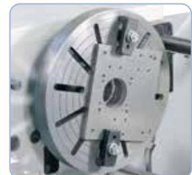
Flasque de montage diam. 320 mm de série pour le bridage de pièces aux formes diverses
