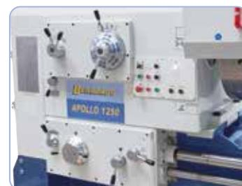
Disposition ergonomique des éléments de commande sur la tête, pignons trempés et rectifiés pour un fonctionnement silencieux
