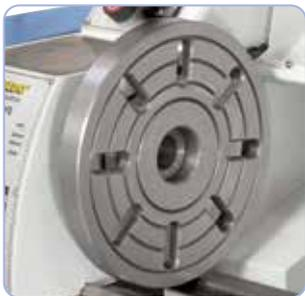
Pour le bridage de pièces aux formes spécifiques, la machine peut être équipée d'un flasque de montage de 240 mm
