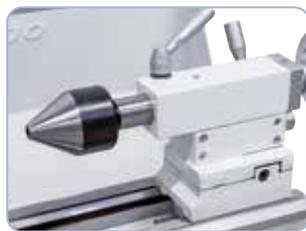
Cône de centrage diam. 60 mm, idéal pour le bridage des tubes et corps creux (en option)
