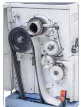
Excellente concentricité assurée par une robuste broche trempée à roulements coniques de précision, transmission optimale du couple par courroie trapézoïdale dentée Optibelt
