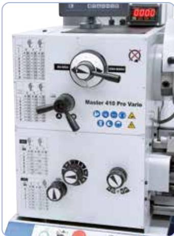
Commandes d'avance et de vitesse accessibles sur la tête, fonctionnement silencieux grâce aux pignons trempés et rectifiés, dans bain d'huile. Variateur électronique de vitesse avec affichage digital très lisible.
