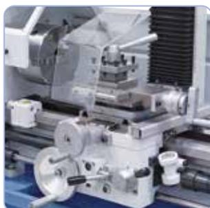
Chariot à manivelle avec graduation fine. Ce modèle est également équipé d'une avance transversale économique.
