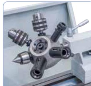
La machine peut être équipée d'une tête revolver pour un travail économique
