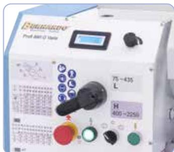
Présélection de l'étage de vitesse par transmission intermédiaire, réglage de la vitesse de rotation par potentiomètre
