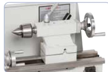
La poupée mobile à levier de serrage peut être réglée pour l'usinage de pièces coniques, sur demande disponible avec cône de centrage
