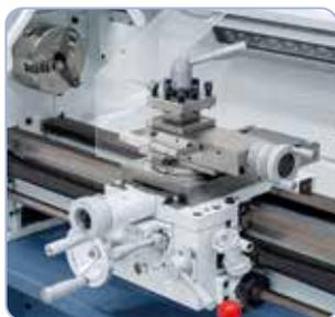
Chariot avec porte-outils et tourelle 4 positions, précis et facile à manœuvrer; manivelles à graduation métrique fine réglable
