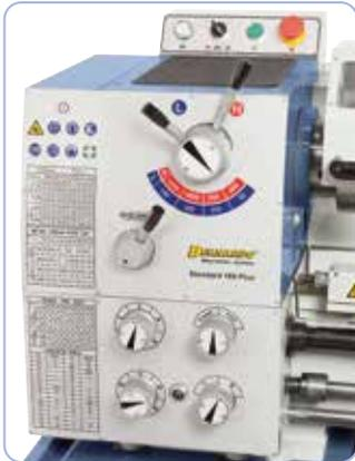
Commandes d'avance et de vitesse accessibles sur la tête, fonctionnement silencieux grâce aux pignons trempés et rectifiés, dans bain d'huile
