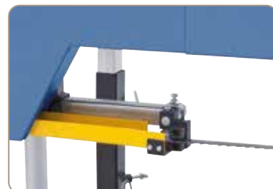
Guidage précis du ruban et alimentation ciblée en fluide de coupe pour des résultats optimaux
