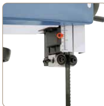
Guidage à roulement à billes de haute précision au-dessus et en dessous du plateau de scie pour une commande parfaite de la scie à bande (HBS 400 N / HBS 460 N)
