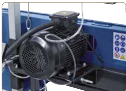
Deux variantes d'entraînement : moteur électrique de 10 ch ou moteur à essence de 14 ch avec démarreur à câble
