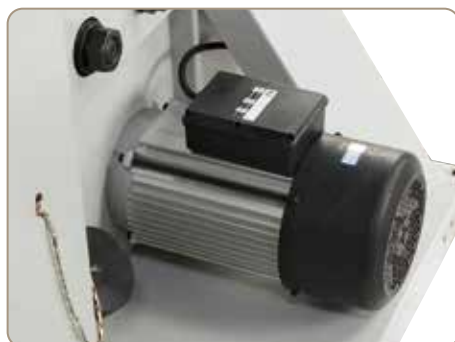
Moteur d'entraînement puissant avec fonction de freinage, évacuation optimale des copeaux via les manchons d'aspiration diam. 100 mm.
