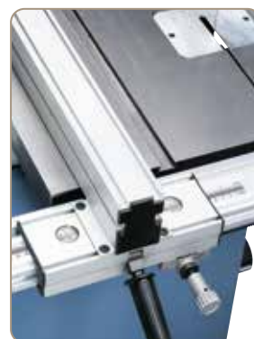
Guide longitudinal avec loupe intégrée pour une lecture précise de la largeur de coupe
