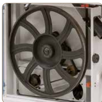
La roue d'entraînement avec bandage spécial en caoutchouc assure un fonctionnement silencieux et augmente la durée de vie de la scie à bande.
