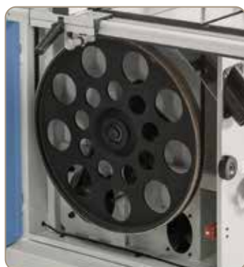
La roue d'entraînement avec bandage spécial en caoutchouc assure un fonctionnement silencieux et augmente la durée de vie de la scie à bande.
