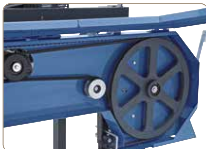
La roue d'entraînement avec bandage spécial en caoutchouc assure un fonctionnement silencieux et augmente la durée de vie de la scie à bande.
