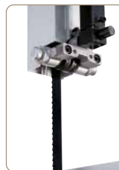
Le guide-lame de précision au-dessus et en dessous de la table assure un défilement parfait du ruban et garantit une découpe de qualité (HBS 500 N).
