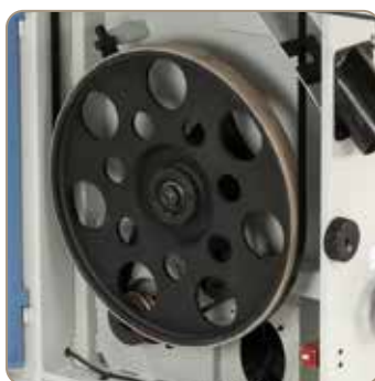
Volant d'entraînement à bandage en caoutchouc spécial pour un fonctionnement silencieux, augmente la durée de vie du ruban
