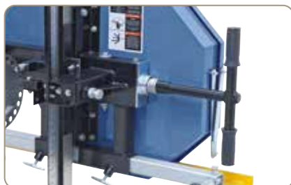
Réglage de tension du ruban pratique et facile d'accès
