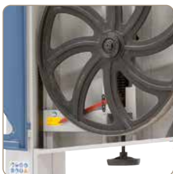
Le réglage de tension du ruban s'effectue par manivelle avec affichage sur un diagramme au niveau du volant supérieur
