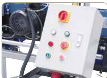
Illustration avec tableau électrique et barre d'avance manuelle (réglable en hauteur)
