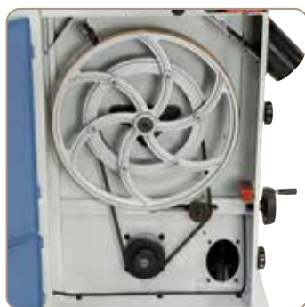
La vitesse de coupe désirée est réglée par l'intermédiaire d'une courroie trapézoïdale sur la roue inférieure (HBS 400 N/HBS 460 N).
