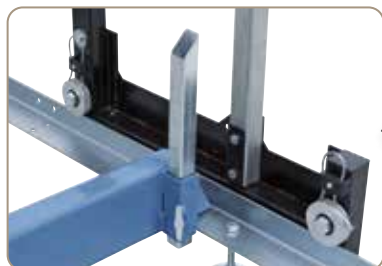
Quatre roues à roulements à bille assurent un déplacement aisé du bloc de sciage
