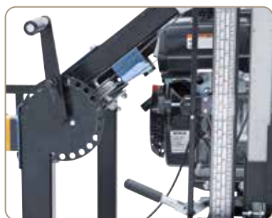
Réglage de hauteur du bloc de sciage par manivelle avec lecture sur graduation
