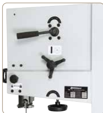
Changement aisé du ruban par levier de blocage rapide, sans modifier le réglage de l'entraînement
