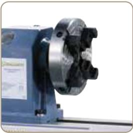
Pour le bridage des pièces asymétriques, la machine peut être équipée d'un mandrin de dressage 4 mors
