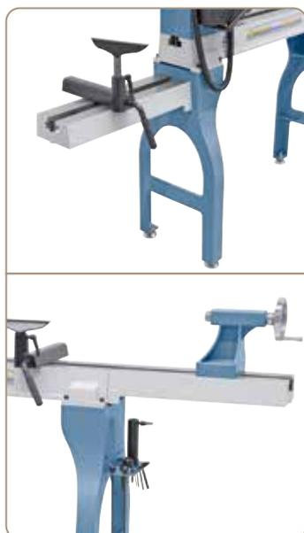
Le dispositif rotatif externe (Ø 690 mm) disponible en option peut aussi être utilisé comme extension (1180 mm).
