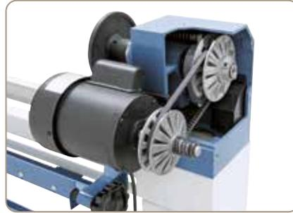
L'entraînement massif à variateur assure une transmission optimale de la force.
