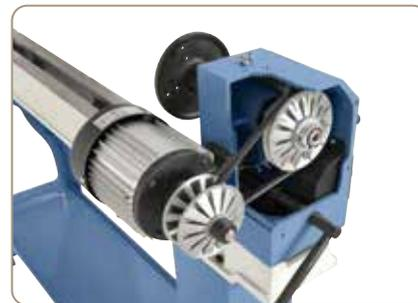
La transmission du moteur au fourreau de broche s'effectue par un robuste variateur
