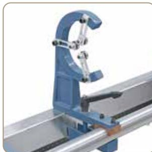
Lunette fixe incluse pour diamètre d'arbre jusqu'à 90 mm
