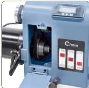
La transmission du couple au fourreau de broche s'effectue par un robuste entraînement à courroie
