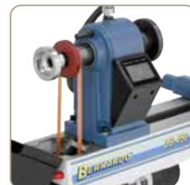
La transmission du couple au fourreau de broche s'effectue par un robuste entraînement à courroie
