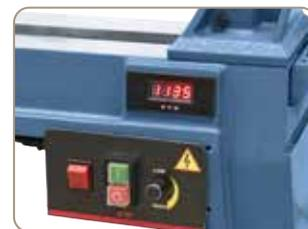
Pour un réglage optimal de la vitesse de rotation, la machine est équipée d'un affichage digital de vitesse
