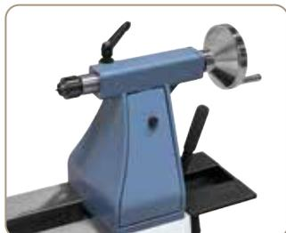
Contrepoupée mobile robuste avec embout CM 2 et alésage traversant pour l'usinage de pièces longues.
