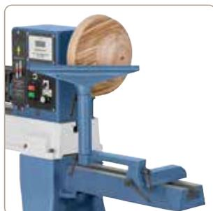
Le dispositif rotatif extérieur permet d'usiner sans problème les grands diamètres de pièces (Ø 810 mm).
