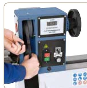
Changement d'étage de vitesse simple par déplacement de la courroie trapézoïdale
