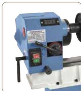
Pour un réglage optimal de la vitesse de rotation, la machine est équipée d'un affichage digital de vitesse
