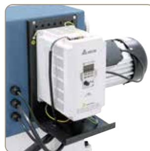
Le convertisseur de fréquences de qualité supérieure permet un réglage en continu de la vitesse de rotation de la broche.
