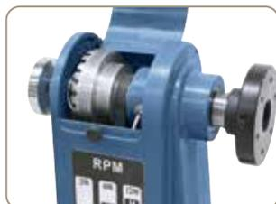
Changement d'étage de vitesse simple par déplacement de la courroie trapézoïdale
