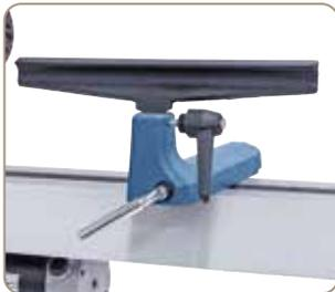
De série avec appui-main 150 mm et 300 mm.
