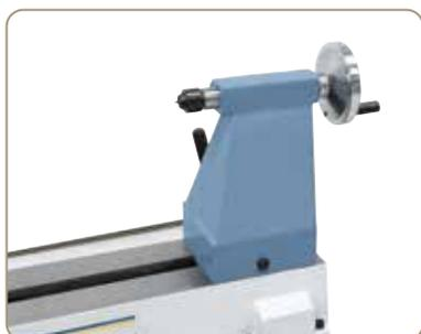
Contrepoupée mobile robuste avec embout CM 2 et alésage traversant pour l'usinage de pièces longues
