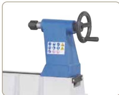
Fourreau de broche alésé, idéal par ex. pour la réalisation de passages de câbles dans des pieds de lampe
