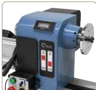
Pour un réglage optimal de la vitesse de rotation, la machine est équipée d'un affichage digital de vitesse.
