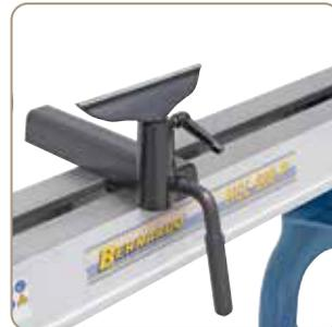
Fixation aisée du support par levier de serrage rapide
