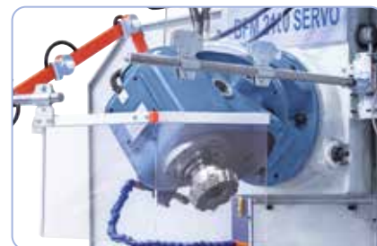
La tête universelle réglable sur les axes 90° et 45° peut réaliser tous les angles
