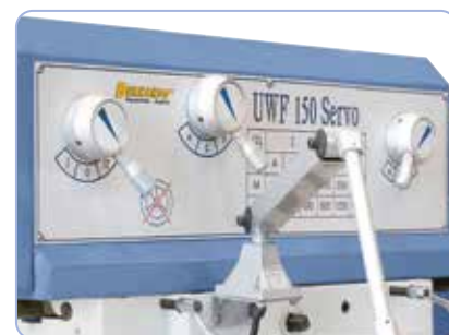
Positionnement judicieux des leviers de changement de vitesse
