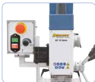
Disposition ergonomique des éléments de commande
