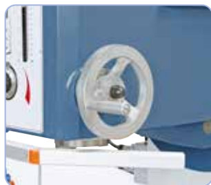
La descente de broche s'effectue à l'aide d'un volant sur une course de 100 mm
