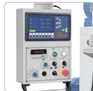
Variateur de vitesse à convertisseur de fréquence pour la broche vertical
