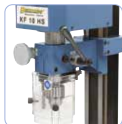
Descente de la broche par cabestan ou descente fine par volant d'avance
