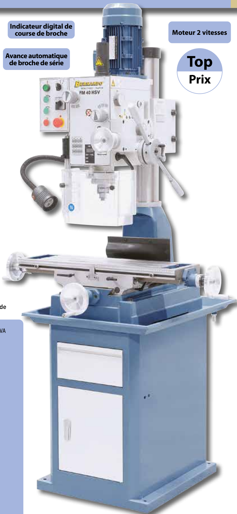
Descente de broche réglable au choix à 0,10 / 0,18 ou 0,26 mm/tr
