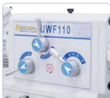
Positionnement judicieux des leviers de changement de vitesse
