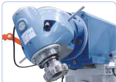
La tête universelle réglable sur les axes 90° et 45° peut réaliser tous les angles
