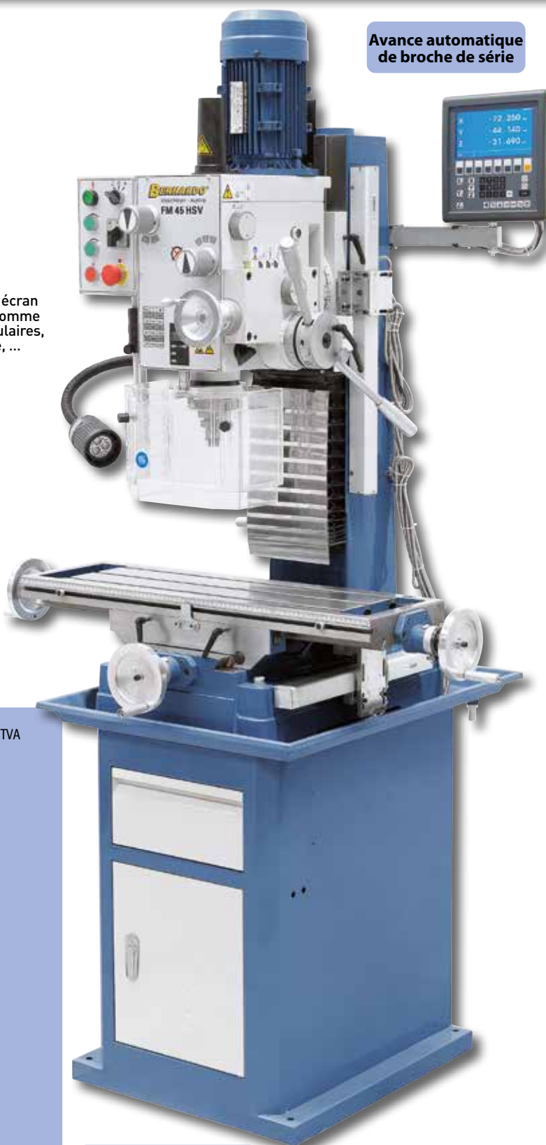
Afficheur digital de profondeur de perçage
