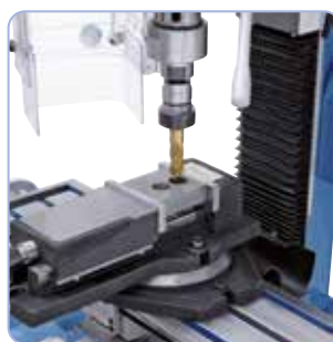
Fraisage avec étau large de la machine FJ 100
