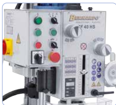
Disposition ergonomique des éléments de commande sur la tête
