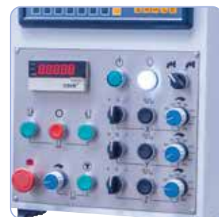
Réglage simple et rapide de la vitesse d'avance directement sur le pupitre de commande
