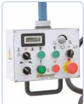
Présélection de l'étage de vitesse par sélecteur, réglage de la vitesse de rotation par potentiomètre
