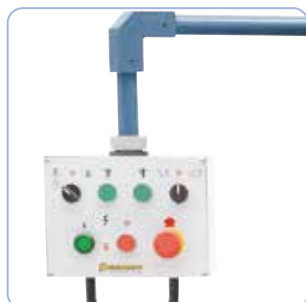
Pupitre de commande orientable et ergonomique
