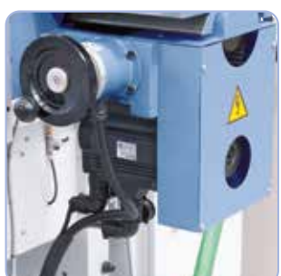
Équipé en standard de volants manuels électroniques pour le déplacement manuel et de 3 puissants servomoteurs sur les axes x, y et z.
