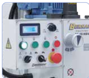
Présélection de l'étage de vitesse par sélecteur, réglage de la vitesse de rotation par potentiomètre
