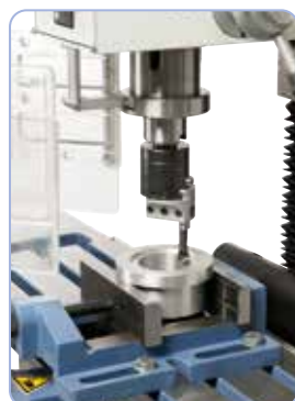
Sur demande, la machine peut être équipée d'une tête à aléser
