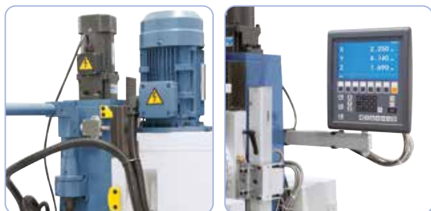
De série avec moteur de réglage de hauteur de la tête de fraisage Affichage digital de position sur les 3 axes permettant jusqu'à 50 % de gain de productivité
