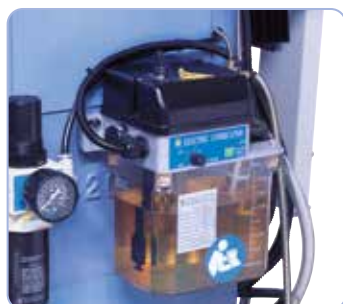
Lubrification centralisée électrique pour toutes les voies de guidage et les broches.
