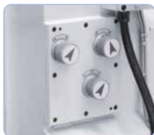
De série avec changement de vitesse pratique pour la broche horizontale
