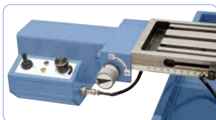
Pour un confort d'utilisation accru, en option avec avance de table variable FTV 8.
