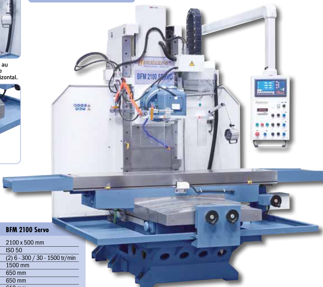
La tête universelle réglable sur les axes 90° et 45° peut réaliser tous les angles
