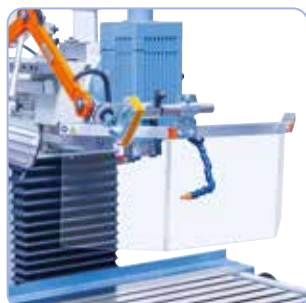
Protecteur orientable pour le fraisage verticale et horizontale
