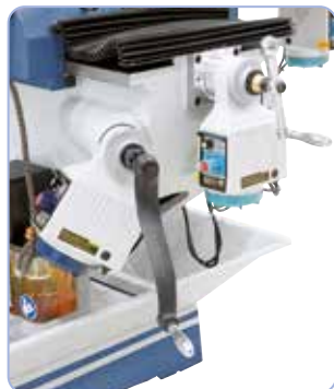
De série avec avance en continu sur l'axe x, y et z
