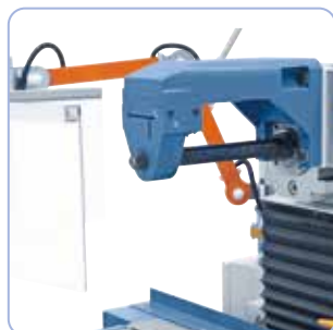
De série avec contre-broche et longue broche pour le fraisage horizontal
