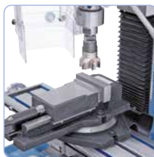
Fraisage avec fraiseuse d'angle et pour dresser (réf. 42-1058)
