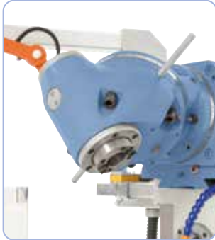
Tête de fraisage universelle à 2 axes de rotation, réglable sous tous les angles
