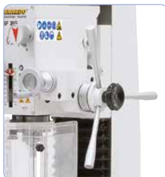
Positionnement aisé de la broche par manivelles ergonomiques pour le perçage, manivelle graduée pour un positionnement précis lors du fraisage
