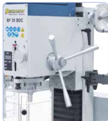
Grand levier pour un positionnement aisé de la broche lors du perçage, manivelle graduée pour un positionnement précis lors du fraisage
