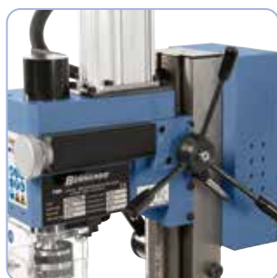
Grand levier pour un positionnement aisé de la broche lors du perçage, manivelle graduée pour un positionnement précis lors du fraisage
