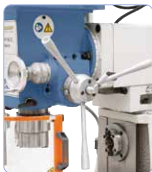
Descente et montée de broche par levier, ajustement de précision par manivelle
