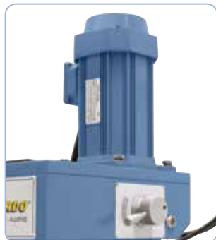
Présélection de l'étage de vitesse par transmission intermédiaire, réglage de la vitesse de rotation par potentiomètre
