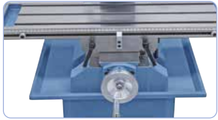
Guidage en queue d'aronde en x, y et z, ajustable par cale de réglage
