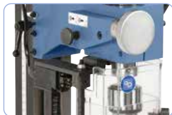
Réglage fin du fourreau de broche pour un travail de précision
