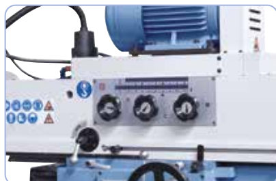
Vitesse de rotation de la broche réglable facilement sur le bras supérieur.
