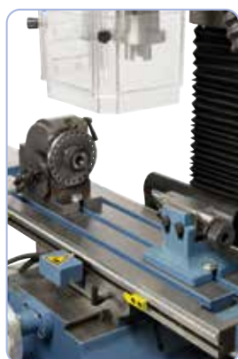
Diviseur semi-universel BS-0 : optimal pour l'usinage des arbres
