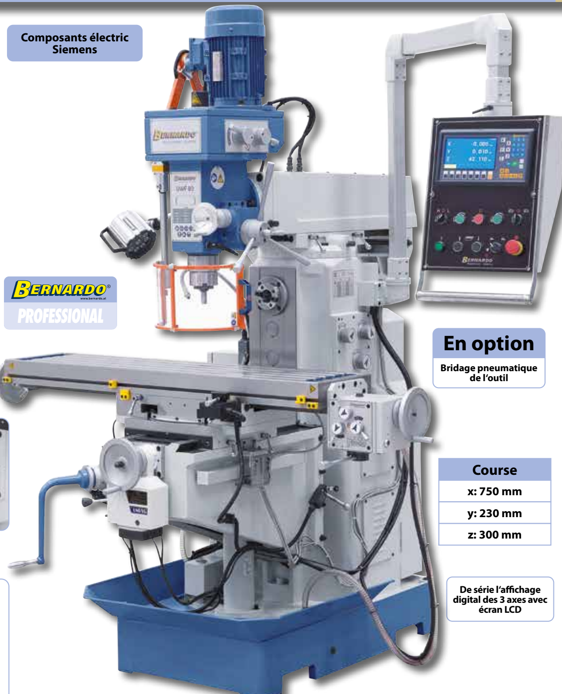
Avec avance progressive de l'axe y
