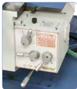
L'avance de table de série avec fonction d'avance rapide sur les 3 axes réduit nettement les temps morts
