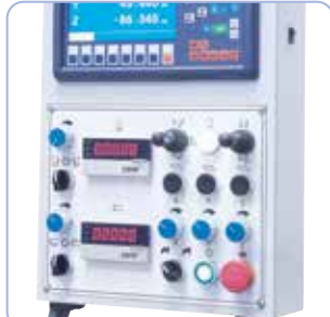
Réglage simple et rapide de la vitesse d'avance directement sur le pupitre de commande
