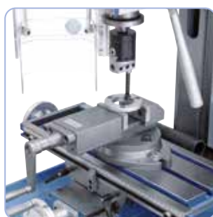
Sur demande, la machine peut être équipée d'une tête à aléser
