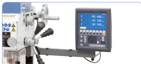
Affichage digital de position Bernardo ES-12 V sur les axes x, y et z inclus (Réf. 02-1033B)
