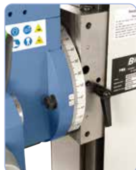
Guidage en queue d'aronde à cales réglables, sans maintenance
