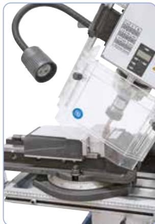
L'inclinaison de la tête permet des opérations de fraisage et de perçage horizontales, verticales ou en biais
