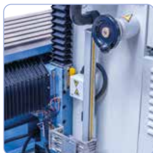
De série avec des manivelles électroniques pour le déplacement manuel dans les axes x, y et z.
