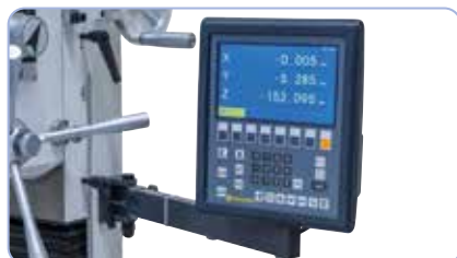
BF 30 N Super avec avance de table automatique et visu 3 axes ES-12 V avec écran LCD (Réf. 02-10440)
