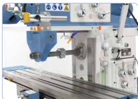
Broche horizontale pour une grande polyvalence, réglage de vitesse par embrayage
