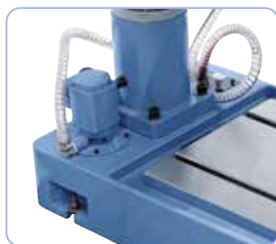
De série pompe de lubrification
