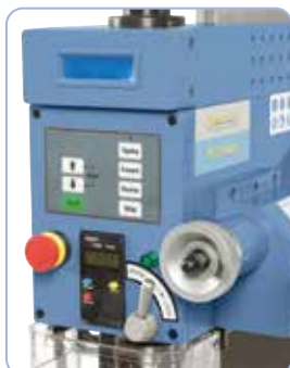
Affichages digitaux clairs, pilotage ergonomique par clavier à membrane
