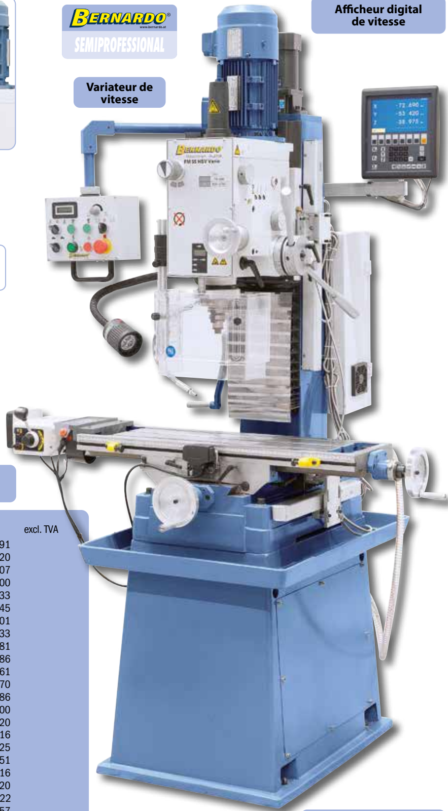
Réglage de hauteur de la tête de fraisage aisé par moteur de série
