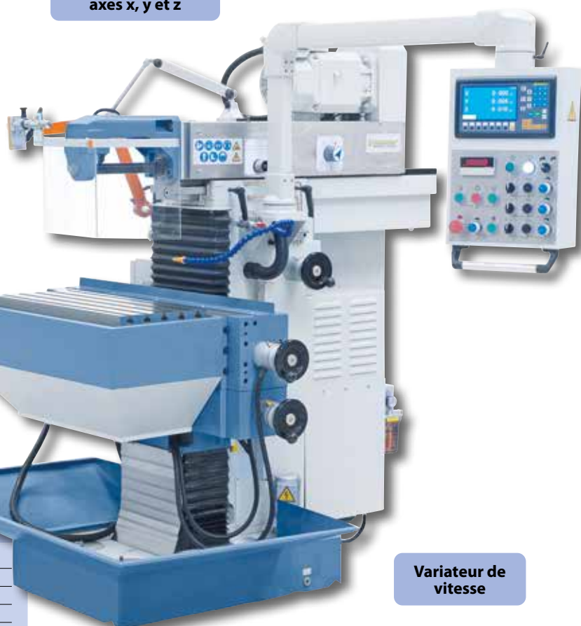
De série avec des manivelles électroniques pour le déplacement manuel dans les axes x, y et z.
