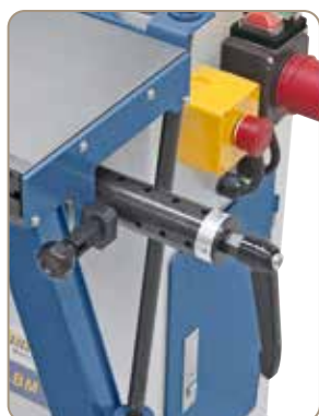
De série avec tourillonneuse, divisions à 16 / 20 / 22 / 25 mm.
