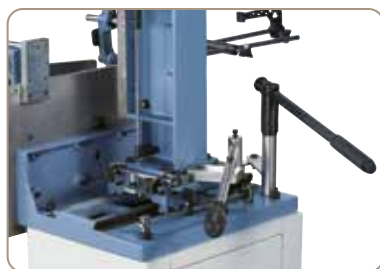
Déplacement transversal et longitudinal avec butées réglables
