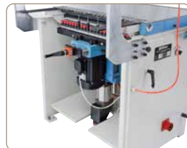
Inclinaison de l'unité de perçage à 0° - 45° - 90° par système pneumatique
