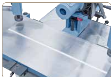
Échelle intégrée dans la table de perçage avec point zéro centré
