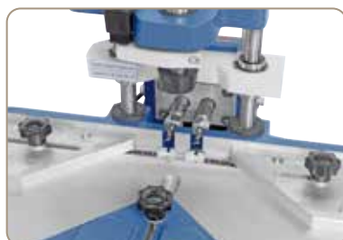
Réalisation simultanée de deux rainures en queue d'aronde à écartement fixe de 28 mm
