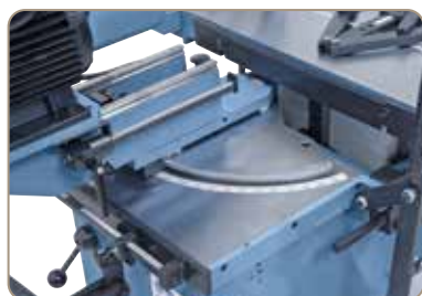
Groupe de perçage pivotant de 60° à gauche et à droite
