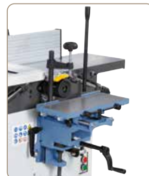
Mortaiseuse en option, idéale pour les perçages oblongs ou obliques, les trous de chevilles, etc.
