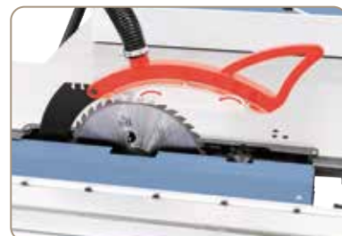
De série avec inciseur pour une découpe nette des matériaux en plaques
