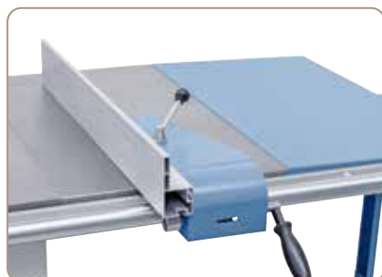
Guide parallèle sur barre ronde (40 mm) très stable, utilisable pour les coupes jusqu'à 1220 mm de large
