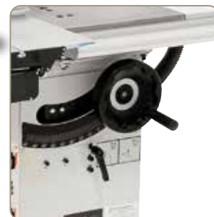
L'angle d'inclinaison de la lame est lisible sur une graduation claire.
