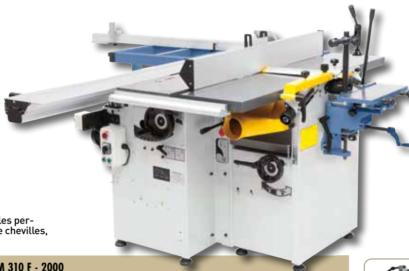
Capot de toupie équipé de rails de guidage en aluminium anodisé
