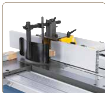
Capot de toupie compatible avec des outils jusqu'à 140 mm de diamètre
