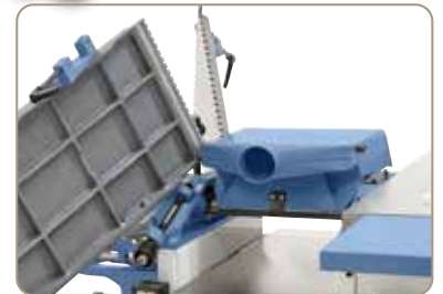
Capot d'aspiration des copeaux intégré, rabattable - diam. du raccord 100 mm
