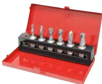
Les forets pleins conviennent idéalement aux sondeuses-carotteuses pour le perçage de petits diamètres (6-13 mm). Par rapport aux forets hélicoïdaux, ils présentent surtout l'avantage d'une stabilité accrue grâce au porte-outil direct Weldon et de rendre superflu l'amorçage au pointeau (foret à deux taillants).
