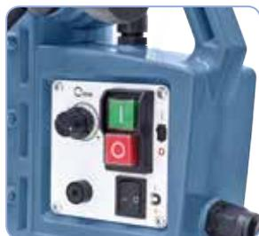
Réglage exact de la vitesse de coupe à l'aide d'un potentiomètre.
