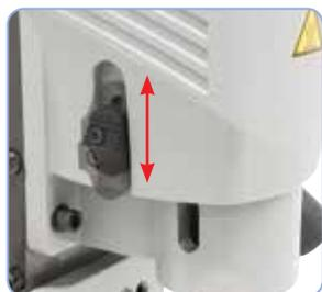
Engrenage à 2 vitesses, vitesse de rotation au choix 230 ou 550 tr/min
