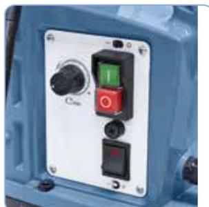
Réglage exact de la vitesse de coupe à l'aide d'un potentiomètre.
