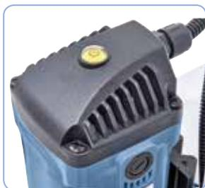
Alignement exact de la machine sur la pièce grâce à la nivelle sphérique de série.
