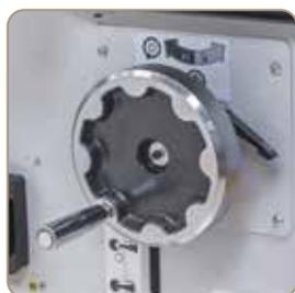
Réglage rapide et simple de la hauteur de broche par manivelle ergonomique.
