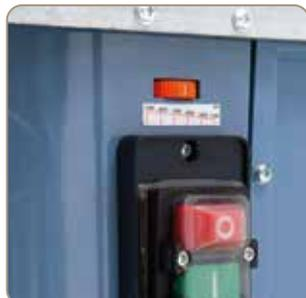
Réglage facile de la vitesse de rotation au moyen d'un régulateur de vitesse de rotation électrique.
