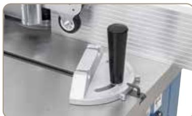
Le guide d'onglet de série s'incline de  $-60^\circ$  à  $+60^\circ$ .
