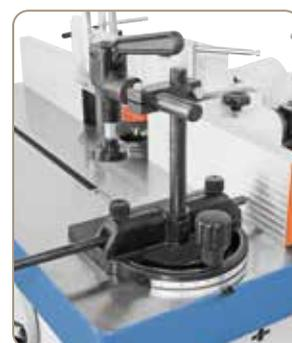
Guide d'onglet avec presseur excentrique inclus (T 1300)
