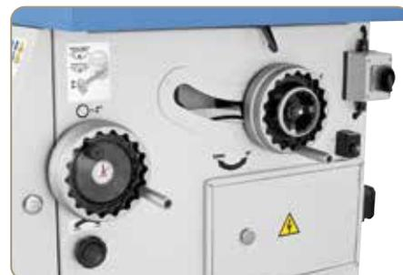
Inclinaison du bloc de fraisage par manivelle ergonomique, graduation lisible sur un affichage digital
