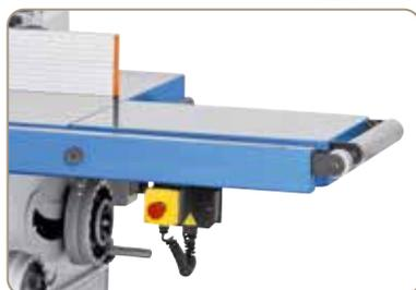
Le galet d'entrée et les élargissements de tables extensibles facilitent la manipulation des pièces à usiner de longue taille.
