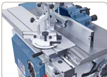
Der standarder Chariot de coupe erleichtert das Bearbeiten größerer Werkstücke.
