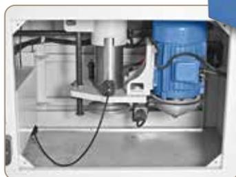
Large bloc de fraisage en fonte grise avec broche à équilibrage dynamique garantissant un travail sans vibrations pour des résultats optimaux
