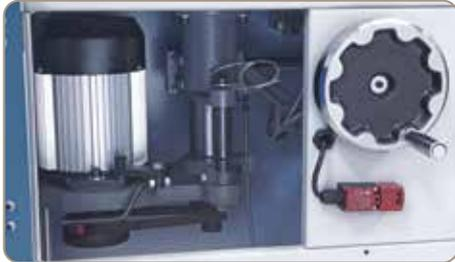
La grande ouverture à l'avant de la machine permet de modifier la vitesse de rotation rapidement et simplement
