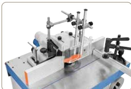
La butée de fraisage massive en fonte grise peut être utilisée pour des outils jusqu'à 180 mm / 225 mm (TS 900 F) ou 250 mm / 335 mm (TS 1000 F). Les rails de butée bilatéraux sont équipés d'un réglage fin de série.
