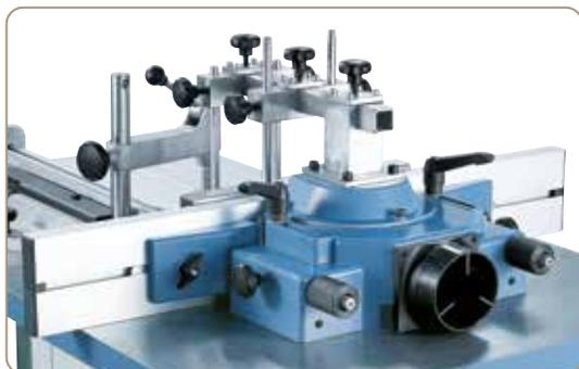
Capot de toupie équipé d'un réglage fin. Évacuation des copeaux par la buse d'aspiration intégrée
