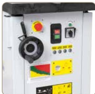
Disposition ergonomique des éléments de commande sur le côté droit de la machine
