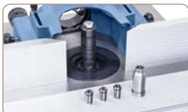
La broche interchangeable permet un énorme gain de temps pour les fraisages en série
