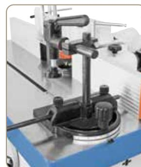
Guide d'onglet avec presseur excentrique inclus (TS 1300)
