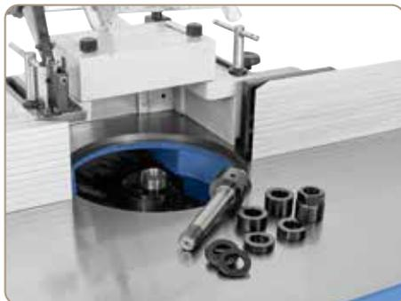
Les broches interchangeables ne modifient pas le réglage des outils, cet qui assure un gain de temps non négligeable pour la réalisation de séries
