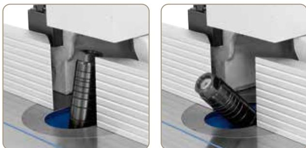
Broche orientable de  $-10^{\circ}$  à  $+45^{\circ}$  et réglable en hauteur sur 180 mm
