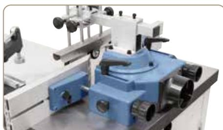
Le guide de fraisage massif peut s'utiliser avec des outils allant jusqu'à 200 mm. Les rails de guidage des deux côtés sont équipés de série d'un réglage fin
