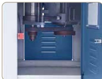
Changement rapide et simple de vitesse de rotation par courroie trapézoïdale
