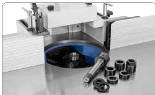
Les broches interchangeables ne modifient pas le réglage des outils, cet qui assure un gain de temps non négligeable pour la réalisation de séries
