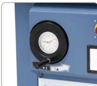
Réglage rapide et simple de la hauteur de broche par manivelle ergonomique.
