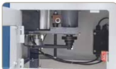
Réglage rapide et simple de la vitesse de rotation par courroie trapézoïdale
