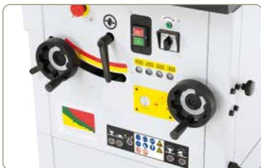
Disposition ergonomique des éléments de commande, affichage électronique de vitesse à LED
