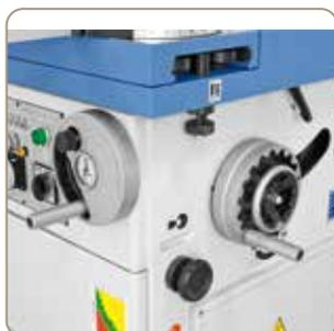
Inclinaison du bloc de fraisage par manivelle ergonomique, graduation lisible sur un affichage digital
