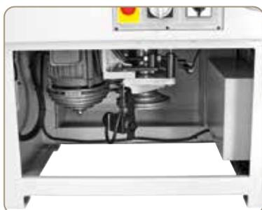
Remplacement de courroie facile pour la sélection de la vitesse via une grande ouverture à l'avant de la machine.
