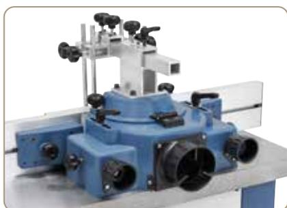
Le guide de fraisage massif peut s'utiliser avec des outils allant jusqu'à 200 mm. Les rails de guidage des deux côtés sont équipés de série d'un réglage fin.
