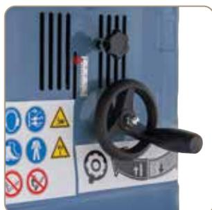
Le réglage en hauteur de la broche de fraiseage est effectué au moyen d'une manivelle et d'une échelle bien lisible.
