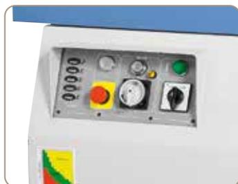
Les éléments de commande sont parfaitement accessibles à l'avant de la machine. Des LED indiquent la vitesse de rotation réglée
