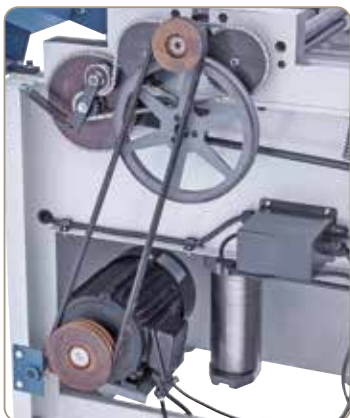
Entraînement à chaîne pour un mouvement régulier des rouleaux d'avance et de sortie
