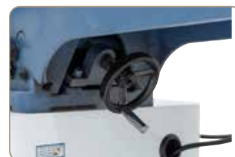
Réglage simple de l'enlèvement par passe, par manivelle
