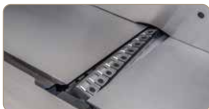
L'unité de rabot stable à arbre de rabot à couteau hélicoïdal garantit les meilleurs résultats de rabotage.
