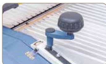
Réglage simple et rapide de l'enlèvement par passe jusqu'à 2 mm maxi
