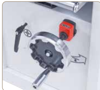
Réglage de hauteur de la table de rabotage au 1/10 mm avec affichage digital
