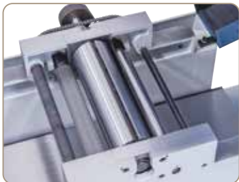
L'arbre à 4 fers à roulements de précision et le rouleau d'avance à denture droite assurent un rabotage de qualité
