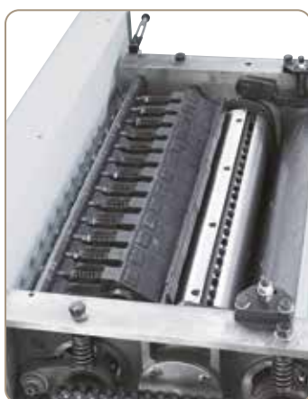
Robuste bloc de rabotage avec arbre 4 fers de précision de 120 mm, garantit un résultat net même en cas de forte charge.
