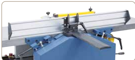
Guidage prismatique précis pour le positionnement du guide parallèle
