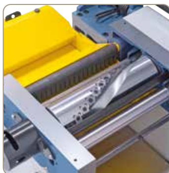
Émissions sonores réduites en raison des lèvres sur les deux côtés du plateau.
