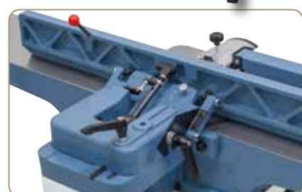
Robuste système d'inclinaison du guide avec butées réglables
