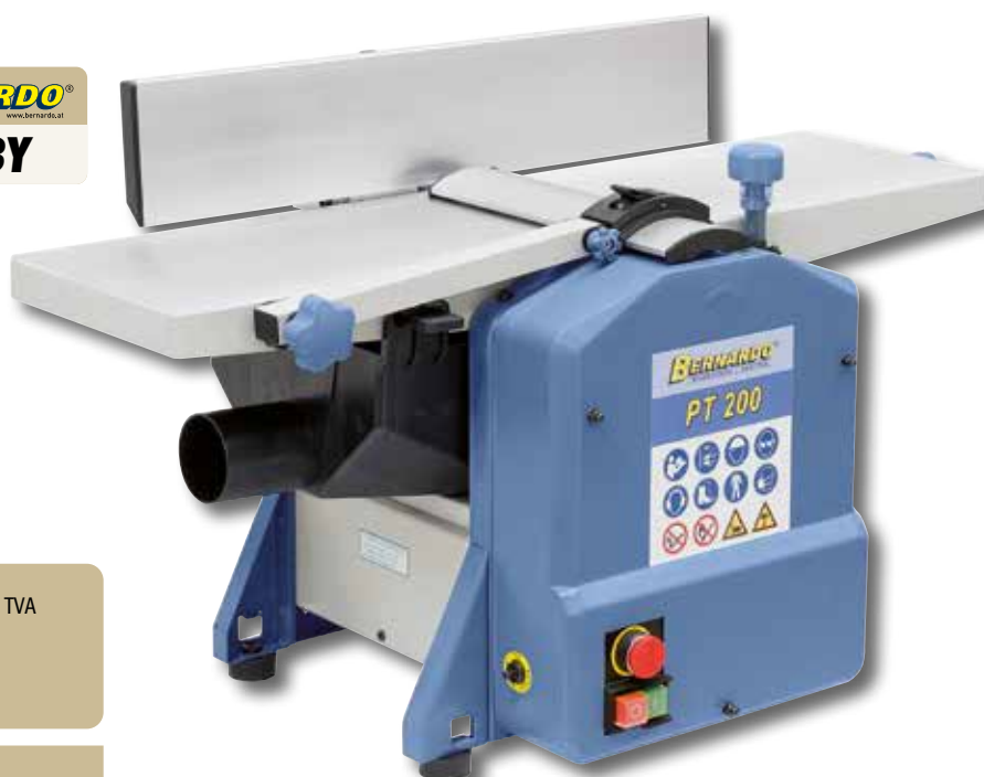
Capot d'aspiration combiné utilisable pour au choix pour le dégauchissage ou pour le rabotage
