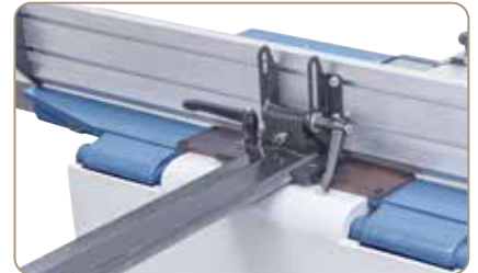
Guidage prismatique précis pour le positionnement du guide parallèle
