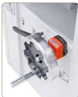
Réglage de hauteur de la table de rabotage au 1/10 mm avec affichage digital
