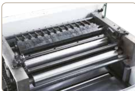
Robuste bloc de rabotage avec arbre 4 fers de précision de 120 mm, garantit un résultat net même en cas de forte charge.
