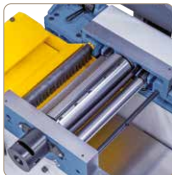
Émissions sonores réduites en raison des lèvres sur les deux côtés du plateau.
