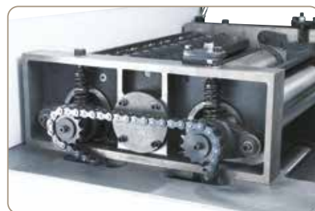
Entraînement à chaîne pour un mouvement régulier des rouleaux d'avance et de sortie.
