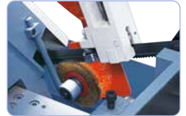
Kuulalakaeroidut teränohjaimet ja teräsharja optimaalisiin sahaustuloksiin.
