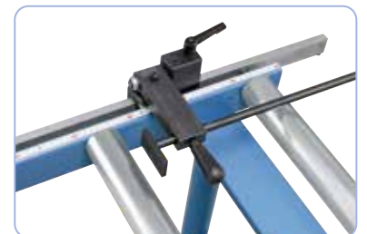
Millimetriasteikko mahdollistaa sahauspituuden tarkan säädön ja on helppo lukea
