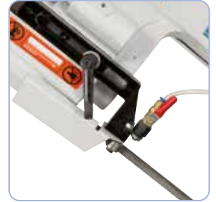
Kuulalaakeroitu teräohjain, säädettävissä kulloisenkin työkappaleen leveyden mukaan, jäähdytysnesteliitos
