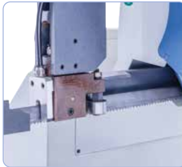
Yhdistetyt rulla-carbidijohdeet estää liiallisen teränpainamisen
