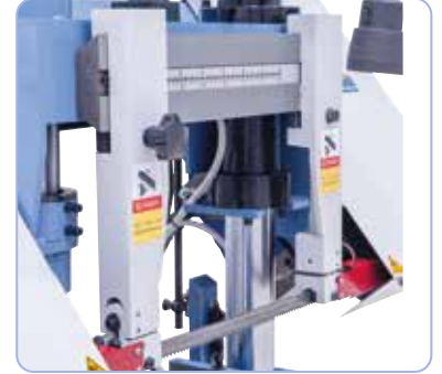
Säädettävä teränohjain estää sen, että terä liikkuu tai kallistuu sivusuunnassa.
