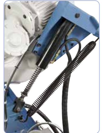
Vakiovarusteena hydraulisyliinteri sahakaaren pehmeää laskemista varten.
