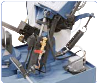
Hydraulisylinteri sahakaaren portaattonta laskemista varten.
