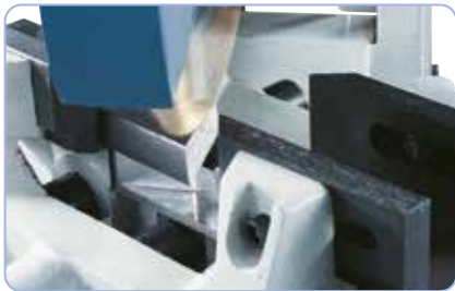
Käännettävä vaihepää (45° oikealle / vasemmalle), optimaalinen viistesahaukseen.
