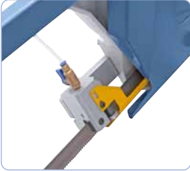
Yhdistetyt rulla-carbidijohteet estää liiallisen teränpainamisen
