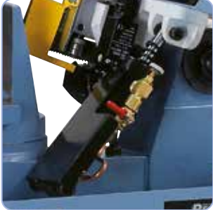
Vakiovarusteena hydraulisyylinteri sahakaaren pehmeää laskemista varten.
