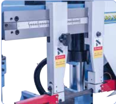
Säädetty teränohjain estää sen, että terä liikkuu tai kallistuu sivusuunnassa.
