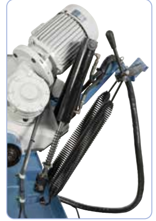
Vetojousella voi säätää manuaaliseen käyttöön.
