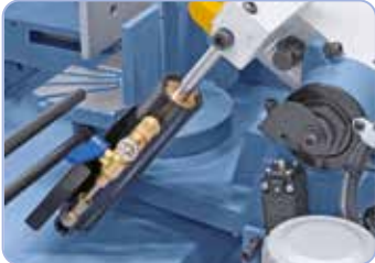
Hydraulisylinteri sahakaaren portaatonta laskemista varten.
