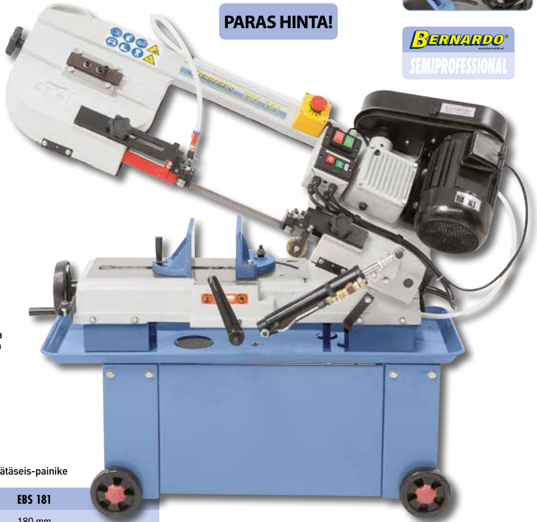
Tehokas jäähdytyspumppu integroituna jalustaan ja näin ollen vaatii vähän tilaa
