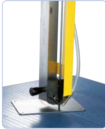
Kuulalaakeroitu teräohjain, säädettävissä kulloisenkin työkappaleen korkeuden mukaan.
