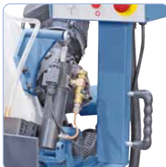
Iso hydraulisylinteri sahakaaren portaattomaan laskemiseen
