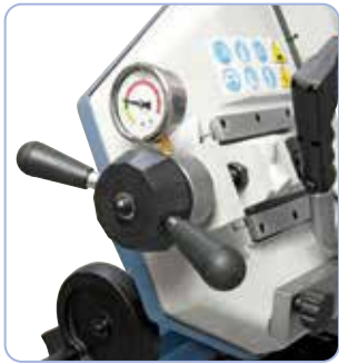
Vakiona oleva painemittari mahdollistaa optimaalisen terätkireyden asetuksen.
