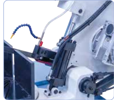
Suuri hydraulisylinteri, suunniteltu jatkuvaan käyttöön.
