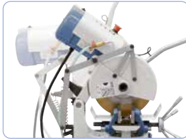
Suojus avautuu automaattisesti vaihdettä laskettaessa.
