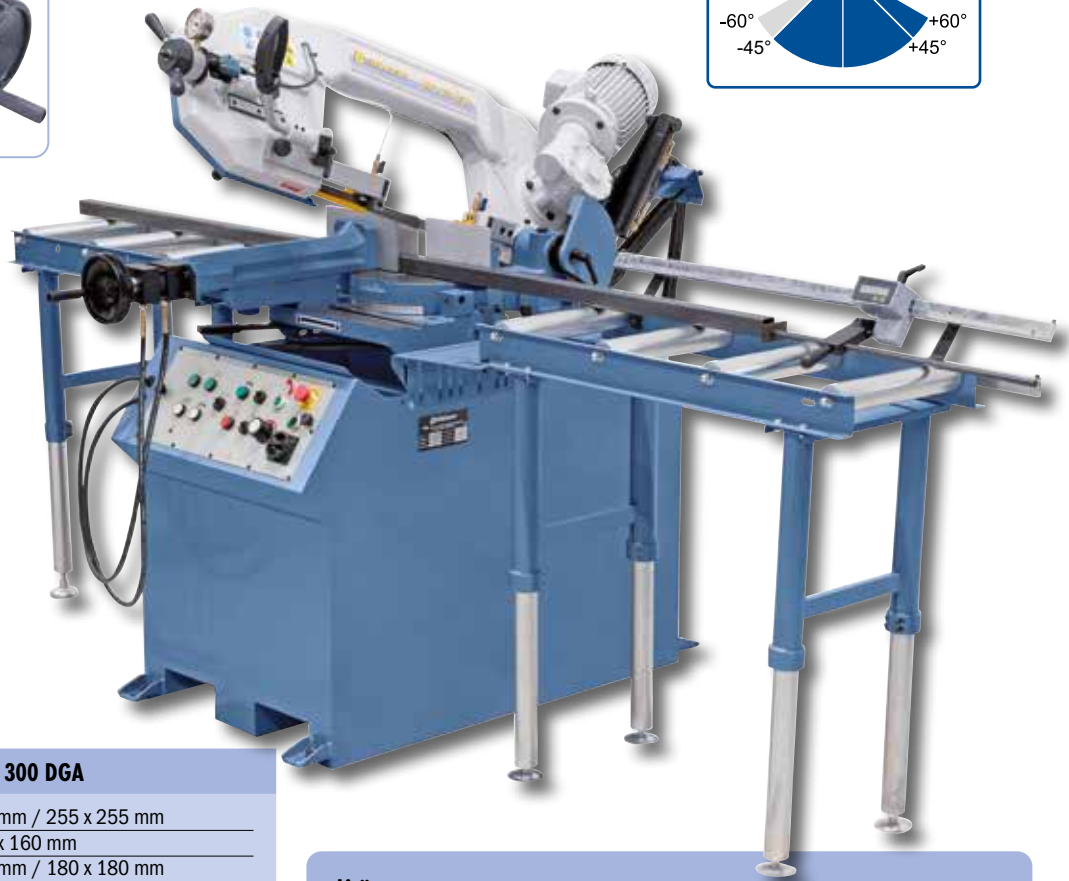
Vakiona hydraulinen laskusylinteri sahakaaren portaatonta laskua varten ja automaattinen poiskytkentä, kun materiaali on leikattu.
