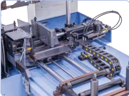
Materiaalin syöttö hydraulisen kiinnityslaitteen kautta ja tarkan pyöröohjaimen kautta
