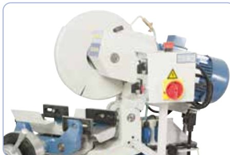
Vaihdettäviä voidaan kääntää 90° oikealle ja vasemmalle
