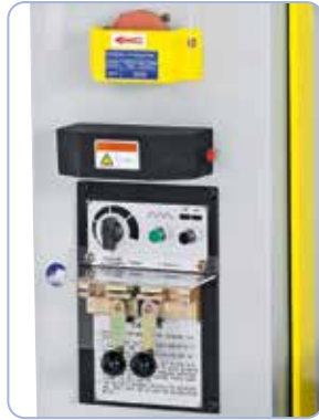
Vakiona teränliitoslaite, leikkuri ja hiomakivi
