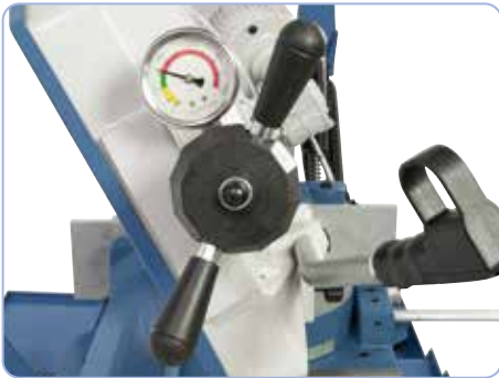
Vakiona oleva painemittari mahdollistaa optimaalisen teränkireyden asetuksen.
