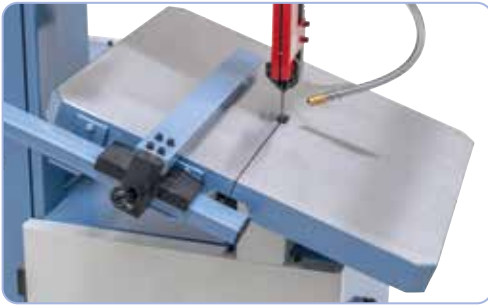
Kallistuva työpöytä valuraudasta.
