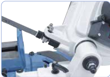
Kuulalaakeroitu teräöhjain optimaaliseen sahaustulokseen
