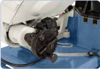
Sahakaaren painetta voidaan säätää 3 asetuksella
