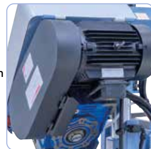
Hihnakoneisto, jossa on 3 säädettävää leikkuunopeutta.
