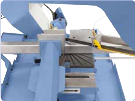
Pikalukituksella varustettu ruuvipuristin on käännettävissä kaksoisviistesahauksia varten
