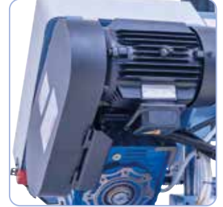
Hihnakoneisto, jossa on 3 säädettyä leikkuunopeutta.
