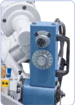
Portaattomasti laskeva sahakaari hydraulisyliinterin ansiosta.
