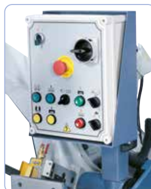
Kytkimet on asennettu selkeästi käännettävälle ohjauspöydälle.
