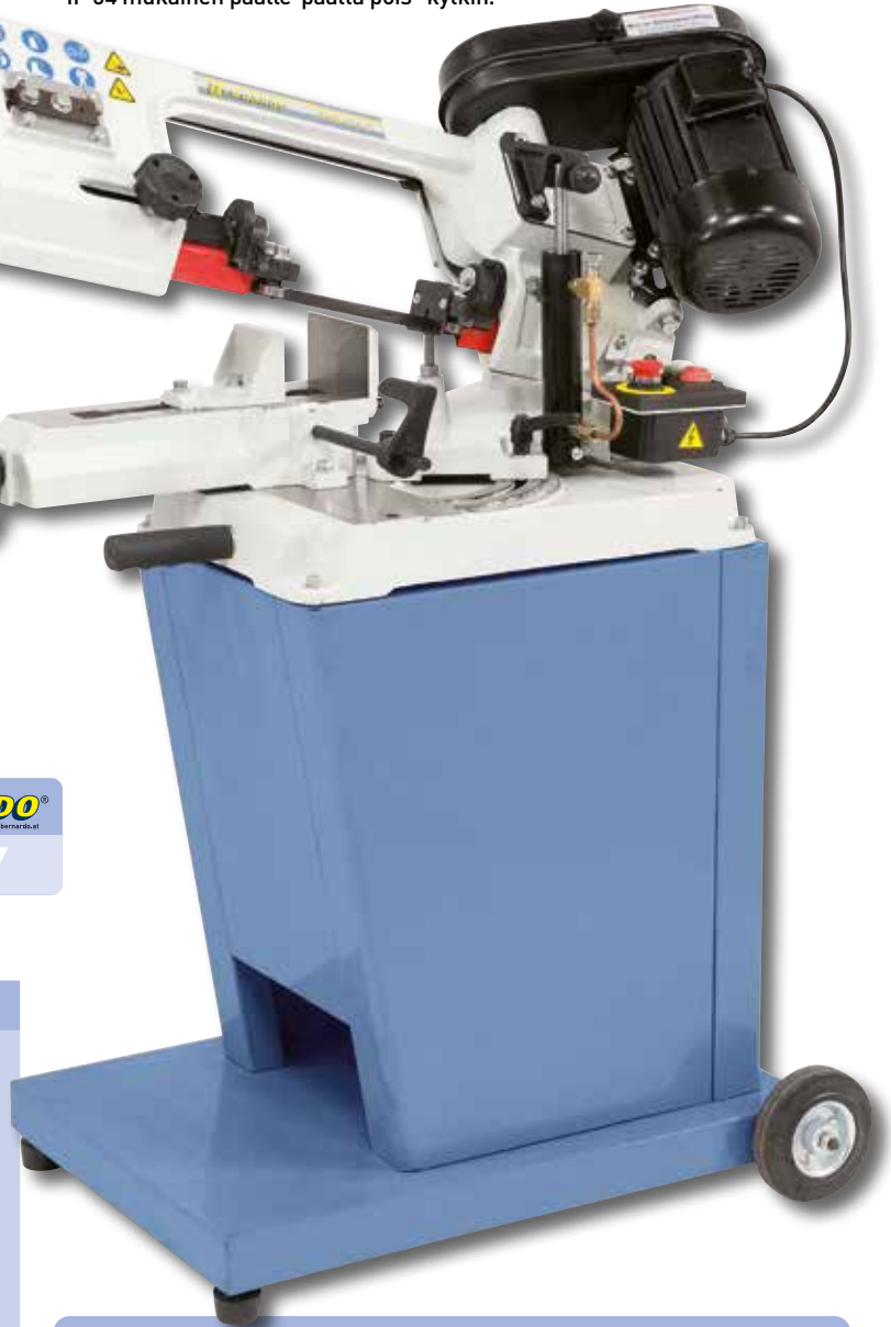
Vakiona automaattinen päältä pois -kytkentä. IP 54 mukainen päälle-päältä pois -kytkin.
