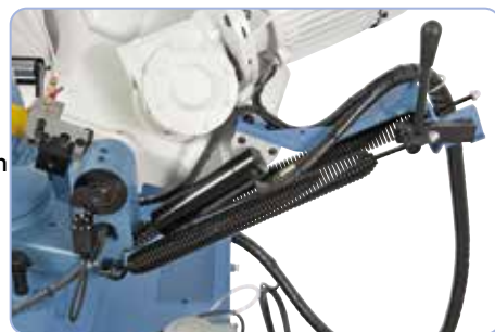
Vetojousella voi säätää manuaaliseen käyttöön.
