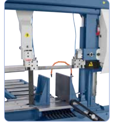
Siirrettävä teränohjain voidaan sovittaa optimaaliseksi kulloistakin työkappaletta varten.
