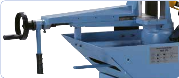
Massiivinen, harmaavalurautainen ruuvipuristin on varustettu pikalukituksen - optimaalinen sarjoja työstettäessä.
