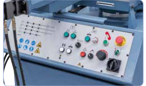
Portaattoman sahausnopeuden kytkin ja sahakaaren paineen säätöventtiili ovat ergonomisesti sijoitetussa käyttöpaneelissa.
