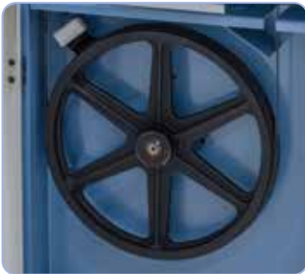
Hihnapyörät sisältävät erikois kumihihnan joka takaa pehmeän koneen käytön ja pidentää terän käyttöikää.
