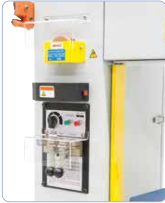
Vakiona teränliitoslaite, leikkuri ja hiomakivi.
