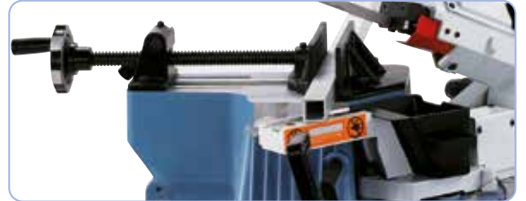
Sisältää pikakiinnitteisen ruuvipuristimen ja lastuallas.
