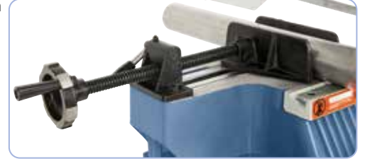
Vakiona patentoitu pikakiristysruuvipenkki
