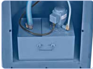
Tehokas jäähdytyspumppu integroituna jalustaan ja näin ollen vaatii vähän tilaa
