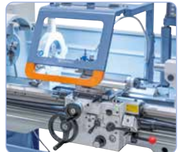
Kelkan ja huippukelkan pitkittäis- ja poikkitaivutusta varten käytettävissä on 17 vapaasti valittavaa syöttöä.
