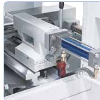
Vakiona takapylkkäkaran hydraulinen säätö.
