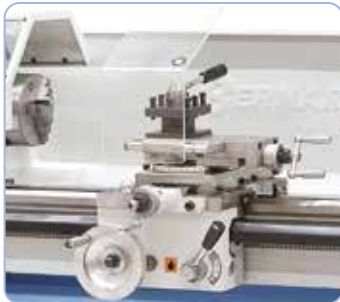
Kevyt kulkuinen ja tarkka kelkka, jossa on huippukelkka. Pitkä käyttöikä välyksettömien, säädettävien kiilojen ansiosta
