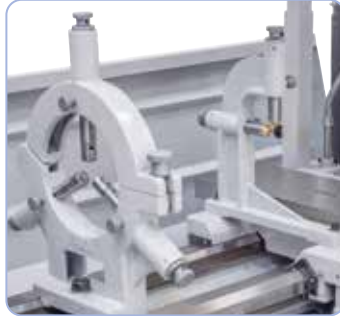
Vakiona kiinteä tai liukuva tukipytkä pitkien työkappaleiden vakauttamiseen.
