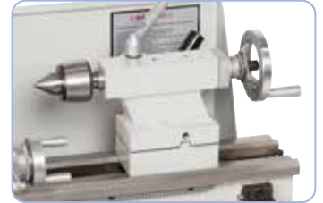
Takapylkkä, joka kiristetään vivulla, voidaan säätää kartiosorvausta varten, lisävarusteena keskiökärki
