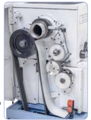
Tarkkuuskuulalaakeroitu, karkaistu pääkara takaa hyvän pyörimistarkkuuden, optimaalinen voimansiirto hammaistettujen Optibelt -kiilahihnojen ansiosta
