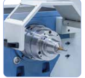
Lisävaruste: kiristysholkkisarja 5C, kiristysalue 3 - 26 mm
