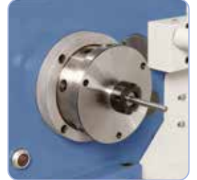
Kiristysholkki-istukka ER 25 takaa hyvän pyörimistarkkuuden kiinnitetyille työkappaleille, kiristysalue 1 - 16 mm
