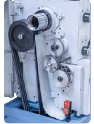
Tarkkuuskuulalaakeroitu, karkaistu pääkara takaa hyvän pyörimistarkkuuden, optimaalinen voimansiirto hammastettujen Optibelt -kiilahihnojen ansiosta
