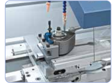
Pikavaihtoteränpidin mahdollistaa koneen käyttämiseen tarvittavan ajan lyhenemisen ja takaa hyvän toistotarkkuuden.
