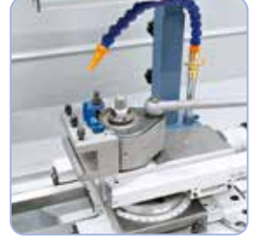
Koneeseen voidaan asentaa pikavaihtoteränpidin.
