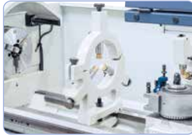
Kiinteä tukipylkkä pitkien työkappaleiden vakauttamiseen
