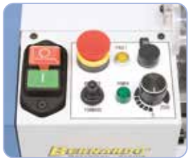
Karan pyörimisnopeus voidaan säätää portaattomasti, vakiona suunnanvaihto.
