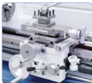
Kytkinvipu pitkittäis- ja poikkittäissyötön säätämiseen.
