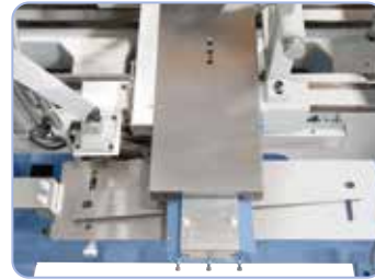
Kartiosorvauslaite lisävarusteena saatavana, sorvauspituus 455 mm, asetuskulma \pm 8^\circ
