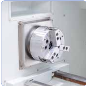
Hydraulinen 3-leukaistukka, halkaisija 200 mm
