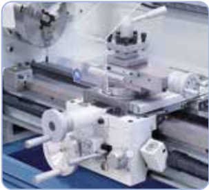
Kytkinvipu pitkittäis- ja poikittaissyötön säätämiseen.
