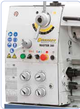
Helppo syötön ja kierrosluvun säätö etupaneelissa, karkaistujen ja hiottujen, jatkuvasti öljyssä olevien hammaspyörien ansiosta käynti on erittäin tasaista.
