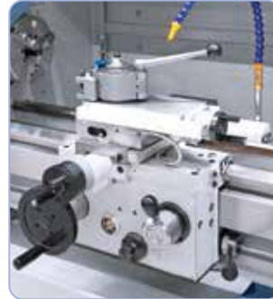
Kelkan ja huippukelkan pitkittäis- ja poikittaisliikettä varten käytettävissä on 20 vapaasti valittavaa syöttöä.
