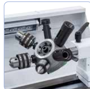
Koneeseen voidaan asentaa revolveripää työskentelyn tehostamiseksi
