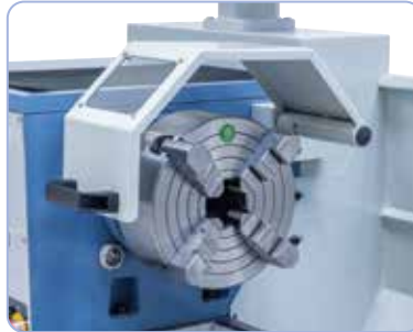
Keskele kiinnitettävä 4-leukaistukka 200 mm, optimaalinen nelikulmaisille työkappaleille (lisävaruste).
