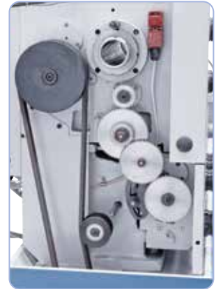
Vakiovarusteena vaihtopyörät kierteitykseen.
