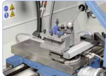
Vakiona pikavaihtoteränpidin, Multifix-järjestelmä (Standard 165 Top)
