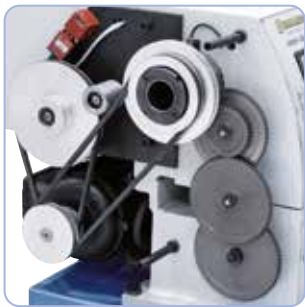
Kierrosluvun porras säädetään helposti kiilahihnan avulla
