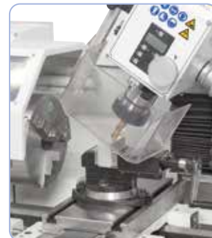
Kallistettavan jyrsinpään ansiosta työskentelyvaihtoehdot lisääntyvät.
