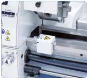
Vakiona johtoruuvien suojaus ja mikrometri pitkittäisvasteessa (700 Top)
