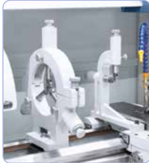
Vakiona kiinteä tai liikkuva tukipytkä pitkien työkalujen vakauttamiseen.
