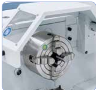
4-leukaistukka (lisävaruste) epätasaisten työkappaleiden kiinnittämiseen
