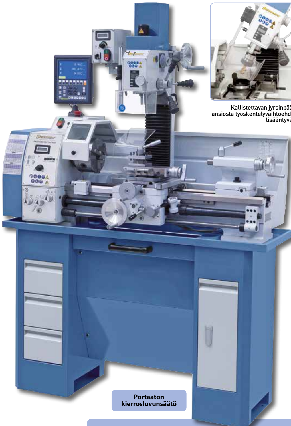
Kelkkaan sisältyy käsipyörä mitta-asteikolla. Tässä mallissa on lisäksi automaattinen poikittaissyöttö.
