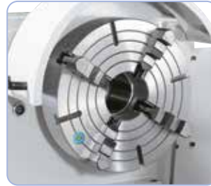
4-leukaistukka 250 mm (lisävaruste) ihanteellinen epäsymmetristen työkalujen kiinnittämiseen.
