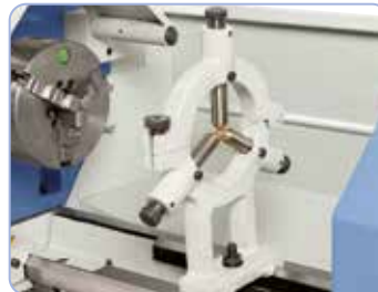
Kiinteä tukipylkkä, jossa pronsisijohde pitkien työkappaleiden vakauttamiseen
