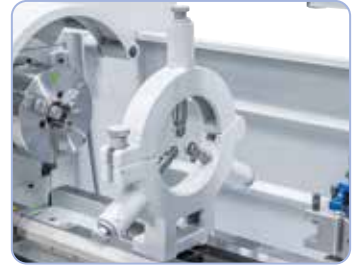
Kiinteä tukipylkkä pitkien ja ohuiden työkappaleiden tukemiseen.
