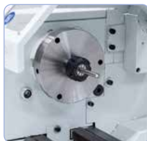
Kiristysholkki-istukka ER 25 takaa hyvän pyörimistarkkuuden kiinnitetyille työkappaleille, kiristysalue 1 - 16 mm.
