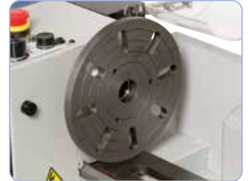
Erityismuotoisten työkalupaleiden kiinnittämiseksi voidaan koneeseen asentaa kiinnitysliukka 160 mm.
