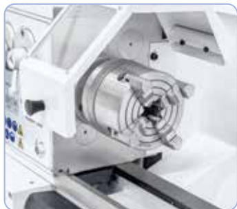
4-leukaistukka 100 mm (lisävaruste) epäsymmetristen työkappaleiden kiinnittämiseen
