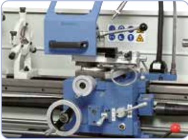
Kevytkulkuinen ja tarkka kelkka, jossa on huippukelkka ja nelisuuntainen teränpidin sekä säädettävällä metrisellä mitta-asteikolla varustetut käsipyörät
