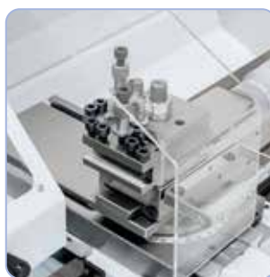
Koneeseen voidaan asentaa pikavaihtoteränpidin
