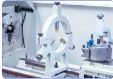
Kiinteä tukipylkkä pitkien työkappaleiden vakauttamiseen
