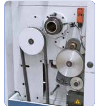
Vakiovarusteena täysi sarja vaihtopyöriä kiertteitykseen.
