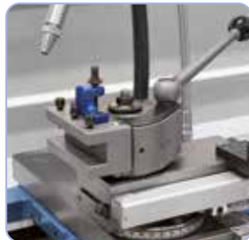
Koneessa on vakiona pikavaihtoteränpidin. (Standard 165 V-Top).
