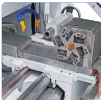
Toimitukseen kuuluu automaattinen 6-kertainen työkalurevolveri.
