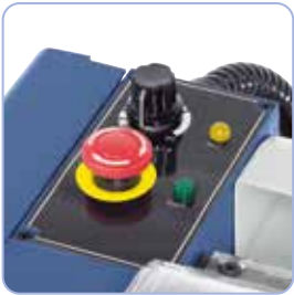
Portaaton pääkaran kierrosluvun säätö potentiometrillä.
