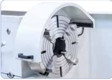
4-leukaistukka 400 mm (lisävaruste) ihanteellinen epäsymmetristen työkappaleiden kiinnittämiseen.
