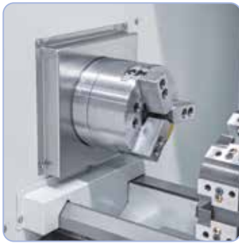
Hydraulinen 3-leukaistukka, halkaisija 200 mm
