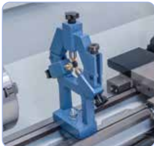
Kiinteä tukipylkkä, jossa pronssijohde pitkien työkalupaleiden vakauttamiseen.
