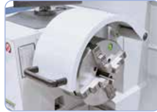
Keskele kiinnitettävä 4-leukaistukka 200 mm, optimaalinen nelikulmaisille työkappaleille (lisävaruste).
