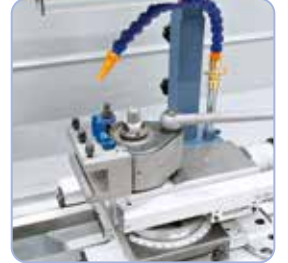
Koneeseen voidaan asentaa pikavaihtoteränpidin.
