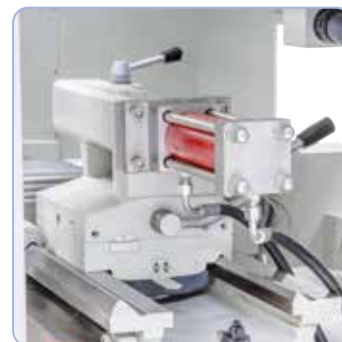
Vakiona takapylkkäkaran hydraulinen säätö.
