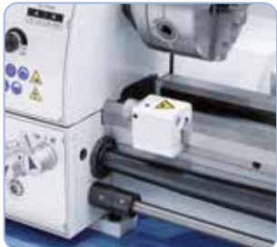
Mallissa 700 PRO on turvakytkin ja mikrometri pitkittäisvasteessa
