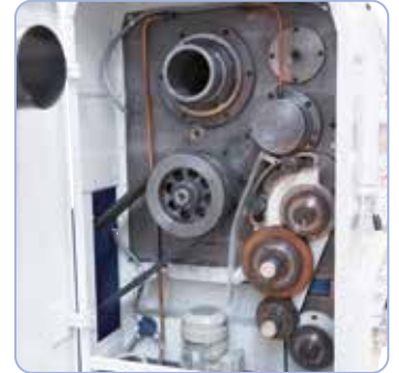
Karkaistu pääkara, karan reikä 130 mm, on laakeroitu kartiorullalaakereihin ja säteittäiskuulalaakeriin.
