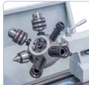
Koneeseen voidaan asentaa revolveripää työskentelyn tehostamiseksi
