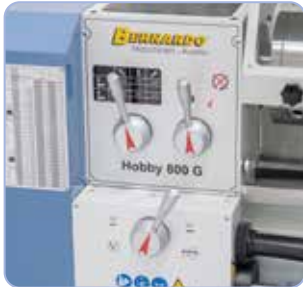
Karapylkkään asennetut kytkimet tekevät kierrosluvun vaihdon helpoksi ja nopeaksi
