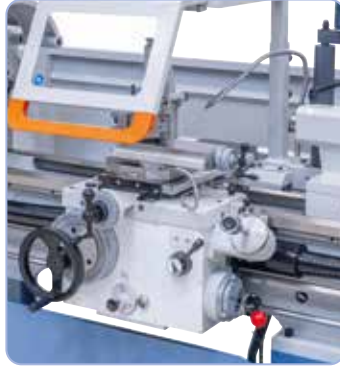
Kelkan ja huippukelkan pitkittäis- ja poikittaisliikettä varten käytettävissä on 42 vapaasti valittavaa syöttöä.
