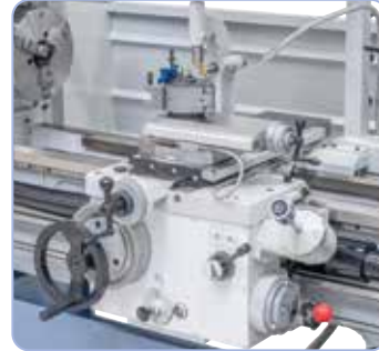
Kelkan ja huippukelkan pitkittäis- ja poikittaisliikettä varten käytettävissä on 42 vapaasti valittavaa syöttöä.
