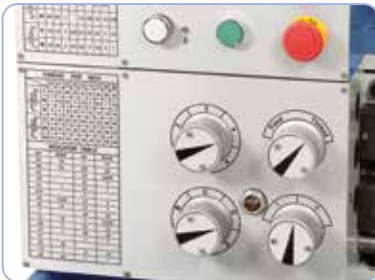
Syöttövaihteet helposti ja tarkasti kytkettävissä
