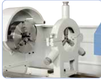
Kiinteä tukipylkkä pitkien työkappaleiden vakauttamiseen
