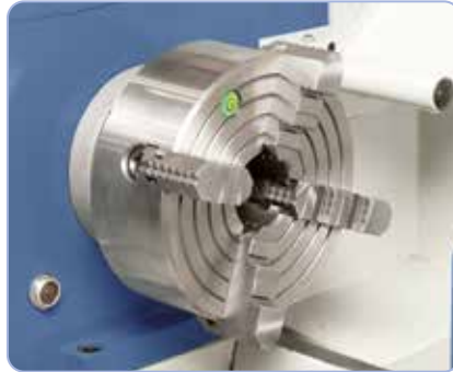
4-leukaistukka 200 mm (vakio) ihanteellinen epäsymmetristen työkalujen kiinnittämiseen
