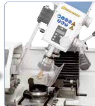
Kallistettavan jyrsinpään ansiosta työskentelyvaihtoehdot lisääntyvät.
