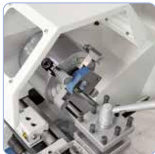
4-leukaistukka 160 mm (lisävaruste) ihanteellinen epäsymmetristen työkappaleiden kiinnittämiseen.
