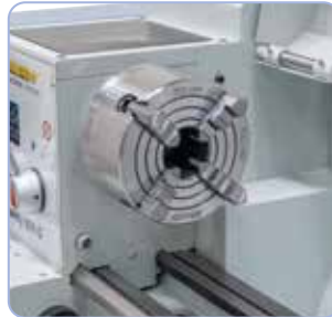
4-leukaistukka (lisävaruste) epätasaisien työkalupaleiden kiinnittämiseen
