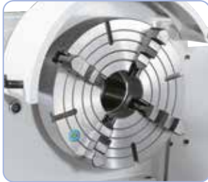
4-leukaistukka 400 mm (lisävaruste) ihanteellinen epäsymmetristen työkappaleiden kiinnittämiseen.
