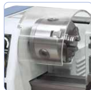
3-leukaistukka 80 mm, jossa CE-merkinnällä varustettu suojustus
