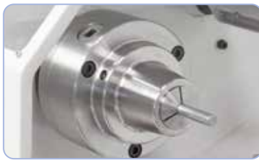
Lisävaruste: kiristysholkkisarja 5C, kiristysalue 3 - 26 mm.
