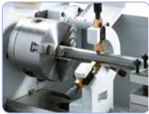
Kiinteä tukipylkkä, jossa pronssijohde pitkien työkalupöytäiden vakauttamiseen.
