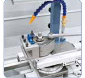
Koneeseen voidaan asentaa pikavaihtoteräpinidin.
