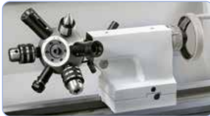
Lisävaruste: revolveripää, jossa 6 paikkaa
