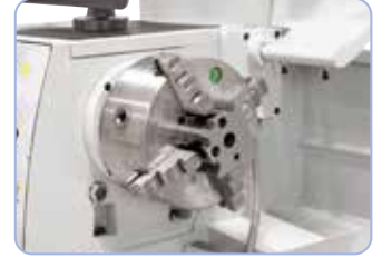
Keskelle kiinnitettävä 4-leukaistukka 200 mm, optimaalinen nelikulmaisille työkaluille (lisävaruste).
