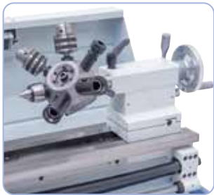
Koneeseen voidaan asentaa revolveripää.
