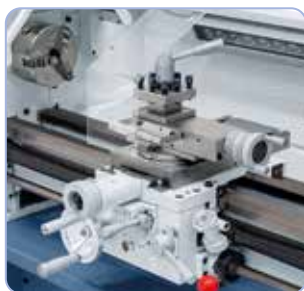
Pehmeästi liikkuva yläkelkka ja neliteränpidin käsipyörällä säädettävissä
