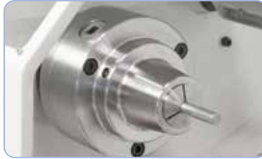
Lisävaruste: kivistysholkkisarja 5C, kivistysalue 3 - 26 mm.
