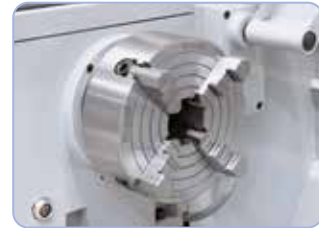
4-leukaistukka 200 mm (lisävaruste) ihanteellinen epäsymmetristen työkappaleiden kiinnittämiseen.
