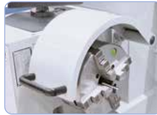
Keskele kiinnitettävä 4-leukaistukka 200 mm, optimaalinen nelikulmaisille työkaluille (lisävaruste).
