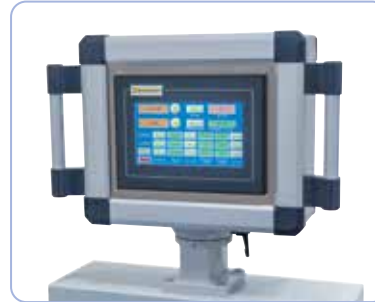
Digitaalisen näytön ja kaikkien asetusten (kierrosluku, syöttönopeus, kierteen nousu...) lukeminen kosketusnäytön avulla.
