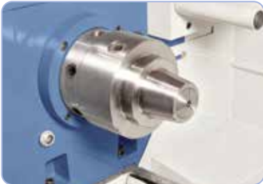
Lisävaruste: kiristysholkkisarja 5C, kiristysalue 3 - 26 mm
