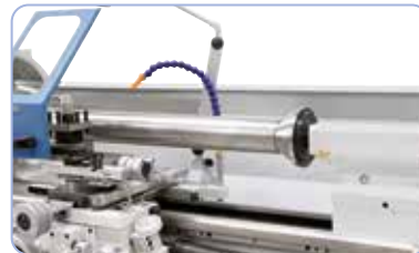
Kartion halkaisija 125 mm, ihanteellinen putkien ja onttojen kappaleiden kiinnittämiseen (lisävaruste).
