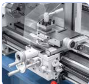
Pehmeästi liikkuva yläkelkka ja neliteräpinä käsipyörällä säädettävissä
