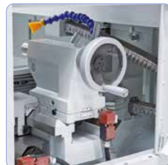
Tukeva takapylkkä, jossa on karankiinnitys MK 4, voidaan muuttaa kartiosorvaamista varten.
