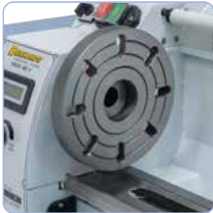
Erityisten muotoisten työkappaleiden kiinnittämiseksi voidaan koneeseen asentaa 170 mm kiinnityslaikka
