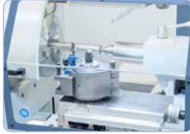
Koneessa on vakiona pikavaihtoteränpidin.
