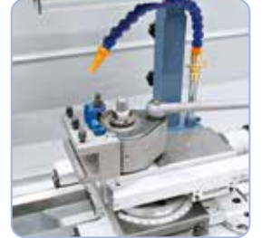
Koneeseen voidaan asentaa pikavaihtoteränpidin.
