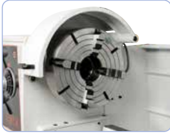
4-leukaistukka 400 mm (lisävaruste) ihanteellinen epäsymmetristen työkappaleiden kiinnittämiseen.
