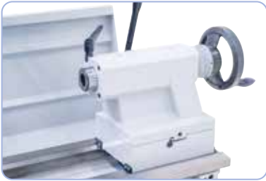
Tukeva takapylkkä, jossa on karankiinnitys MK 4, voidaan muuttaa kartiosorvaamista varten.
