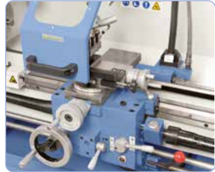
Kevytkulkuinen ja tarkka kelkka, jossa on huippukelkka ja nelisuuntainen teränpidin sekä säädettävällä metrisellä mitta-asteikolla varustetut käsipyörät
