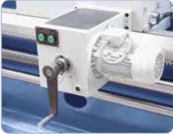
Moottorilla säädettävä kärkipylkkä (kärkiväli alkaen 3000 mm)
