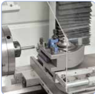
Koneeseen voidaan asentaa pikavaihtoteränpidin.
