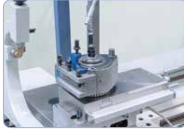
Koneessa on vakiona pikavaihtoteränpidin.
