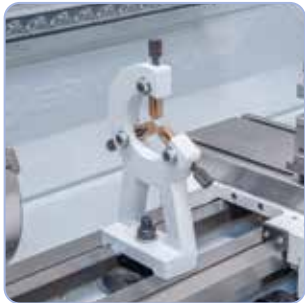
Kiinteä tukipytkä, jossa pronssijohde pitkien työkappaleiden vakauttamiseen.
