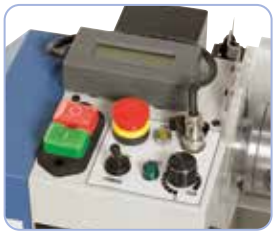
Halutun kierrosluvun tarkkaa säätämistä varten koneeseen voidaan asentaa digitaalinen kierrosluvunnäyttö.
