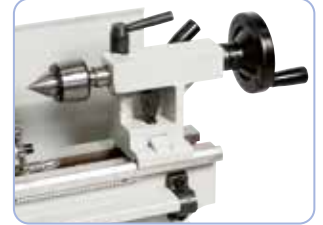
Takapylkkä, jossa MK 2 kiinnitys, voidaan muuttaa kartiosorvaamista varten
