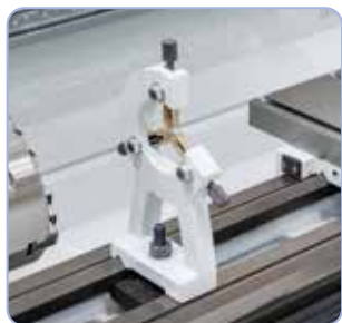
Kiinteä tukipylkkä, jossa pronssijohde pitkien työkappaleiden vakauttamiseen.
