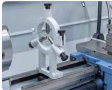
Kiinteä tukipylkkä, jossa pronssi johde pitkien työkappaleiden vakauttamiseen
