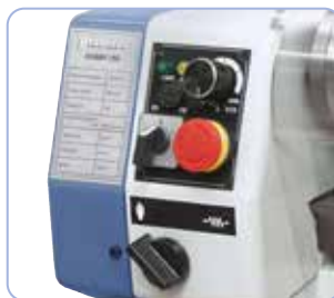
Helppokäyttöinen, kaikki kytkimet sijoitettu karanpäähän
