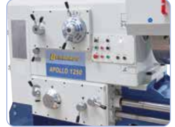
Selkeästi asennetut kytkimet etupaneelissa sekä karaistut ja hiotut hammasrattaat huolehtivat tasaisesta käynnistä.
