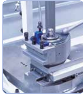
Koneessa on vakiona pikavaihtoteränpidin.
