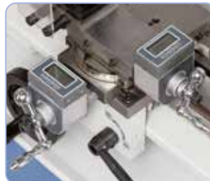
Vakiona digitaalinäytöt tarkkaan säätämiseen ja lukemiseen sorvauksen aikana.
