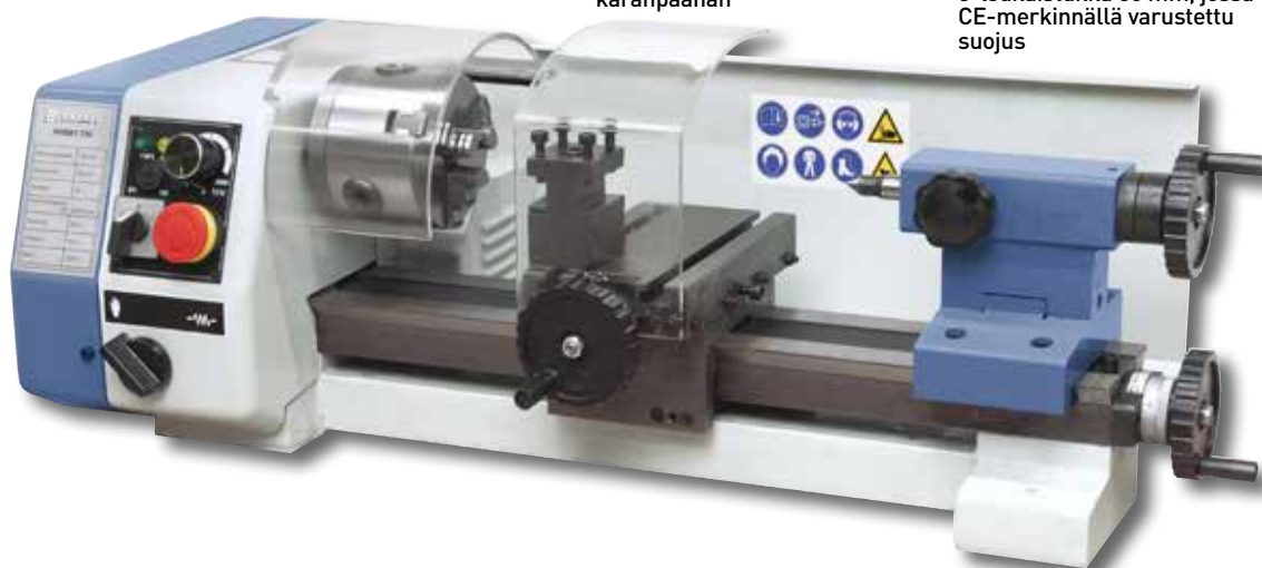
Helppokäyttöinen, kaikki kytkimet sijoitettu karanpäähän
