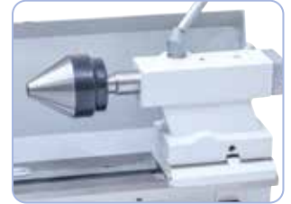
Kartion halkaisija 60 mm, ihanteellinen putkien ja onttojen kappaleiden kiinnittämiseen (lisävaruste)
