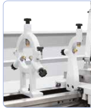
Vakiona kiinteä tai liikkuva tukipylkkä pitkien työkappaleiden vakauttamiseen.
