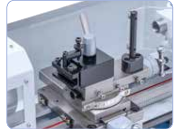
Koneessa on vakiona pikavaihtoteränpidin
