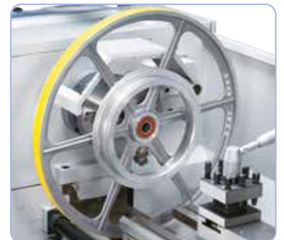
Liikkuva sorvaustuki maks. ø 450 mm työkappaleiden työstämiseen.
