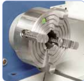
4-leukaistukka 200 mm, jossa kääntöleuka, sisältyy vakiovarusteisiin
