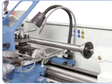
Kartion halkaisija 100 mm, ihanteellinen putkien ja onntojen kappaleiden kiinnittämiseen (lisävaruste)
