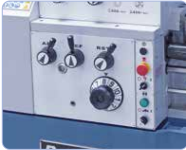
Syöttövaihte voidaan kytkeä helposti ja tarkasti, hiotut hammaspyörät pitävät huolen tasaisesta käynnistä.
