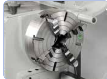
4-leukaistukka 320 mm (lisävaruste) ihanteellinen epäsymmetristen työkappaleiden kiinnittämiseen.
