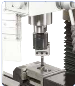
Haluttaessa kone voidaan varustaa avaruspäällä.
