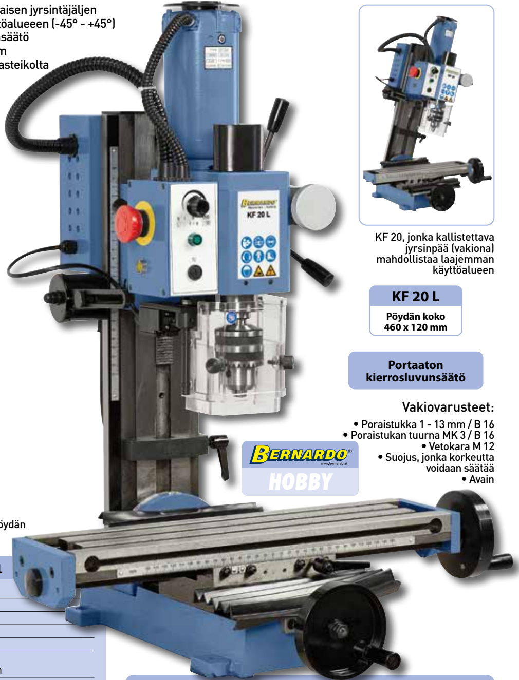
Mekaaninen kierrosluvun säätö ja portaattomasti säädettävä tasavirtamoottori
