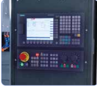
Valinnaiset ohjaukset Siemens Sinumerik 808 D Advanced 16 tai 828D.
