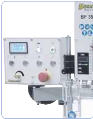
Toimitukseen sisältyy digitaalinen kierrosluvun ja poraussyvyyden näyttö
