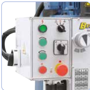
Selkeästi asennetut kytkimet (kierteitys, Start-Stop,...)
