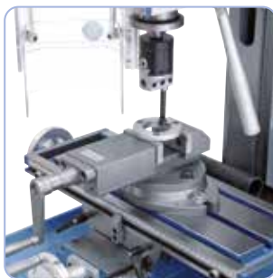
Haluttaessa kone voidaan varustaa avaruspäällä.
