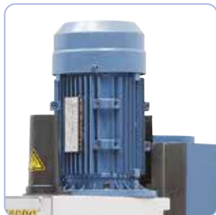
Tehokas 2-nopeusmoottori, käyttöteho 1,1 / 1,5 kW.
