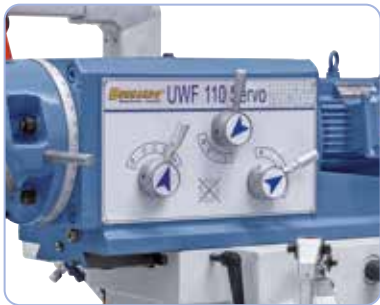
Kierrosluvun vaihtamiseen tarkoitettujen kytkinten käyttö on helppoa.
