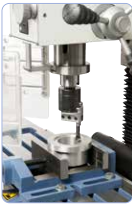
Haluttaessa kone voidaan varustaa avarruspöydällä.
