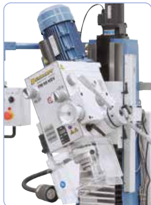
Molemmipuolisesti kallistettava jyrsinpää -60° - +60°
