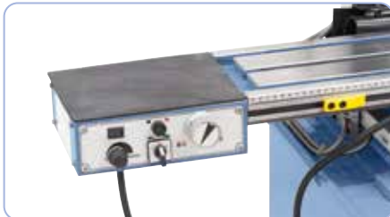
Lisävarusteena portaattomasti säädettävä pöydänsyöttö edistää tehokkuutta.
