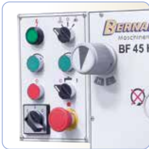
Selkeästi porapäähän asennetut kytkimet ja ohjaimet
