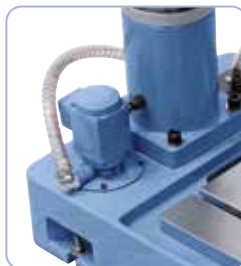
Vakiovarusteena tehokas jäähdytyspumppu
