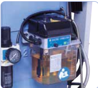
Sähköinen keskusvoitelu kaikille ohjainkiskoille ja karoille
