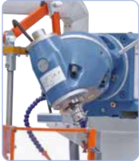
Yleisjyrsinpää, säädettävissä erilaisiin kulma-asentoihin
