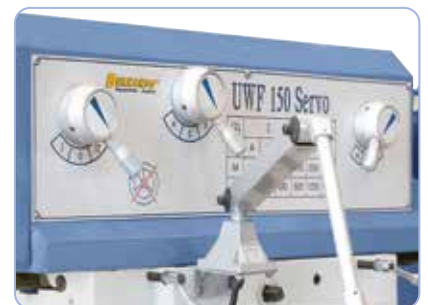
Kierrosluvun vaihtamiseen tarkoitettujen kytkinten käyttö on helppoa.
