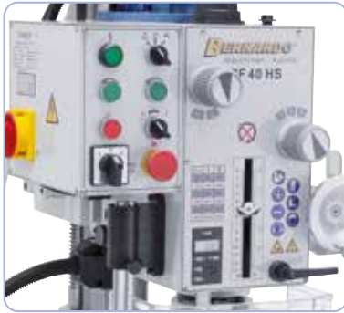
Selkeästi porapäähän asennetut kytkimet ja ohjaimet
