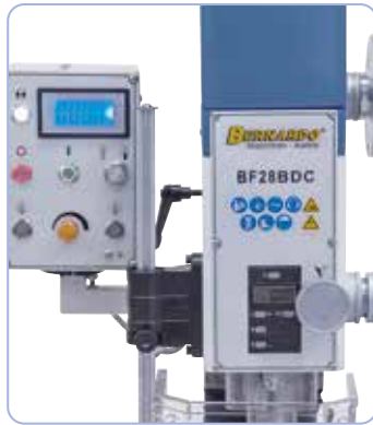
Toimitukseen sisältyy digitaalinen kierrosluvun ja poraussyvyyden näyttö
