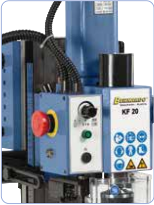
Mekaaninen kierrosluvun säätö ja portaattomasti säädettävä tasavirtamoottori
