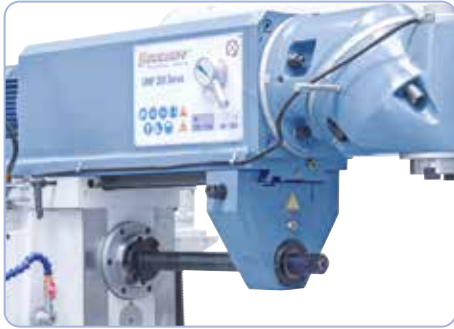
Vakiona vastalaakeri ja pitkä jyrsintuurna vaakajyrsintään
