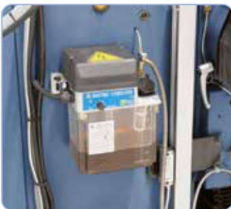
Sähköinen keskusvoitelu kaikille ohjainkiskoille ja karoille
