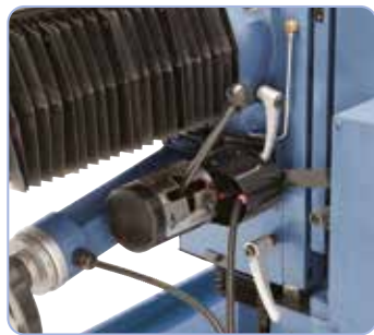
Syöttöakselin valintavipu (kuva x- ja z-akselille), syöttönopeuden säätö ohjauspaneelin potentiometrillä
