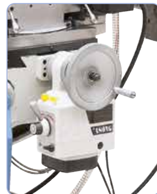
Vakiovarusteena portaaton syöttölaite y-akselille
