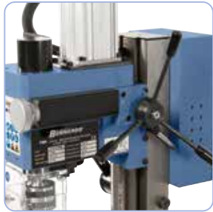
Suurikokoinen kiristysnuppi karan kevyeen säätämisen porauksen aikana, käsipyörä hienosäätöön jyrsinnän aikana.
