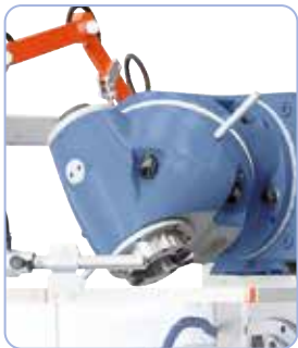
Yleisjyrsinpää, säädettävissä erilaisiin kulma-asentoihin.
