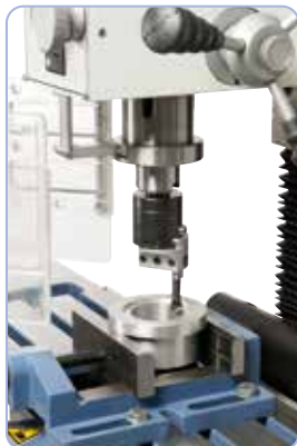
Haluttaessa kone voidaan varustaa avarruspöydällä.
