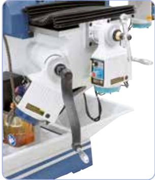
Vakiona portaaton syöttö x-, y- ja z
