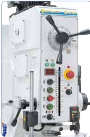
Vaivaton, motorisoitu pöydän korkeuden säätö.
