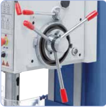
Kiristysnuppi karan manuaaliseen säätöön, kytkinvipu automaattista syöttöä varten.
