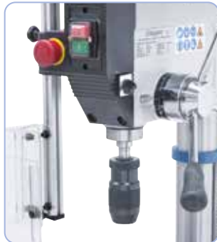
Vakiovarusteena pikaistukka 1 - 16 mm / B 16
