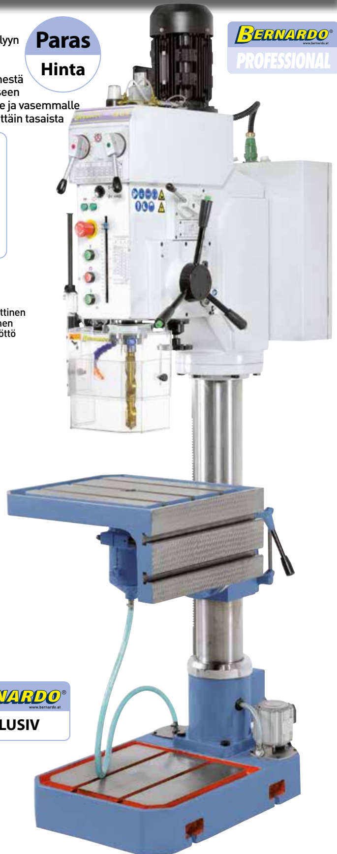
Massiivinen porapöytä, jota voidaan kiertää ja kääntää, sopii yleisiin kiinitystapoihin
