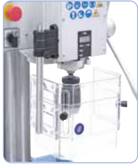
Turvallinen korkeussäädettävä karasuojuksen ja mikrokytkimen ansiosta.
