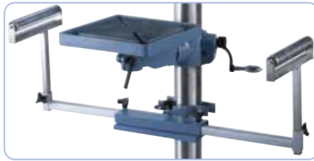
Koneeseen voidaan asentaa ulosvedettävä lisätuki pitkiä työkappaleita varten.
