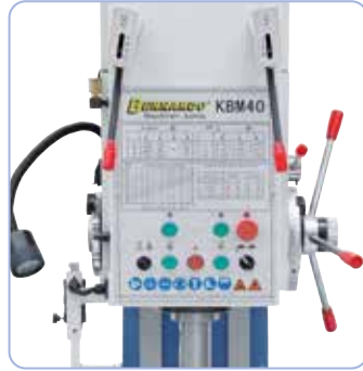
Selkeä porapää, johon on asennettu kaikki kytkimet ja ohjaimet.
