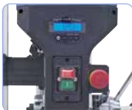
Digitaalinen poraussyvyyden näyttö lisää käyttömukavuutta
