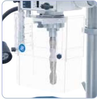
Suojuksessa CE-merkintä, säädettävissä kulloisenkin teränpituuden mukaan
