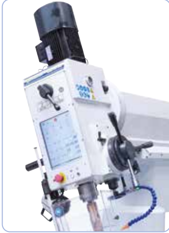
Laaja käyttöalue -90° - +90° kääntyvän porapään ansiosta
