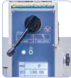
Helppo vaihdeportaan esivalinta välivaihteella. Haluttu kierrosluku säädetään ohjauspaneelista.
