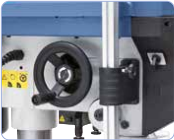
Sivulle asennettu käsipyörä halutun kierrosluvun säätämiseen.
