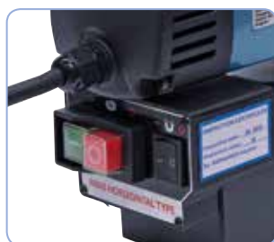
Kytkimet on järjestetty koneen takasivulle selkeästi siten, että kulloinkin tarvittava kytkin löytyy helposti.
