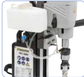
Automaattinen sisävoitelu, jäähdytysneste johdetaan suoraan kernaporan terään
