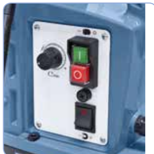
Leikkuunopeuden tarkka asettaminen potentiometrillä.
