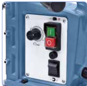
Leikkuunopeuden tarkka asettaminen potentiometrillä.
