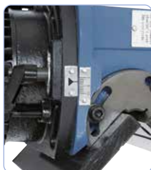
Ajuste sin herramienta de la altura del chaflán / profundidad de fresado
