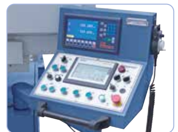
Disposición visible de los elementos de control en la consola giratoria
