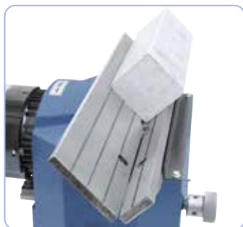
Guía de grandes dimensiones para una apoyo seguro de la pieza
