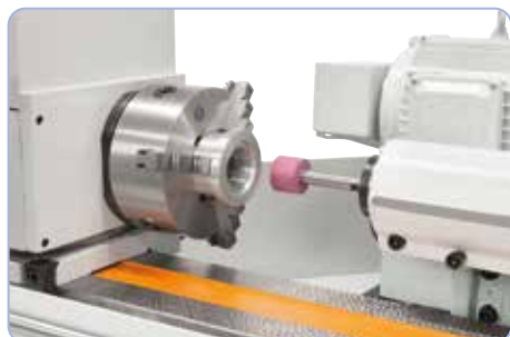
De serie con dispositivo de rectificado interior
