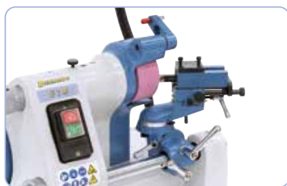
Asiento de la herramienta de torno
