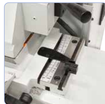
Puede girar la mesa para rectificado cónico entre +3 y -7°
