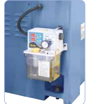
Lubricación automática para todas las guías y husillos
