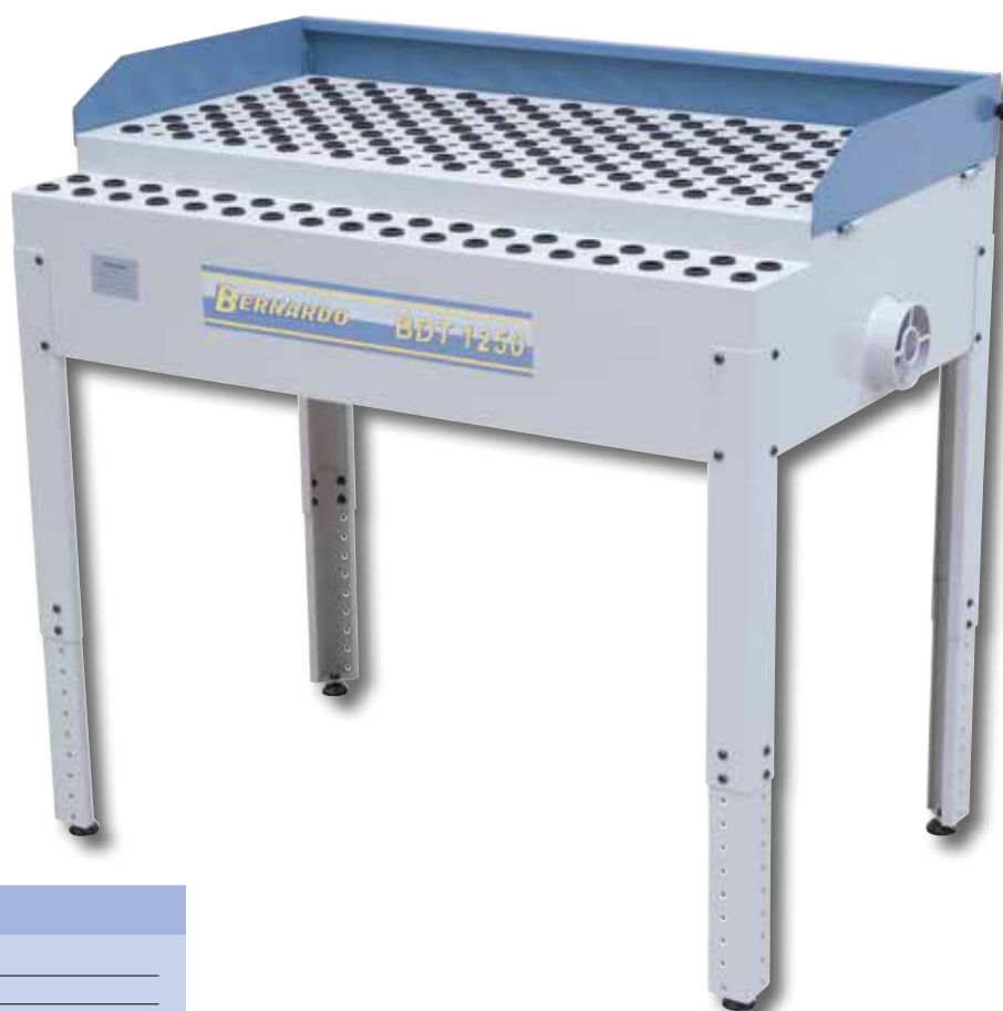
Fácil rectificado de cantos gracias a la superficie de mesa desplazada.
