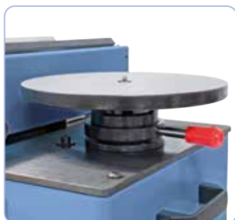
Ajuste rápido del ancho del chaflán durante el fresado de contornos con solo girar la plataforma giratoria.
