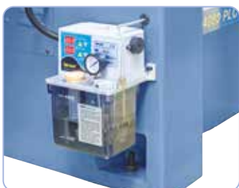
Lubricación central para las guías y los husillos
