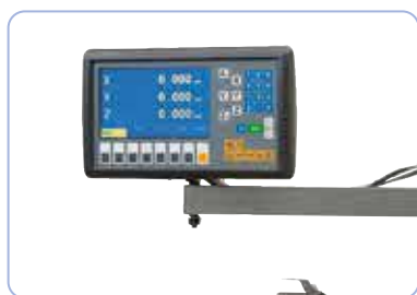
De serie viene equipada con visualizador de cotas en 2 ejes
