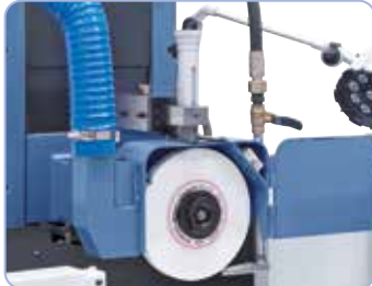
Dispositivo de diamantar con ajuste micrométrico incluido en el equipo base
