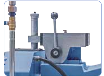
Dispositivo de diamantar con ajuste micrométrico incluido en el equipo base
