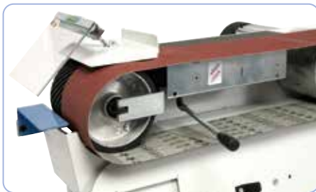
Disco de contacto de grandes dimensiones y tensión automática de la cinta
