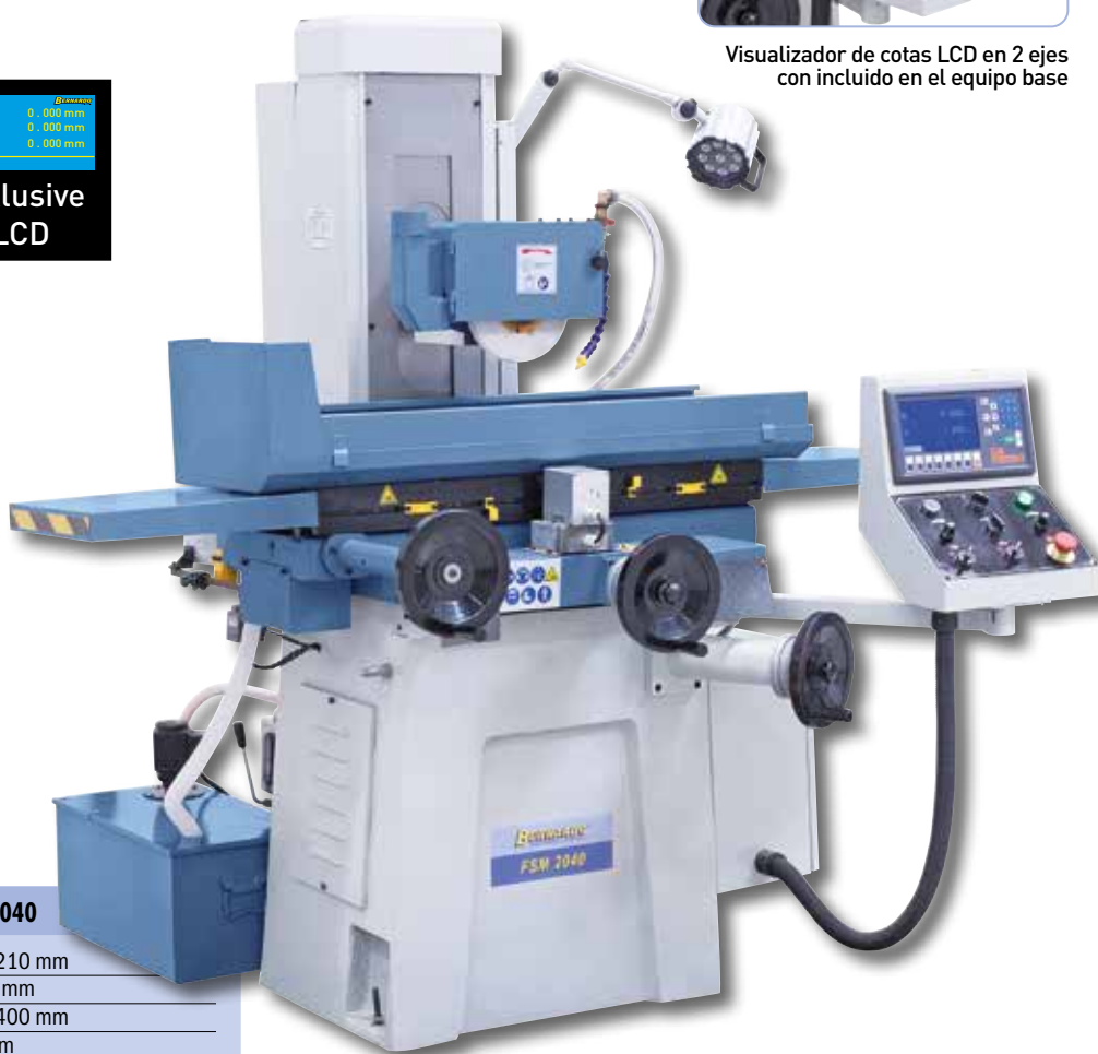
Visualizador de cotas digital en 2 ejes (X e Y)
