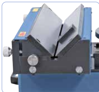
Fácil ajuste del ancho del chaflán gracias a la guía tope móvil.
