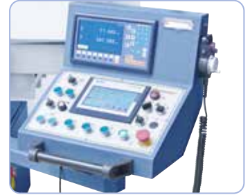
Panel Siemens SAMRT IE V3 con pantalla táctil y volante electrónico
