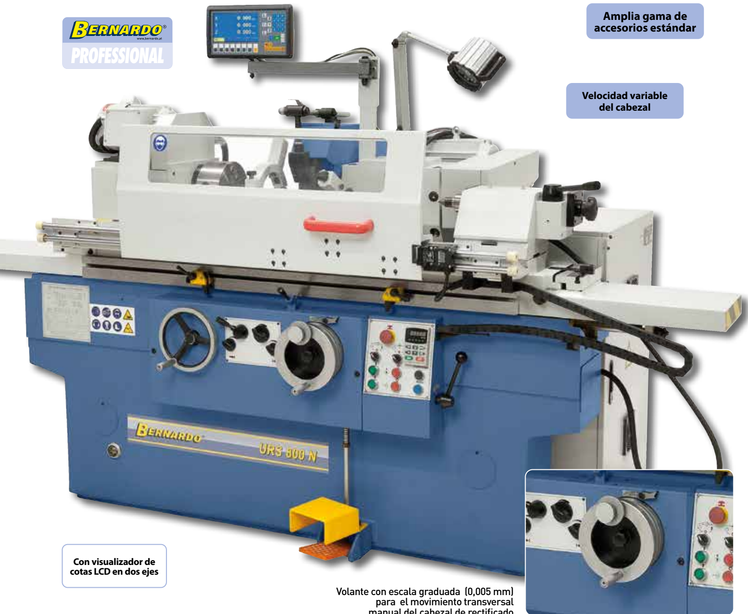
Cabezal giratorio entre 0° y 90° para rectificado cónico.
