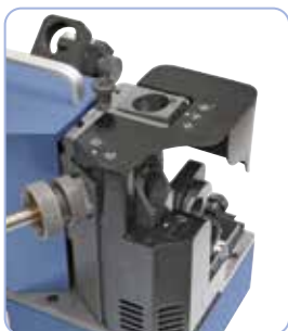
Afilado del ángulo de incidencia de fresas de 3 y 4 filos
