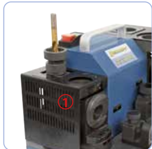
1. Rectificado en relieve del ángulo de incidencia Ø 2 - 13 mm 2. Rectificado en relieve del ángulo de incidencia Ø 8 - 32 mm
