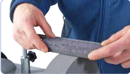
05-2050 afilador: sirve para preparar la muela de afilar (fina/gruesa)
