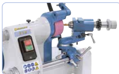
Asiento de la fresa cilíndrica frontal
