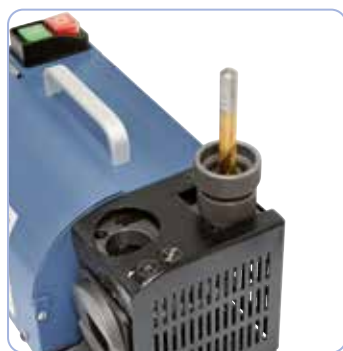
Rectificado en relieve del ángulo de incidencia
