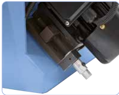
Ajuste continuo de la altura del bisel mediante tornillo
