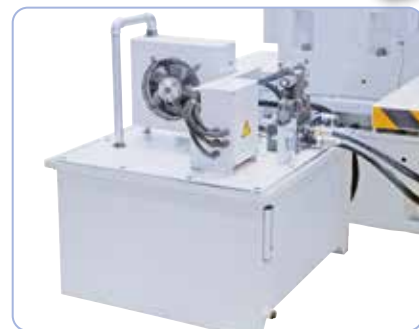
Unidad hidráulica individual con refrigeración por aceite, evita la vibración y la carga térmica en el cuerpo de la máquina
