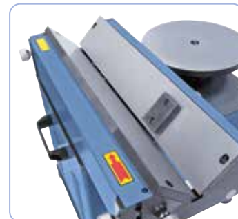
Guía rectificada con tope para de pieza.
