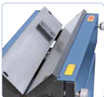
Guía rectificada con tope para de pieza.
