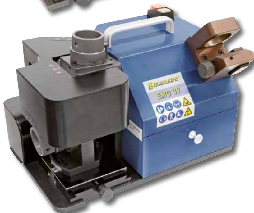
Afilado del ángulo de incidencia de fresas de 2 filos
