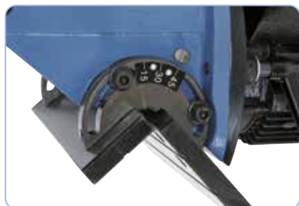
Ajuste continuo del ángulo de achaflanado de 15° a 45°
