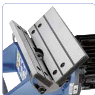
Ajuste sin herramienta de la altura del chaflán / profundidad de fresado
