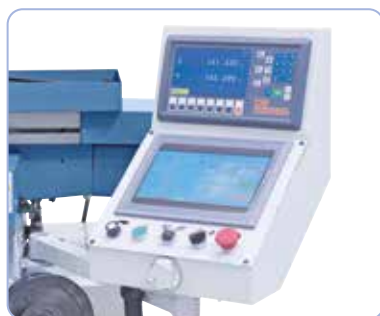
Control mediante pantalla táctil y volante electrónico.
