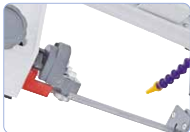
Guiado de la cinta de sierra con rodamientos a bolas para unos cortes precisos.
