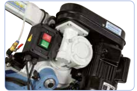
Mediante una correa trapezoidal puede cambiarse la velocidad de corte (24 / 41 / 61 / 82 m/min)
