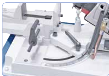
El arco de sierra giratorio puede realizar cortes a inglete y ajustarse de +45° a -60°.
