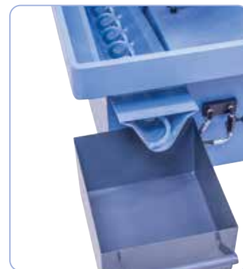
Equipada con cinta transportadora para virutas de serie.
