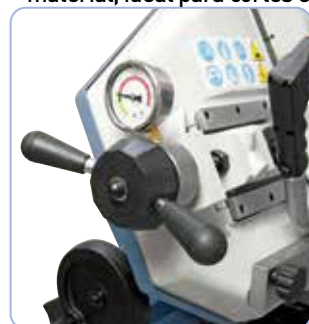
El manómetro de serie permite un ajuste óptimo de la tensión de la cinta de la sierra.
