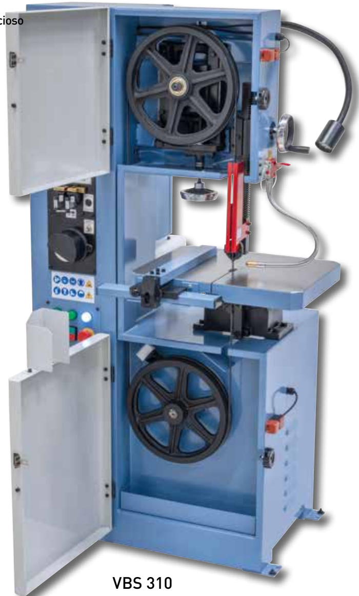
Microsistema de refrigeración y guía paralela incluidos
