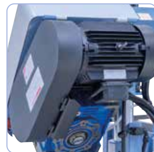
Transmisión por correa con 3 velocidades de corte ajustables.
