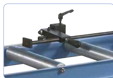
El tope de pieza puede escamotarse hacia arriba en cualquier momento
