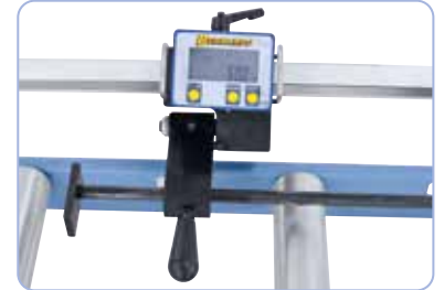
Sistema de medición de longitud LS, opcional para RB 4 / 7 / 10
