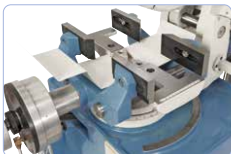
Mordaza de amarre rápido neumática para acortar los tiempos de sujeción
