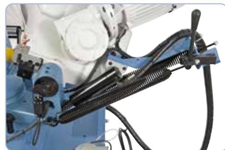
Muelle con palanca que permite cambiar a modo manual
