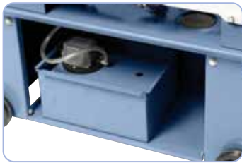
Potente dispositivo de refrigeración, se integra en el banco de la máquina para reducir espacio.
