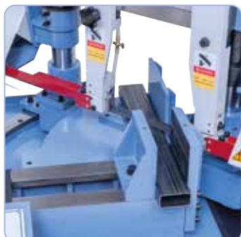
Arco de sierra inclinable para efectuar cortes en inglete de 90° a 45°
