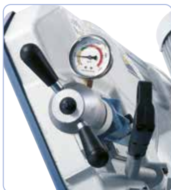
Control de la tensión de la cinta de la sierra mediante manómetro.
