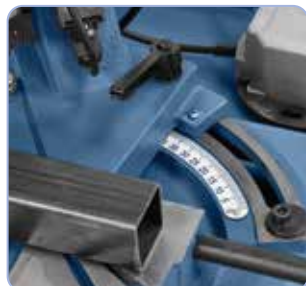
Arco de sierra giratorio para corte a inglete hasta 60°.
