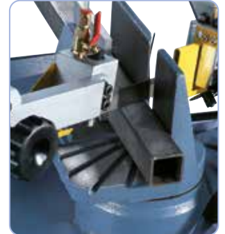
El arco de sierra puede girarse en los cortes a inglete de 90° a 60°.
