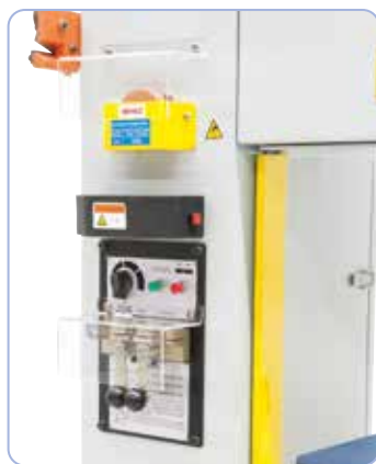
Incluye dispositivo para soldar, cortar y afilar la cinta de sierra.
