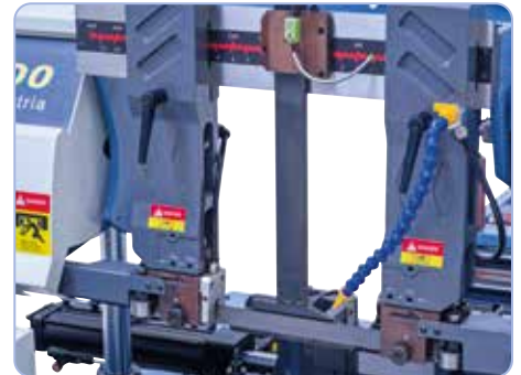
El guiado de cinta de sierra ajustable evita que la cinta de la sierra se desplace lateralmente o se incline.
