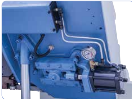
Con sujeción hidráulica de la cinta de sierra de serie (NC Pro)
