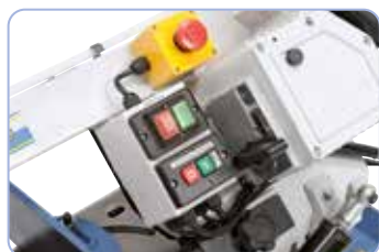
Disposición centralizada de los elementos de mando en el arco de sierra
