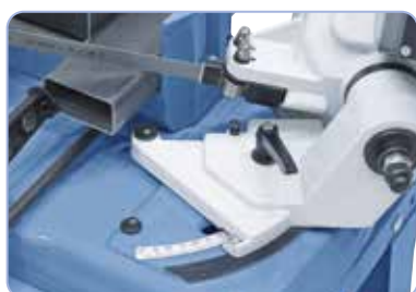
Brazo de sierra con dispositivo de bloqueo para un mejor manejo durante el transporte
