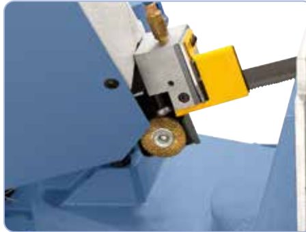
Guiado de la cinta mediante un sistema combinado de rodillos y piezas de carburo.
