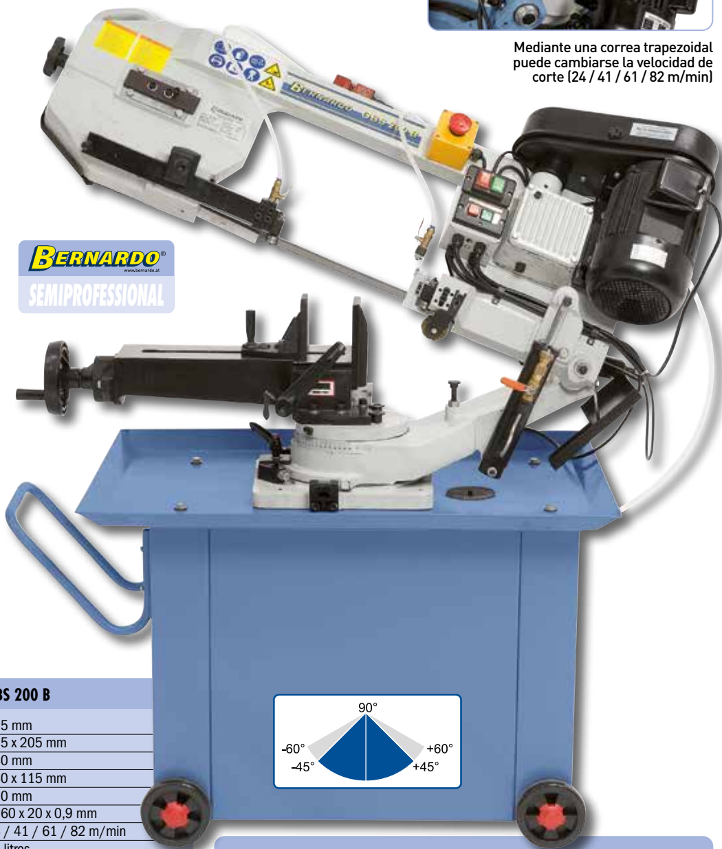
Disposición centralizada de los elementos de mando en el arco de sierra
