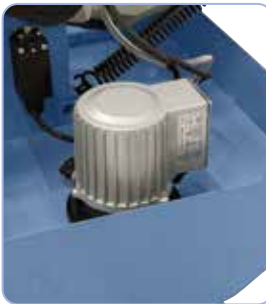
Potente bomba de refrigeración incluida en el equipo base
