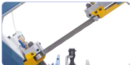
Guiado de la cinta de sierra con rodamientos a bolas para unos cortes precisos.
