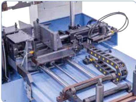
Avance de material mediante dispositivo de sujeción hidráulico y guía redonda de precisión
