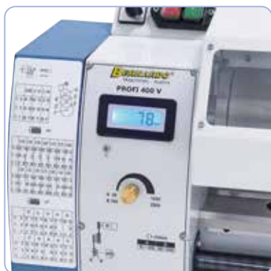
Regulación electrónica de las revoluciones
