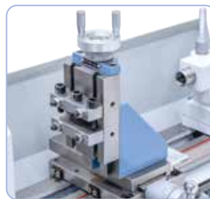
Soporte de fresado vertical adaptable a posteriori para mecanizados adicionales.
