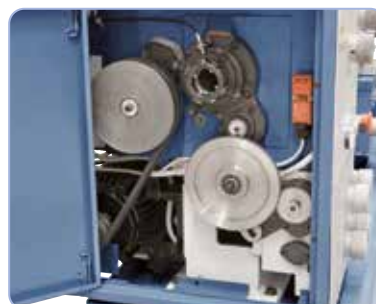
Broca principal templada, elevada precisión de concentricidad del talón del husillo ( \leq 0,009 mm) debido a rodamientos de conos de alta precisión.
