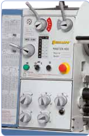
Botones colocados de forma visible en el cabezal, las ruedas dentadas templadas y rectificadas garantizan un funcionamiento silencioso.
