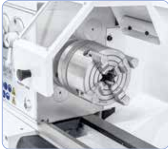
Opcional: Plato de 4 garras independientes de 100 mm para el amarre de piezas asimétricas.
