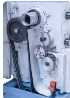
Husillo principal templado con rodamientos cónicos de alta precisión para una elevada concentricidad: una transmisión óptima de la potencia mediante correas trapecoidales dentadas Optibelt
