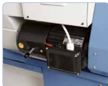
Potente motor principal con freno magnético conforme a la normativa de la CE
