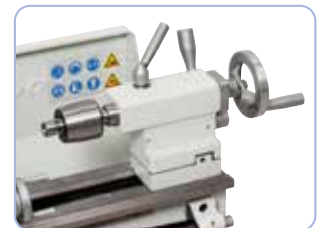
Opcional: punto giratorio tipo SMA con 7 puntas intercambiables
