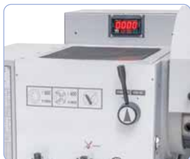
Regulación electrónica de las revoluciones, fácil lectura mediante visualizador digital.
