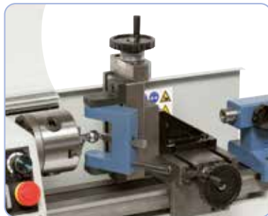
Soporte de fresado vertical con dispositivo para el mecanizado de bolas (opcional)
