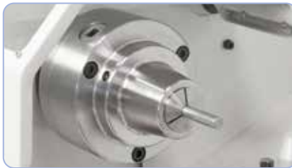
Opcional: Portapinzas tipo 5C, capacidad de sujeción de 3 a 26 mm
