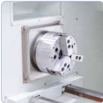
Plato hidráulico de 3 garras, diám. 200 mm
