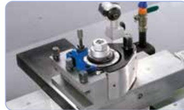
El portaherramientas de cambio rápido con sistema Multifix permite una reducción de tiempos muertos y garantiza una alta precisión de repetición.
