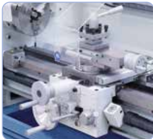
Palanca de embrague dispuesta de forma ergonómica para acoplar el avance longitudinal o transversal
