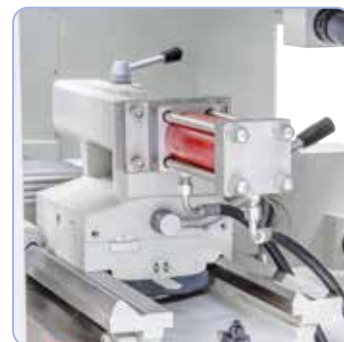
Con ajuste hidráulico de la caña del contrapunto de serie.
