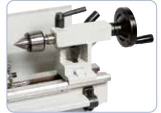
El contrapunto con CM 2 puede desplazarse para torneados cónicos
