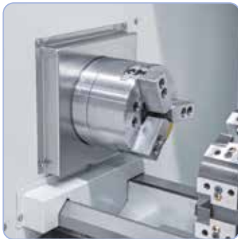
Plato hidráulico de 3 garras, diám. 200 mm
