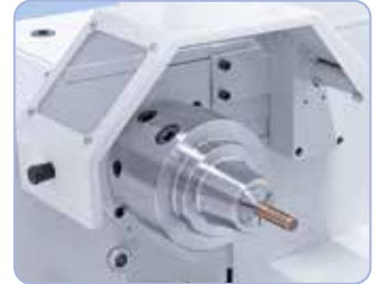
Opcional: portapinzas 5C, capacidad de sujeción 3 - 26 mm
