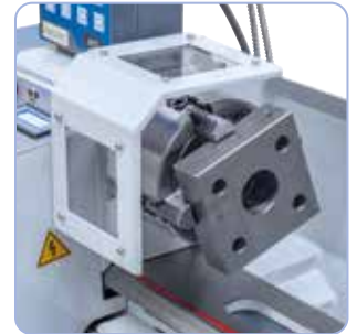
Plato de 4 garras independientes de 100 mm (opcional) para sujetar piezas de trabajo con formas irregulares.
