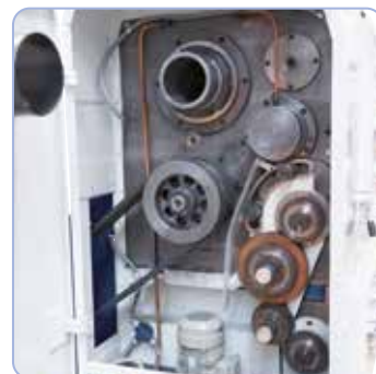
La cabezal templado con paso de barra de 130 mm está montado sobre rodamientos de rodillos cónicos y rodamientos de rodillos radiales.
