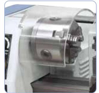
Plato de 3 garras de diámetro 80mm con protección según normativa CE
