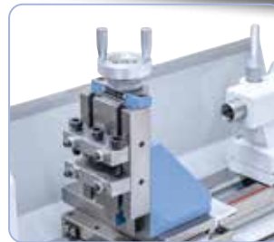
Soporte de fresado vertical adaptable a posteriori para mecanizados adicionales.
