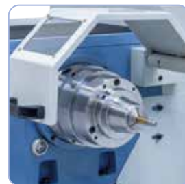
Opcional: Portapinzas tipo 5C, capacidad de sujeción de 3 a 26 mm
