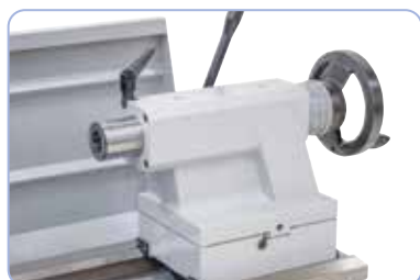
El robusto contrapunto CM 4 se puede desplazar lateralmente para torneado cónico.
