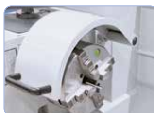
Plato de 4 garras autocentrante de 160 mm, para sujetar piezas cuadradas (opcional)
