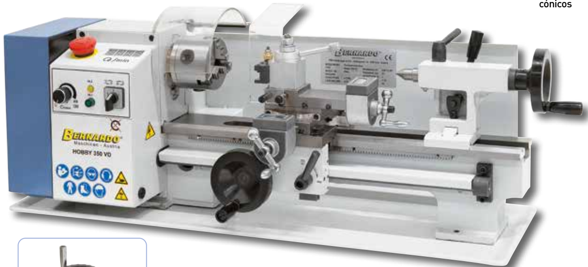
El contrapunto con CM 2 puede desplazarse para torneados cónicos
