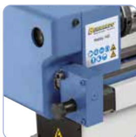
Opcional: avance automático en el eje Z
