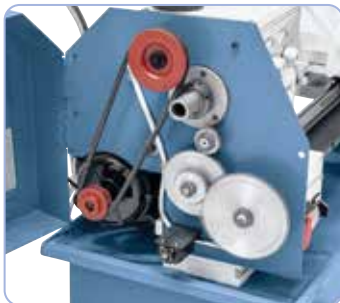
De serie equipado con engranajes de cambio para roscado.
