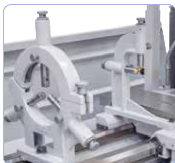
Luneta fija y móvil de serie para la sujeción de piezas de trabajo
