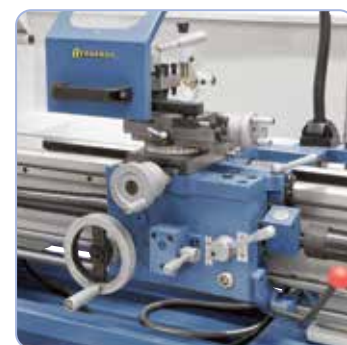
Movimiento suave y preciso del delantal con carro superior y portaherramientas de 4 posiciones, volantes con nonius de escala muy precisa.
