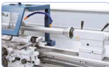
Punto giratorio diam. 100 mm. Ideal para sujetar tubos y piezas huecas (opcional)
