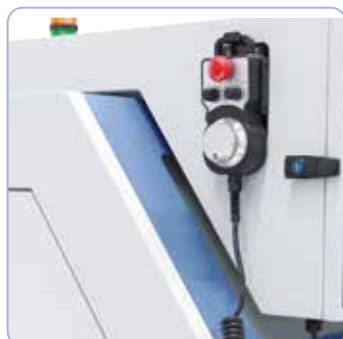
Con volante electrónico incluido
