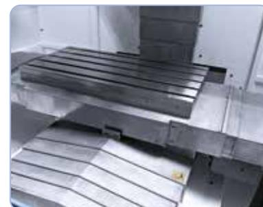
Mesa de trabajo rectificada con precisión con protector telescópico en todos los ejes.
