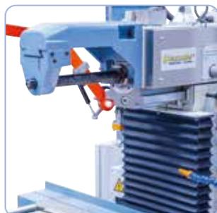
Para el fresado horizontal se incluye el soporte y el eje portafresas
