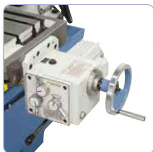
El eje X tiene 8 avances automáticos (24 - 720 mm/min)
