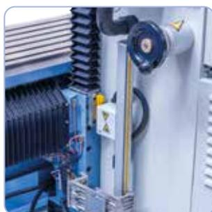
De serie con volantes electrónicos para desplazamiento manual en los ejes X, Y y Z.
