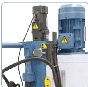
De serie incluye un motor de elevación para el ajuste en altura del cabezal
