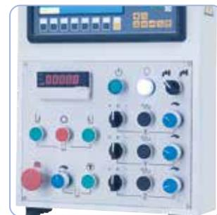
Ajuste rápido y fácil de la velocidad de avance deseada directamente en el panel de operación.
