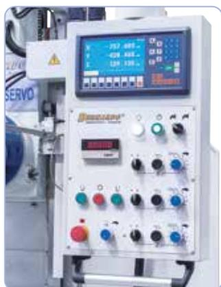
Ajuste rápido y fácil de la velocidad de avance deseada directamente en el panel de operación.
