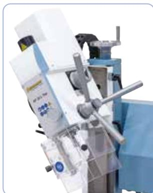
Cabezal inclinable a ambos lados +/-90°
