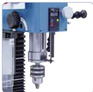
Cabezal sólidamente diseñado con rodamientos cónicos, con indicador digital de profundidad de serie.
