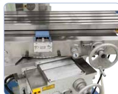
Mayor comodidad de manejo gracias al volante para el eje X montado en el frontal de la mesa
