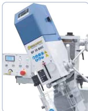
Cabezal inclinable a ambos lados +/-90°
