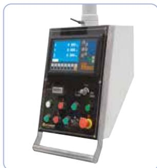
Panel de control flotante para un sencillo uso. El visualizador de cotas es parte del equipo base.
