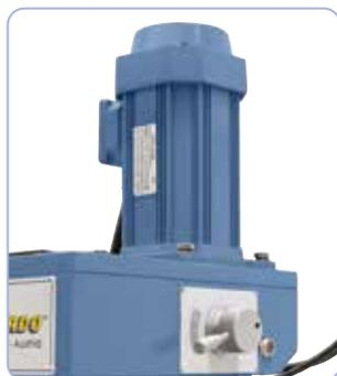
Preselección fácil de la marcha mediante engranaje intermedio. Ajuste de las revoluciones mediante potenciómetro.
