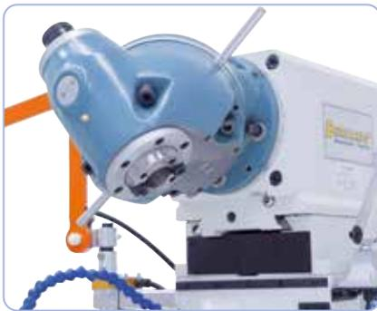
Cabezal portafresas universal ajustable en diferentes ángulos
