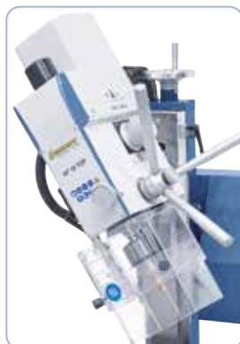
Cabezal inclinable a ambos lados +/-90°
