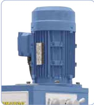
Potente motor para garantizar un óptimo resultado de trabajo. La selección de revoluciones se realiza mediante cambio de engranajes
