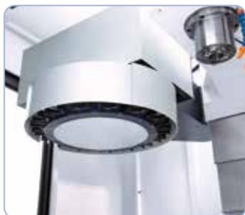
Cambiador automático de 16 herramientas con cambio rápido.
