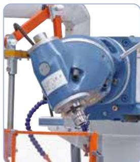
Cabezal portafresas universal ajustable en diferentes ángulos
