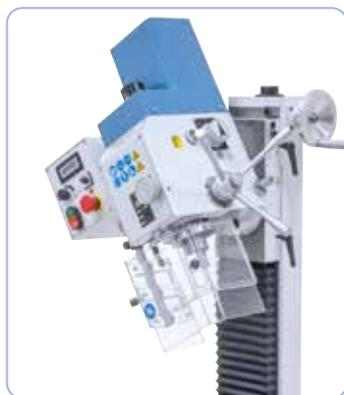
Cabezal inclinable a ambos lados +/-90°
