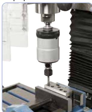
Para roscado la máquina se puede equipar con un aparato de roscar de M5-M12.
