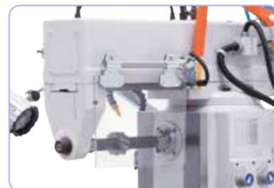
Para el fresado horizontal se incluye el soporte y el eje portafresas
