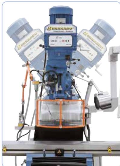
Cabezal inclinable de  $-90^{\circ}$  a  $+90^{\circ}$  que permite numerosas tareas
