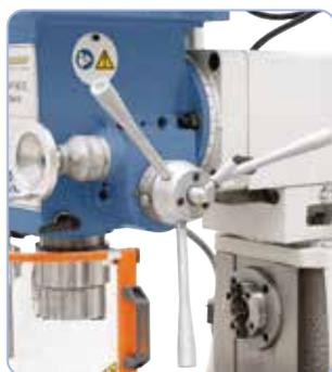
Ajuste de la pinola mediante manija, ajuste de precisión mediante volante.
