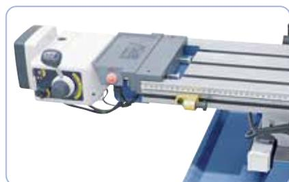
Avance automático AL 450 D regulable para un cómodo mecanizado (Art. nº 02-1117)
