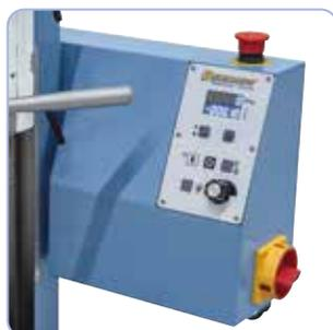
Uso fácil mediante teclado de membrana. Indicadores de revoluciones y de profundidad de taladrado digitales incluidos en la entrega
