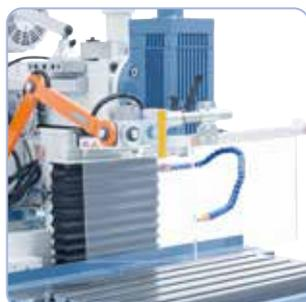
Dispositivo de protección ajustable, apto para trabajos de fresado verticales y horizontales.
