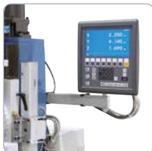
Mediante el indicador de posición en 3 ejes se consigue un incremento de la productividad del 50 %
