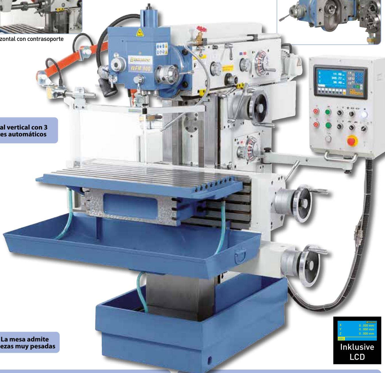
Cabezal vertical con 3 avances automáticos
