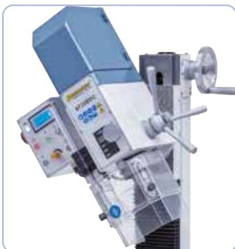
Cabezal inclinable a ambos lados +/-90°
