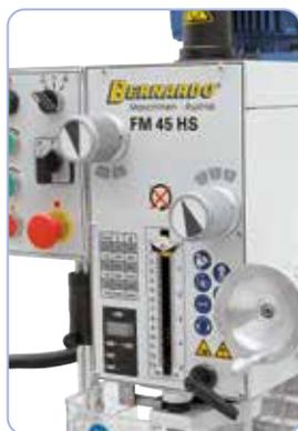
El cambio de revoluciones se consigue mediante un rápido cambio de engranajes
