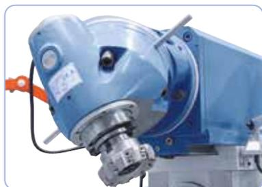
Mediante el ajuste de 90° y 45° la cabeza inclinable universal se puede colocar en cualquier ángulo.
