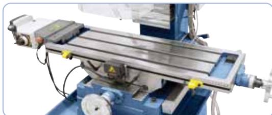
De serie se incluye el avance automático de la mesa en el eje X con función de marcha rápida
