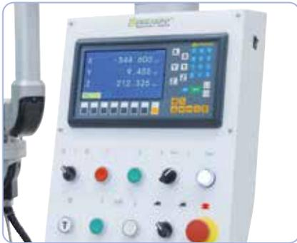
Visualizador de cotas en 3 ejes para reducir los tiempos de fabricación
