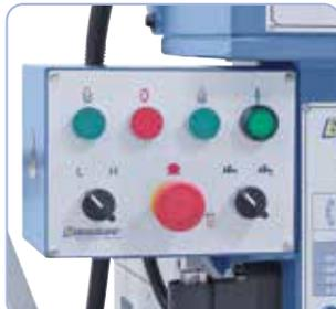
Disposición centralizada de los elementos eléctricos en el cabezal portafresas
