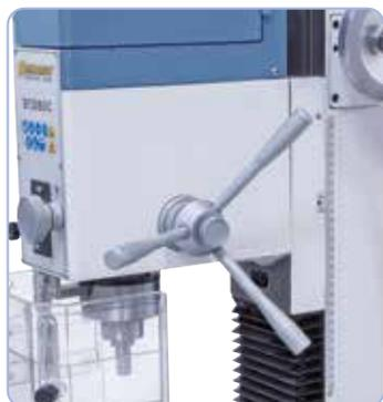
Grandes manetas para el movimiento de la pínola. Volante con nonius para ajuste fino.
