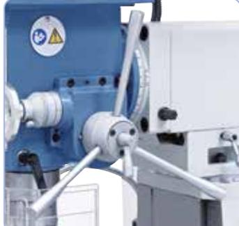
Grandes manetas para el movimiento de la pínola. Volante con nonius para ajuste fino.
