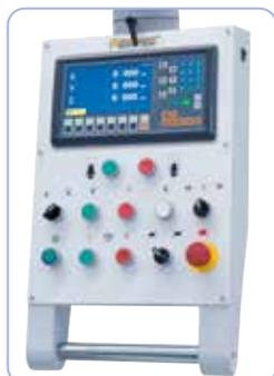
Panel de control flotante para un sencillo uso. El visualizador de cotas es parte del equipo base.
