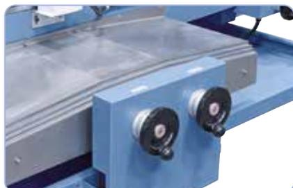
De serie con volantes electrónicos para desplazamiento manual en los ejes X, Y y Z.
