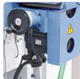
De serie con volantes electrónicos para desplazamiento manual y 3 potentes servomotores para los ejes X, Y y Z.
