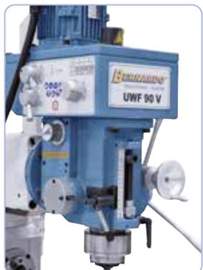
La maquina viene equipada de serie con avance automático de la pinola (0,08 / 0,15 / 0,25 mm/r).
