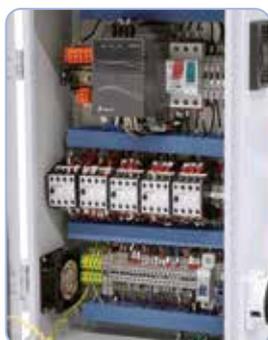
Mediante el convertidor de frecuencia se pueden ajustar las revoluciones de forma continua
