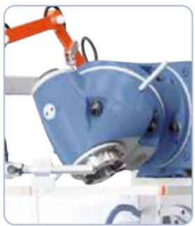
Cabezal portafresas universal ajustable para diferentes ángulos.
