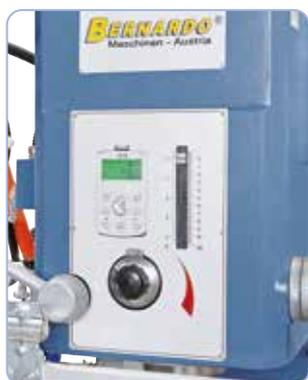
Revoluciones regulables de forma continua mediante convertidor de frecuencia.
