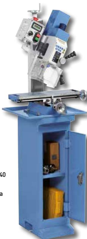
Ilustración con banco armario BF 1 (opcional) y cabezal inclinado
