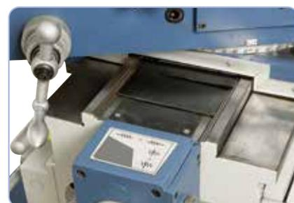
La UWF 150 es una fresadora universal sólidamente construida, con un brazo móvil y una gran zona de amarre. Las guías están sobredimensionadas en todos los ejes y garantizan una estabilidad y precisión absolutas
