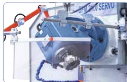
Mediante el ajuste de 90° y 45° la cabeza inclinable universal se puede colocar en cualquier ángulo.
