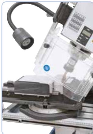
Con el cabezal de engranaje ajustable se pueden realizar trabajos de fresado en planos horizontales, verticales y en diagonal.
