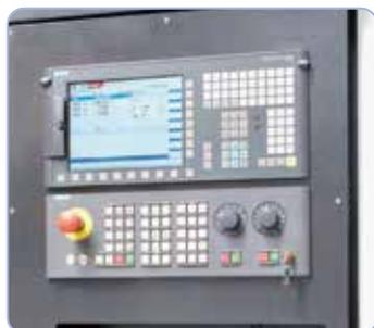
Con control Siemens Sinumerik 828D, pantalla a color LCD para una alta eficiencia y fácil manejo.
