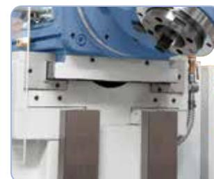
El diseño de la guía cuadrada de los ejes Y y Z garantiza un alto grado de estabilidad (FU 1600/FU 2000)
