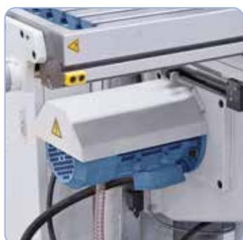
Incluye motor de posicionamiento para la mesa de fresado en el eje z
