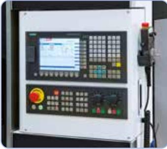
Con control Siemens Sinumerik 808D Advanced, pantalla a color LCD para una alta eficiencia y fácil manejo.
