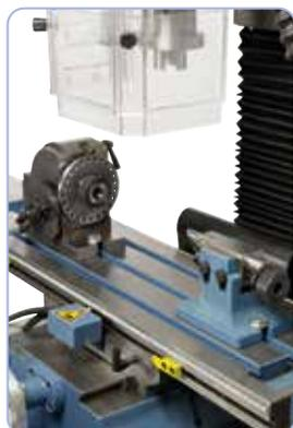
Aparato divisor semi-universal BS-0: óptima para el mecanizado de ejes
