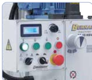
Sencilla selección de la gama de velocidades mediante palanca. Variación de revoluciones por potenciómetro.
