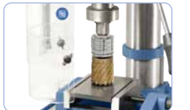
Equipo de cambio rápido opcional para utilizar barrenas sacanúcleos
