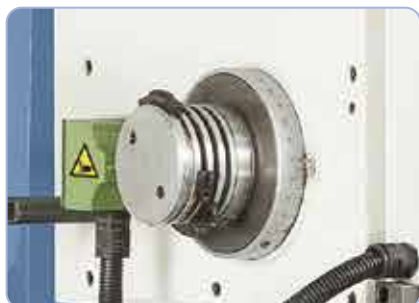
Mecanismo para roscar con avance rápido / avance de trabajo y retroceso rápido (de KBM 63).
