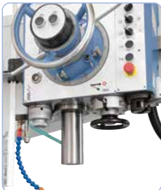
El ajuste de las revoluciones y del avance se realiza desde la parte inferior del cabezal.
