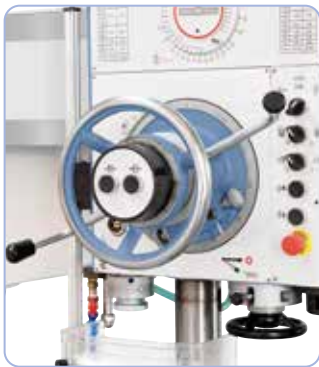
Elementos de operación a la vista. La fijación del cabezal de taladrar se realiza con el volante.
