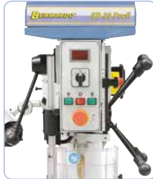
De serie equipada con regulación digital de revoluciones. Elementos de conmutación y de operación dispuestos de forma ergonómica en la parte frontal.
