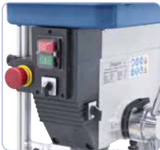
Botón de parada de emergencia, botón de dirección giratorio y botón de 2 niveles en la parte frontal de la máquina.
