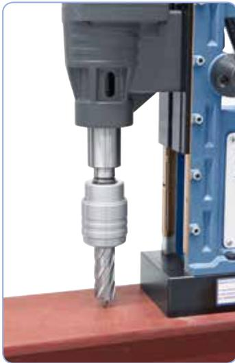
Perforación con barrena sacanúcleos con cambio rápido
