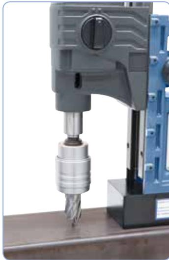
Perforación con barrena sacanúcleos con cambio rápido
