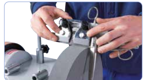
05-2055 Sciccors jig: Ideal for sciccors or secateurs
