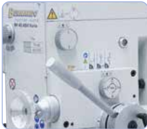
Spindle feed can be set to 0,10 / 0,18 or 0,26 mm/rev.
