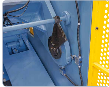
Schnittspaltverstellung - einfaches und schnelles Einstellen auf die gewünschte Blechdicke.
