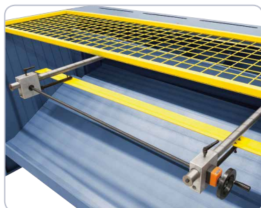
Robuster Hinteranschlag, einstellbar mittels Handrad.
