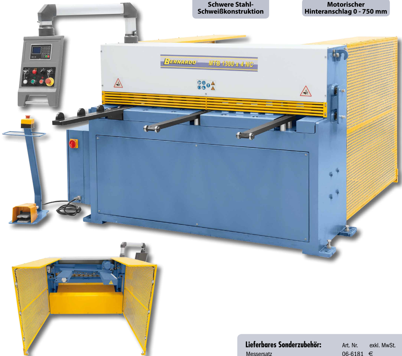
Integrierte Steuerung NC 10 im Bedienpult, serienmäßig mit Speicherfunktion
