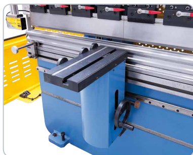
2 verschiebbare, höhenverstellbare Auflagearme mit T-Nut und Skala, verschiebbar auf einer Linearführung.
