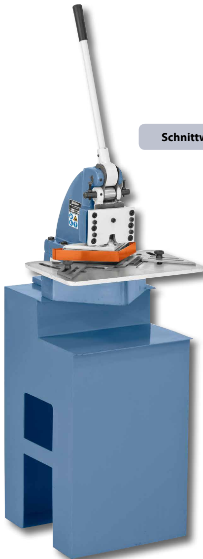
Mechanische Kraftübertragung mittels Exzenter.
