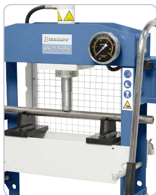
Erhöhte Sicherheit durch optional erhältliches Schutzgitter GG-02.
