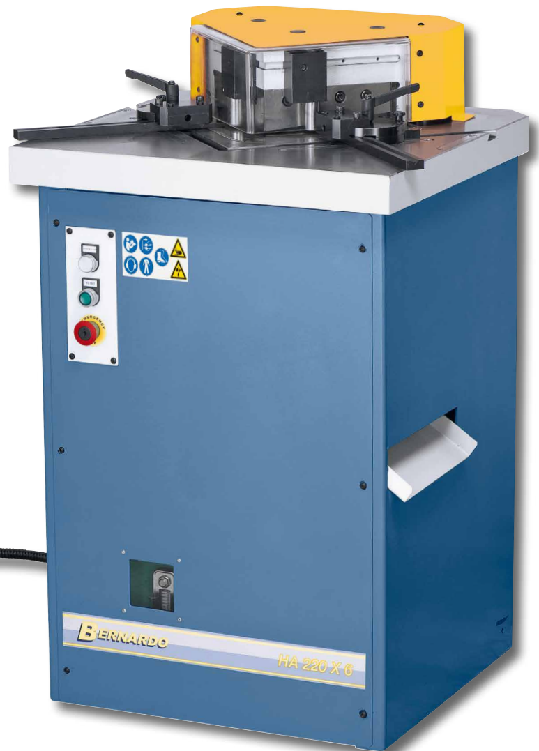
Schutzabdeckung aus Plexiglas, daher optimale Sicht auf die Schnittkante.
