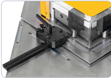
Die-T-Nuten im Arbeitstisch sorgen für eine präzise Führung der Anschläge.
