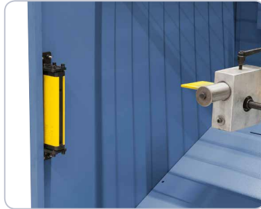
Durch die serienmäßige Lichtschranke wird ein Eingreifen in die laufende Maschine verhindert.
