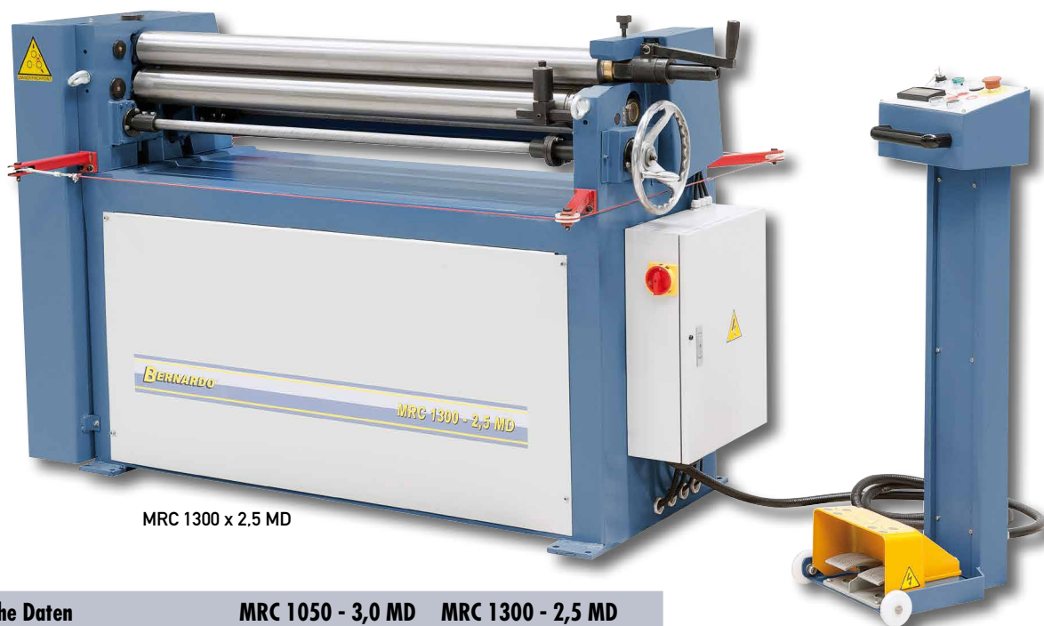
Zustellung der Unterwalze mittels Handrad, Oberwalze nach vorne ausschwenkbar.
