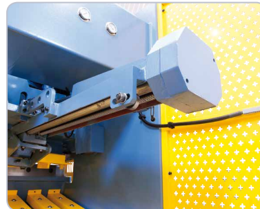
Hinteranschlag serienmäßig mit Kugelumlaufspindeln für erhöhte Genauigkeit.
