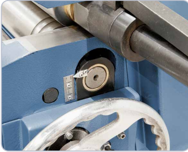
Exaktes Zustellen der Unterwalze mittels Skala.
