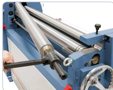
Zustellung der Unterwalze mittels Handrad, Oberwalze nach vorne ausschwenkbar.
