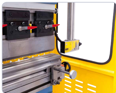
Berührungsloses, mitfahrendes, laseroptisches Sicherheitssystem Fissler AKAS-LC II.
