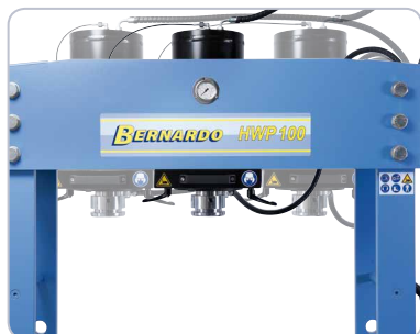
Seitlich verschiebbarer Kolben für universellen Einsatz (ausser HWP 30).
