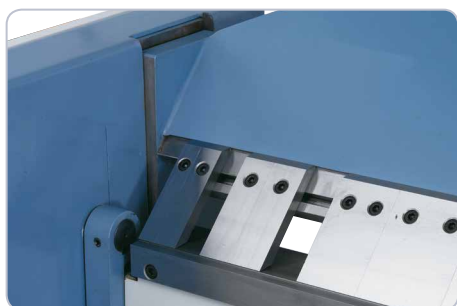
Die herausnehmbaren Segmente ermöglichen eine Vielzahl von Biegemöglichkeiten.
