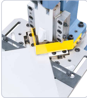
Einstellbare Anschläge mit Skalen, ideal für Serienarbeiten
