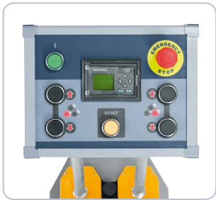
Inklusive Digitalanzeige zum Einstellen der unteren Walzen.
