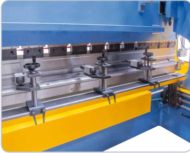
3 Stk. höhenverstellbare Hinteranschlagfingern, seitlich über Linearführung verstellbar
