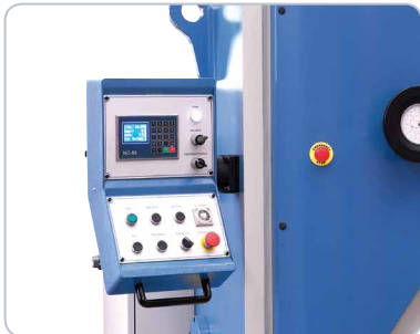
Integrierte Steuerung NC-89 im Bedienpult, serienmäßig mit Speicherfunktion
