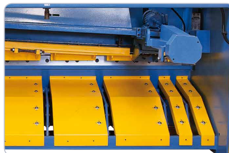
Die pneumatische Blechhochhaltevorrichtung (Standard) verhindert ein Durchbiegen von Dünnscheiben und gewährleistet daher einen exakten Schnitt.
