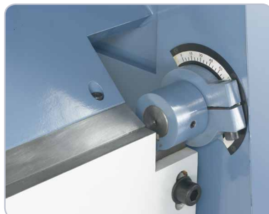
Das Einstellen des gewünschten Biegewinkels erfolgt mittels Skala.
