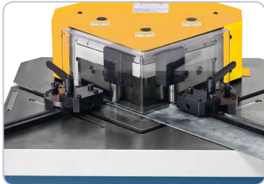
Die-T-Nuten im Arbeitstisch sorgen für eine präzise Führung der Anschläge.
