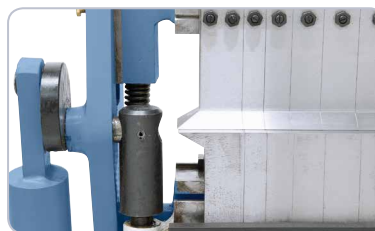
Das Anheben der Oberwange erfolgt über einen Exzenter.
