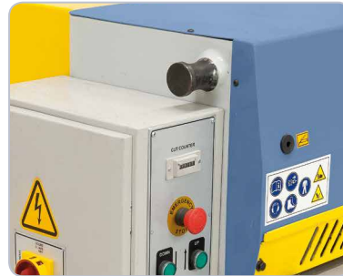
Serienmäßig ausgestattet mit einem Schnittzähler.
