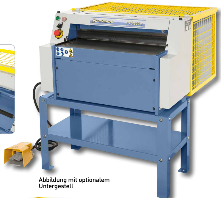
Von 0 - 500 mm einstellbare Hinteranschlag, ideal für Serienarbeiten.
