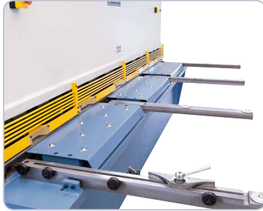
Vordere Blechauflagen mit integrierten Rollen zum Bearbeiten großformatiger Bleche
