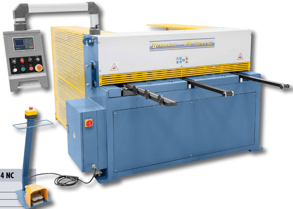
Leichtes Einstellen des Schnittspaltes auf die jeweilige Blechstärke an der Rückseite der Maschine.
