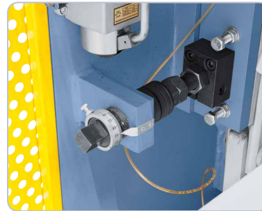
Leichtes Einstellen des Schnittspaltes auf die jeweilige Blechstärke an der Rückseite der Maschine.
