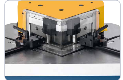
Schutzabdeckung aus Plexiglas, daher optimale Sicht auf die Schnittkante.
