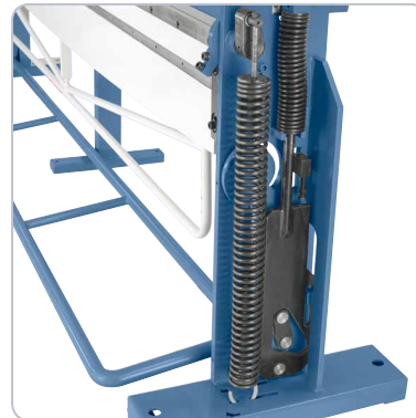
Serienmäßig mit Zugfeder zur Unterstützung beim Biegevorgang.
