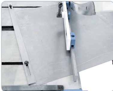
Präzise Arbeitsergebnisse durch Tischanschlag und Niederhalter.
