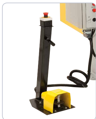
Bedienung mittels Fußpedal, daher beide Hände frei für das Werkstück.
