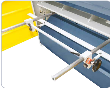
Serienmäßig mit Hinteranschlag, ideal für Serienarbeiten.
