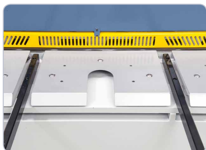
Einfaches Handling großer Werkstücke durch zusätzliche Auflagearme und Rollen in der Tischauflagefläche.
