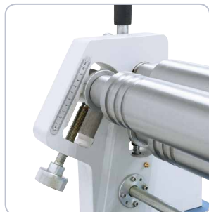
Exaktes Einstellen der Hinterwalze mittels Skala.
