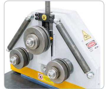
Die seitlichen Richtrollen können stufenlos auf das jeweilige Profil eingestellt werden.
