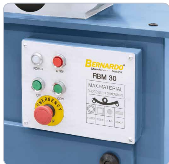
Übersichtlich angeordnete Bedienelemente an der Vorderseite.
