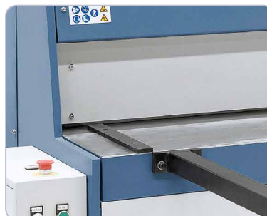
Exaktes, rechtwinkeliges Einstellen mittels seitlichem Anschlag.
