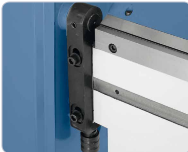
Manuelles Einstellen der gewünschten Blechstärke mittels Rändelschrauben.
