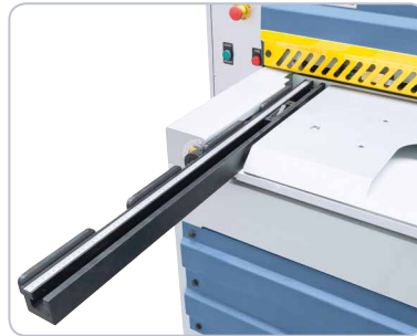
Seitliches Anschlaglineal mit Skala, Kippnocke und T-Nut.
