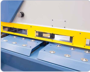
Tischauflagefläche mit integrierten Rollen, ideal für große Werkstücke.
