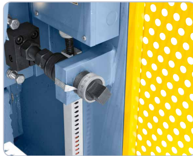
Leichtes Einstellen des Schnittspaltes auf die jeweilige Blechstärke an der Rückseite der Maschine.
