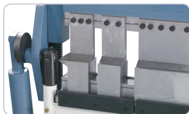
Segmentierte Ober-, Unter- und Biegewange für eine große Anzahl von Biegemöglichkeiten.
