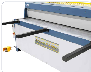
Die Auflagearme erleichtern das Bearbeiten großformatiger Bleche.
