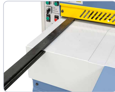
Exaktes Einstellen der Werkstücke durch seitliches Anschlaglineal.
