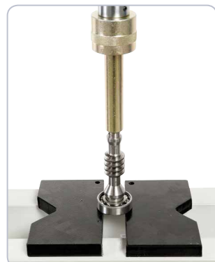
Erweiterter Einsatzbereich durch das optional erhältliche Druckdornset.
