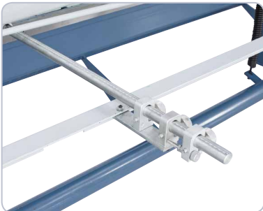
Der Hinteranschlag mit Feineinstellung ist optimal für Serienarbeiten.
