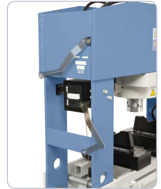
Serienmäßig mit Kurbel zum Verstellen des Zylinders (links / rechts) bzw. zur Höhenverstellung des Auflagetisches.
