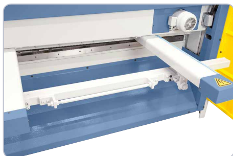
Das Einstellen des Hinteranschlages erfolgt schnell und einfach mittels Motor.
