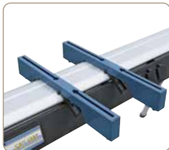
Die verschiebbaren Klemmschienen sind schnell und einfach auf die Maschinenbreite einstellbar.
