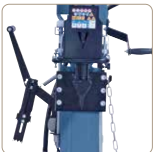
Sicheres Arbeiten durch Zweihandbedienung, Vorlaufgeschwindigkeit wahlweise schnell oder langsam.
