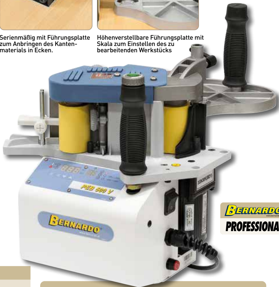
Das einstellbare Führungssystem erlaubt die Verwendung von Kantenstärken von 0,3 – 3,0 mm und Kantenhöhen von 10 – 65 mm
