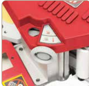
Die zugeführte Leimmenge kann über einen Drehknopf exakt eingestellt werden.
