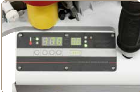
Übersichtliches Bedienpaneel, Bedienung über Folientastatur.
