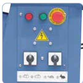
1. Wahlschalter für Rohrschleifen bzw. Bandschleifen 2. Wahlschalter für Drehzahlregelung
