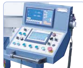
Siemens SMART-Panel IE V3 mit Touch-Bedienung und elektronisches Handrad.
