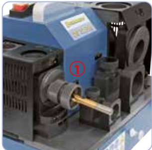
1. Schleifen des Spitzenwinkels \varnothing 2 - 13 mm 2. Schleifen des Spitzenwinkels \varnothing 8 - 32 mm
