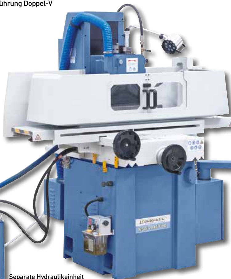
Separate Hydraulikeinheit vermeidet Vibrationen und thermische Belastung
