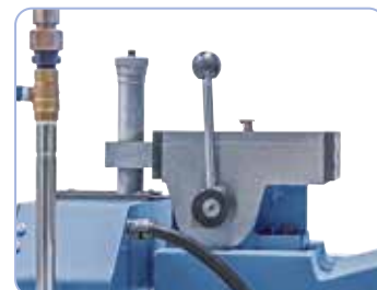
Manuelle Parallelabziehvorrichtung im Lieferumfang enthalten
