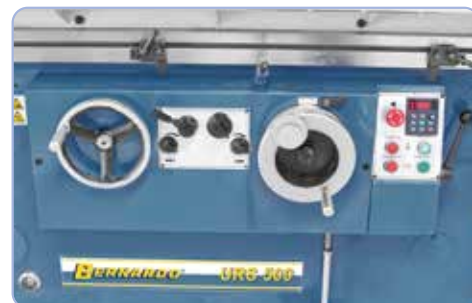
Die wichtigsten Bedienelemente sind übersichtlich an der Vorderseite der Maschine angeordnet
