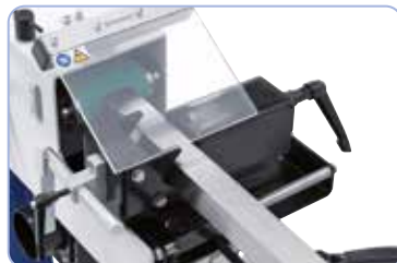
Kombinierter Schraubstock zum Spannen von Rohren und Profilen
