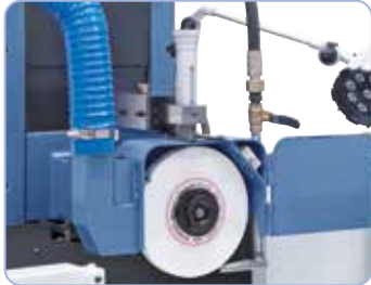
Manuelle Parallelabziehvorrichtung mit Mikrometerverstellung im Lieferumfang enthalten
