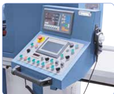
Inklusive Siemens SMART-Panel IE V3 mit Touch-Bedienung und elektronisches Handrad.
