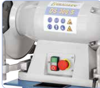
Ein-Ausschalter mit Unterspannungsauslöser und Not-Aus-Schlagschalter
