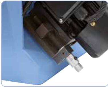
Stufenloses Einstellen der Fasenhöhe mittels Einstellschraube
