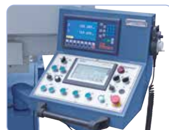
Übersichtliche Anordnung der Schaltelemente am schwenkbaren Bedienpult
