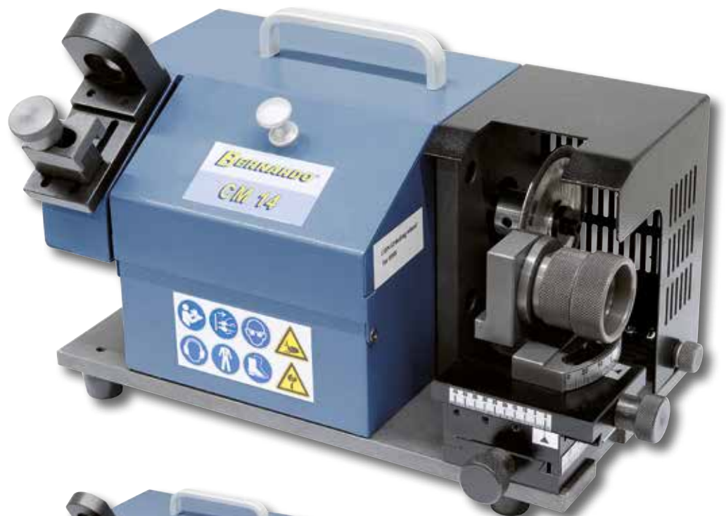
ER 20 Spannzangen von 4 - 14 mm im Lieferumfang enthalten.
