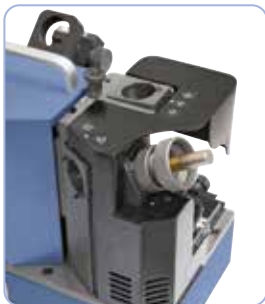
Schleifen des Freiwinkels bei 2-schneidigem Fräser
