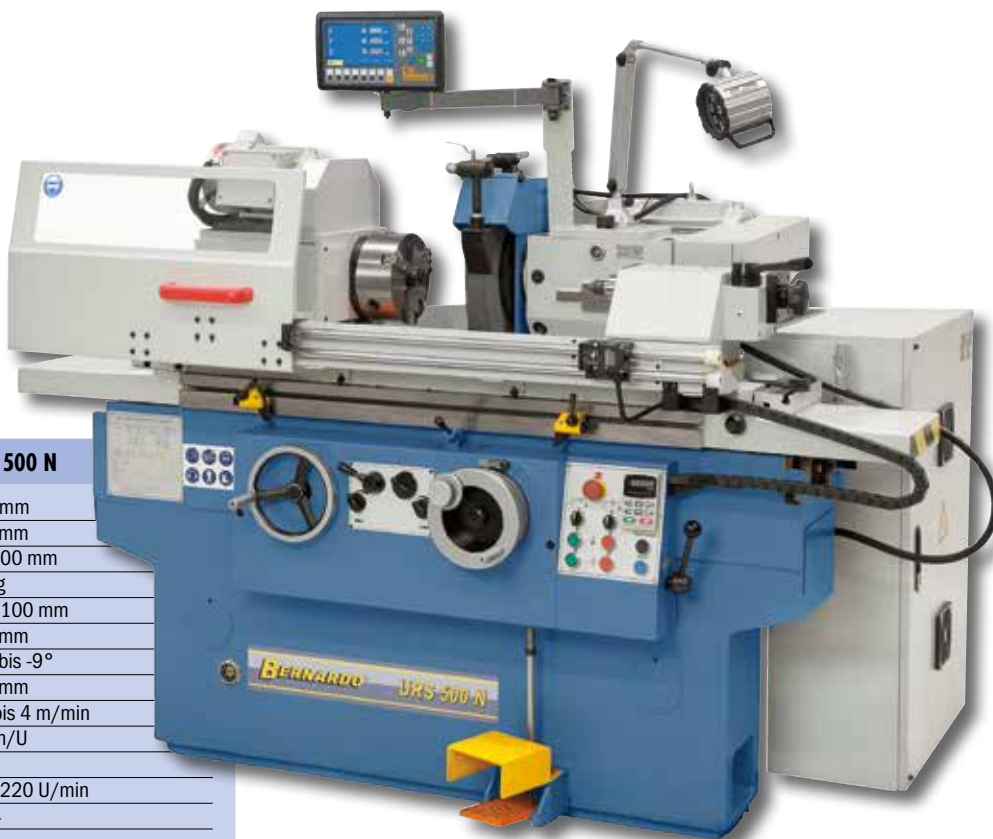
Die serienmäßige 2-Achs-Digitalanzeige garantiert einfaches Arbeiten und erhöhte Genauigkeit
