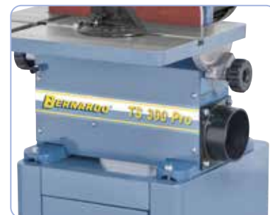
Serienmäßig mit Absaugventilator im Maschinenkörper.
