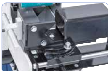
Die Ableseung des gewünschten Schleifwinkels erfolgt mittels Skala
