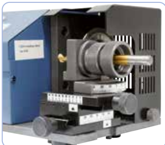
Einstellbarer Schleifwinkel von -30° bis +30°
