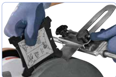
Einfaches Einstellen des optimalen Winkels mit der Winkellehre WL-60 (Standard).
