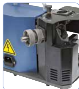
Schleifen des Freiwinkels bei 3- und 4-schneidigem Fräser
