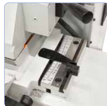
Zum Konischschleifen zwischen den Spitzen kann der Tisch von +3° bis -7° geschwenkt werden.
