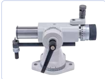
Schafffräuserschleifeinrichtung 50D, Schleifbereich: 3 - 25 mm (optional).
