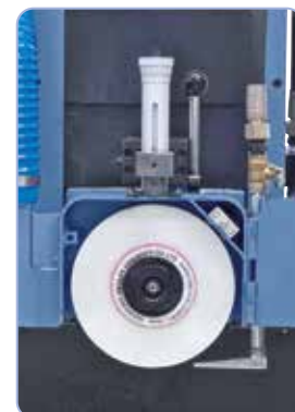
Vibrationsarmer Lauf und hohe Genauigkeit der Schleifspindel durch die vorgespannten Speziallager.
