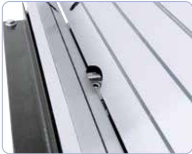
Die Fashöhe ist von 0 - 3 mm stufenlos einstellbar.
