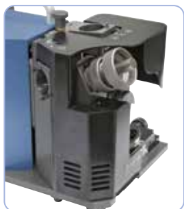
Schleifen des Freiwinkels bei 2-schneidigem Fräser
