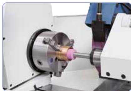
Serienmäßig mit abklappbarer Innenschleifeinrichtung
