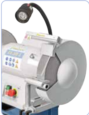
Stabiles Gehäuse mit Absauganschluss, groß- dimensionierter Funkenschutz und Arbeitsleuchte
