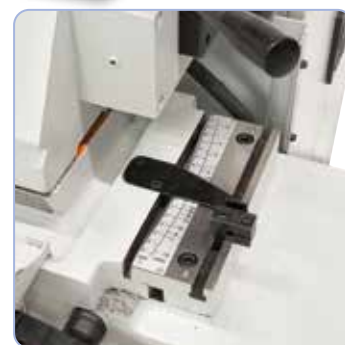
Zum Konischschleifen zwischen den Spitzen kann der Tisch von +3° bis -9° geschwenkt werden.
