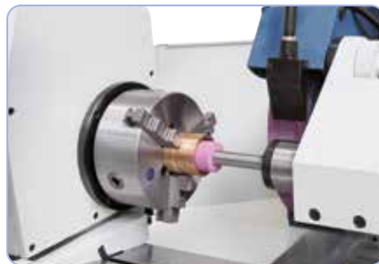
Serienmäßig mit abklappbarer Innenschleifeinrichtung
