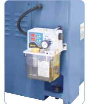
Automatische Zentralschmierung für alle Führungsbahnen und Spindeln.
