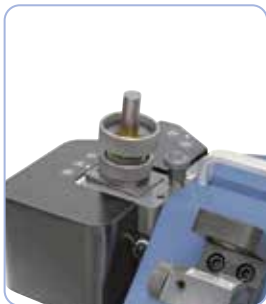
Schleifen der Schneidkante bei 1 und 3
