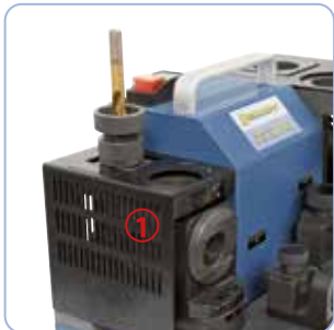
1. Hinterschleifen des Freiwinkels \varnothing 2 - 13 mm 2. Hinterschleifen des Freiwinkels \varnothing 8 - 32 mm
