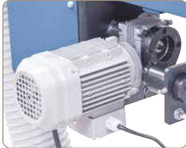
Wartungsfreier Getriebemotor für die Schleifbandoszillation.
