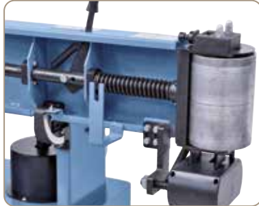
Gefederte Bandspannung, dadurch automatischer Ausgleich von Bandlängendifferenzen.
