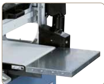
Vergrößerte Auflagefläche durch beidseitige Tischverlängerungen.
