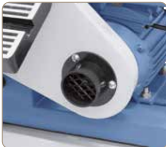
Serienmäßig mit 2 Absaugstutzen diam. 50 mm.
