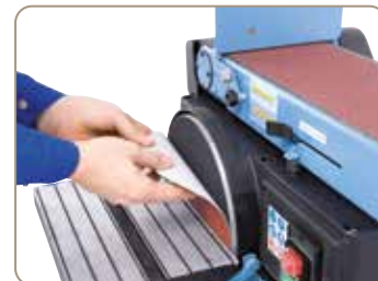
Einfacher und schneller Wechsel des Schleiftellers durch Klettverschluss
