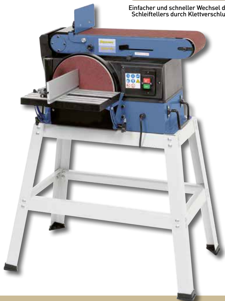
Der Planschleiftisch ist sowohl horizontal als auch vertikal verwendbar
