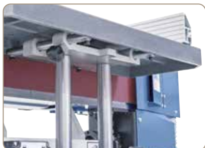
Der höhenverstellbare Arbeitstisch kann zusätzlich vor und zurück verschoben werden.
