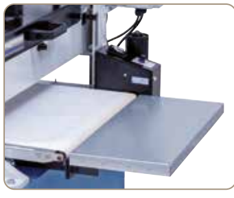
Vergrößerte Auflagefläche durch beidseitige Tischverlängerungen.
