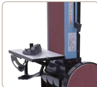
Tellerschleiftisch kann zum Bandschleifen verwendet werden.
