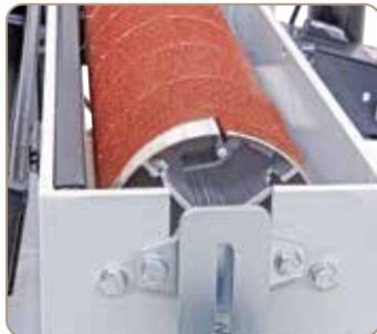
Schnellspannsystem zum Befestigen des Schleifbandes.
