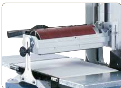
Aufklappbare Absaughaube zum Wechseln des Schleifbandes.
