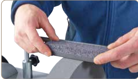
05-2050 Schleifstein: Dient zum Präparieren der Schleifscheibe (fein/grob)
