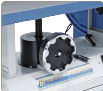
Die Höhenverstellung des Arbeitstisches erfolgt über ein ergonomisch angebrachtes Handrad an der Vorderseite der Maschine.
