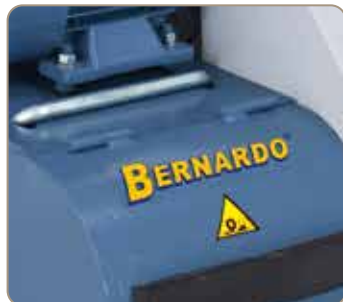
Ausziehbarer Tragegriff um den Transport der Maschine zu erleichtern.
