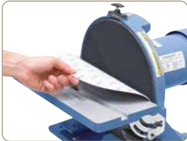
Inklusive Klettauflage, optimal zum Wechseln der Schleifteller (TS 300)
