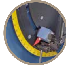
Stufenlos schwenkbare Schleifaggregat für vertikales und horizontales Schleifen.
