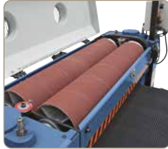
2 Schleifbandwalzen für Grob- und Feinschliff in einem Schleifvorgang.
