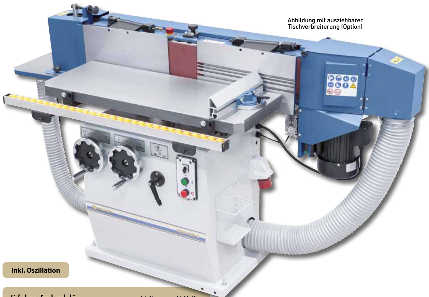
Schnelles Aufklappen der Schleifanschläge zum Massivholzschleifen.
