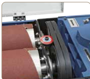
Feineinstellung für die hintere Schleifwalze.
