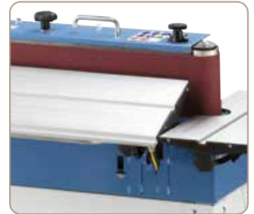
Der Arbeitstisch ist von 0° bis 45° schwenkbar.
