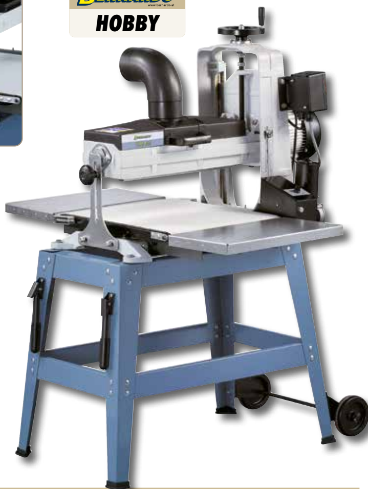
Klemmsystem zum Fixieren der Schleifeinheit.
