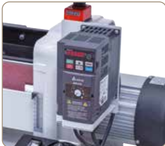
Der hochwertige Frequenzumrichter ermöglicht eine stufenlose Einstellung der Spindeldrehzahl.
