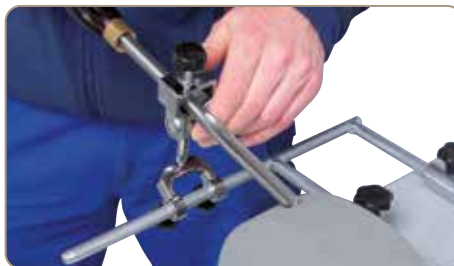
05-2052 Vorrichtung für Drehröhren: Werkzeugdurchmesser max. 20 mm
