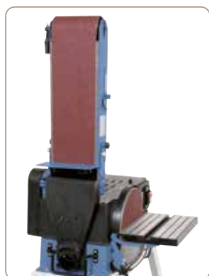
Der Planschleiftisch ist sowohl horizontal als auch vertikal verwendbar
