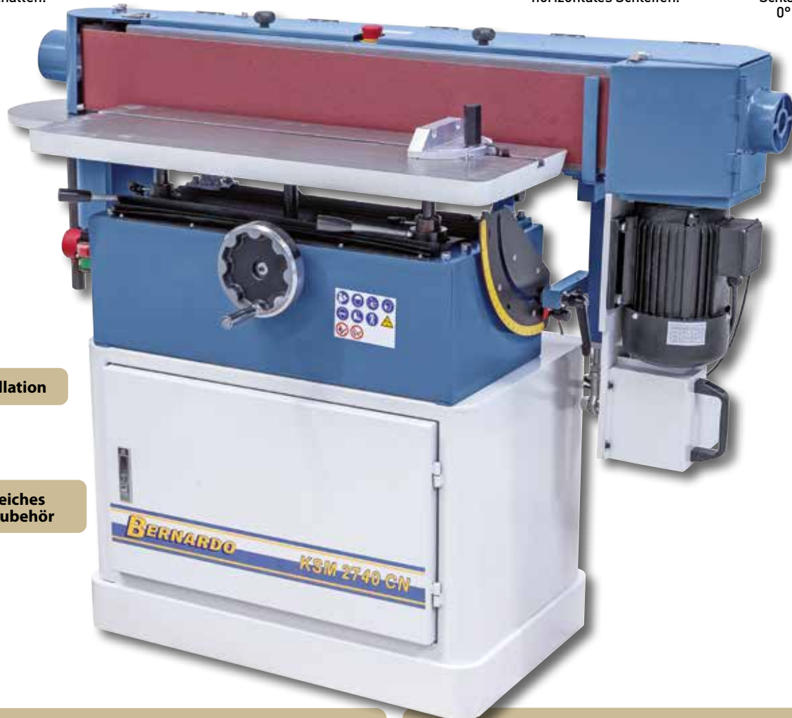
Stufenlos schwenkbare Schleifaggregat für vertikales und horizontales Schleifen.
