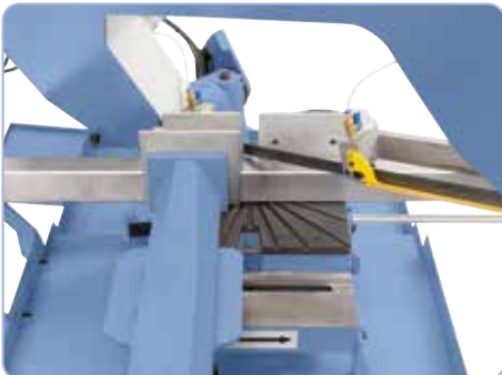
Schraubstock mit Schnellarretierung zum Doppelgehrungsschneiden verschiebbar
