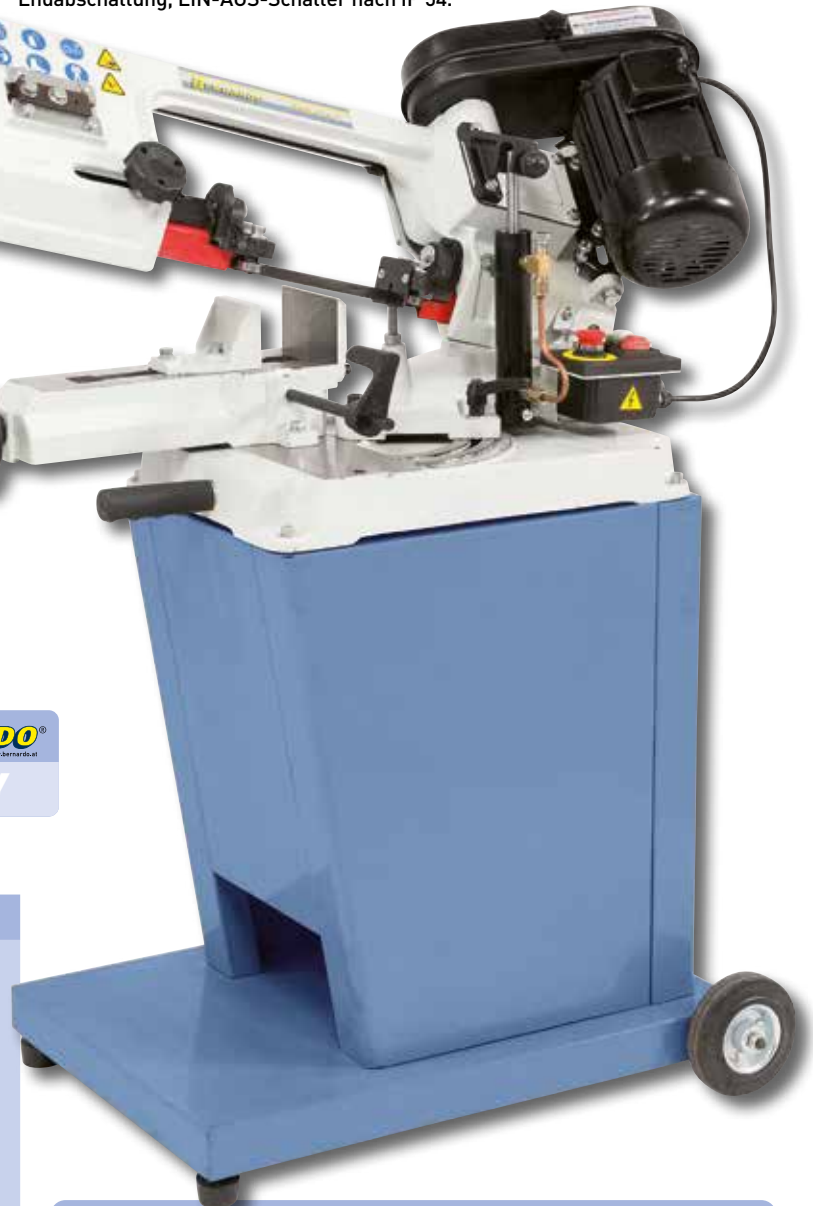
Schwenkbarer Sägebügel zum Doppelgehrungsschnitten von +45° bis -60°.
