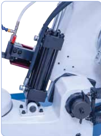
Serienmäßig mit Hydraulik-Absenkzylinder für stufenloses Absenken des Sägebügels und automatischer Endabschaltung nach Materialdurchschnitt.
