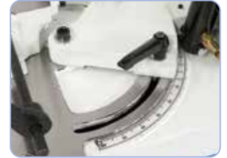
Schwenkbarer Sägebügel zum Doppelgehrungsschnitten von +45° bis -60°.
