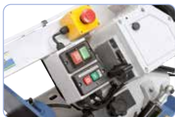
Übersichtliche Anordnung der Schaltelemente am Sägebügel.
