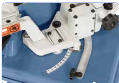
Verstellbarer Sägebügel zum Gehrungsschneiden
