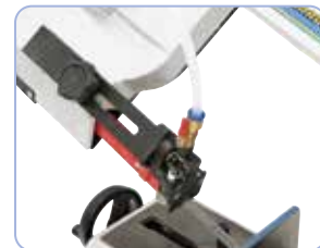
Kugelgelagerte Sägebandführung, einstellbar auf die jeweilige Werkstückbreite.
