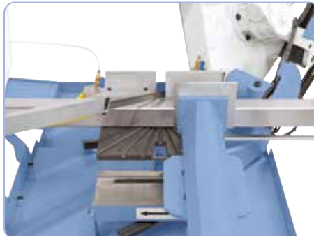
Schraubstock mit Schnellarretierung zum Doppelgehrungsschneiden verschiebbar
