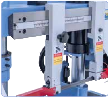
Die einstellbare Sägebeführung verhindert ein seitliches Verlaufen oder Verkanten des Sägebandes.
