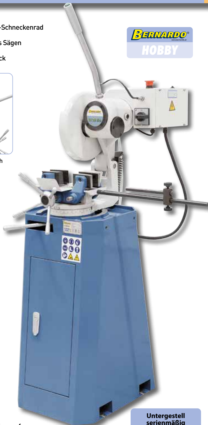
Schutzabdeckung öffnet automatisch beim Absenken des Getriebekopfes.
