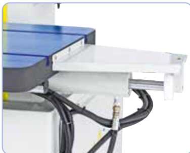
Hydraulikzylinder für Tischvorschub
