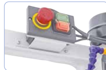
Sicherheitsschalter mit Unterspannungsauslöser und separatem Not-Halt-Taster.
