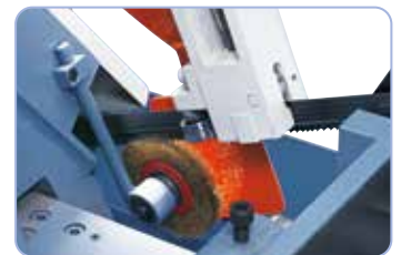
Kugelgelagerte Sägebandführung und Spänebürste für optimale Schnittergebnisse.
