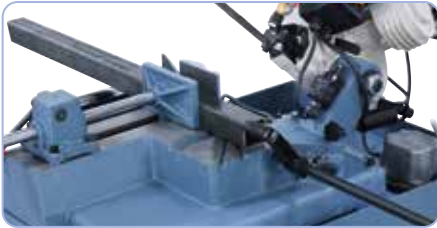
Einfache Verstellung des Schraubstockes mittels Schnellspannhebel.
