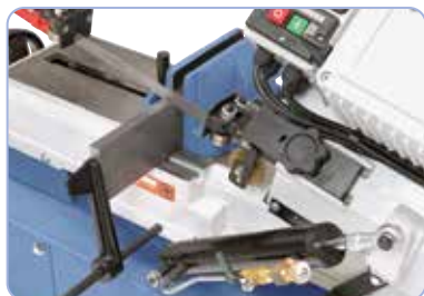
Schnellspannschraubstock mit Materialanschlag.
