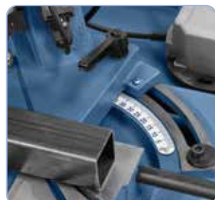
Schwenkbarer Sägebügel für Gehrungsschnitte bis 60°
