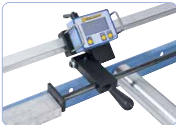
Hochklappbarer Materialanschlag, wahlweise rechts oder links verwendbar
