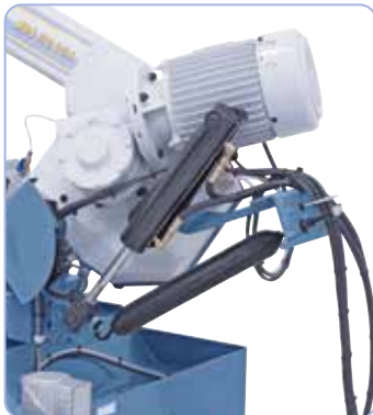
Serienmäßig mit Hydraulik-Absenckzylinder für stufenloses Absenken des Sägebügels und automatischer Endabschaltung nach Materialdurchschnitt.
