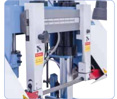
Die einstellbare Sägebänderführung verhindert ein seitliches Verlaufen oder Verkanten des Sägebandes.
