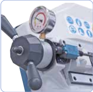
Kontrolle der Sägebandspannung mittels Manometer.
