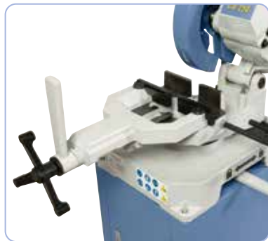
Großdimensionierter Schraubstock mit Sterngriff, Schnellspannhebel und Spezialspannbacken für präzise und gratfreie Schnitte
