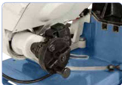
Auflagedruck des Sägebügels 3-fach einstellbar
