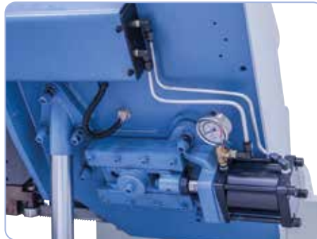
Serienmäßig mit hydraulischer Bandspannung ausgestattet (NC Pro)
