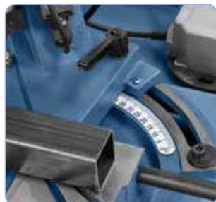
Schwenkbarer Sägebügel für Gehrungsschnitte bis 60°
