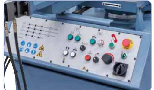
Dreheswitcher für stufenlose Schnittgeschwindigkeit und Regelventil für den Auflagedruck am ergonomisch angebrachten Bedientableau
