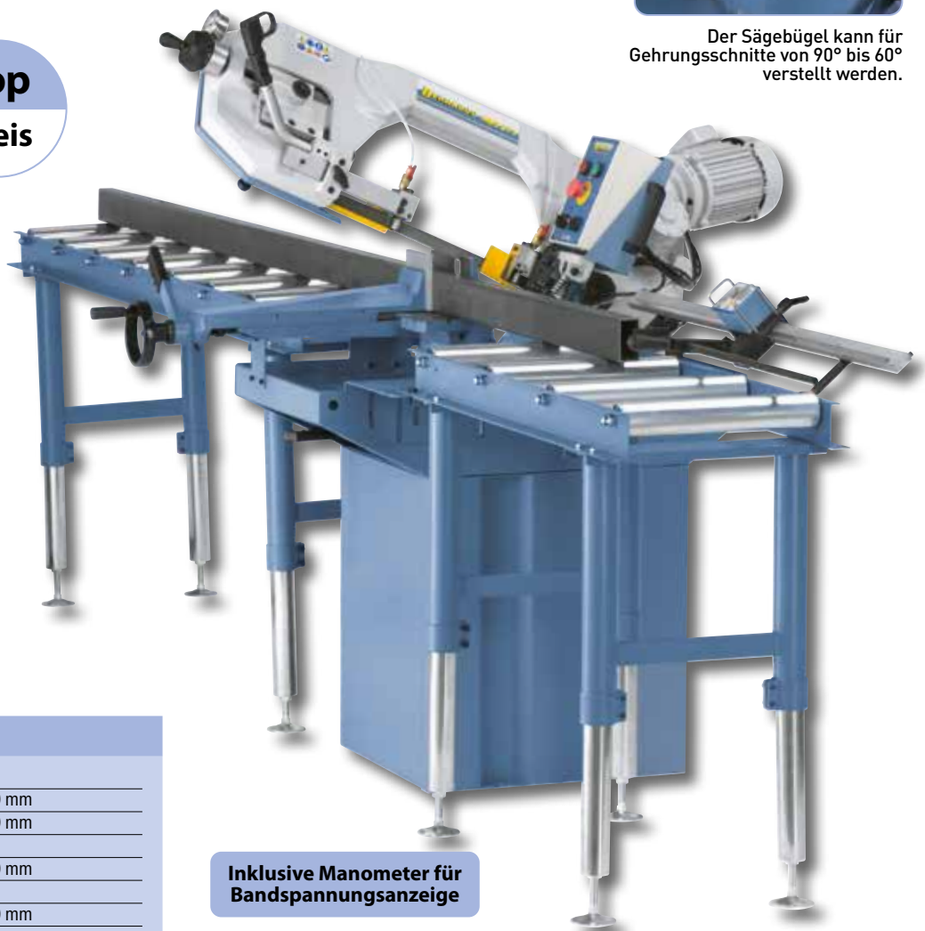
Das serienmäßige Manometer ermöglicht ein optimales Einstellen der Sägebandspannung.
