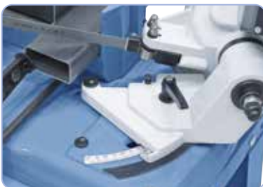
Sägebügel mit Sperrvorrichtung zum besseren Handling beim mobilen Einsatz
