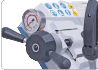
Optimales Einstellen der Sägebandspannung mittels Manometer.
