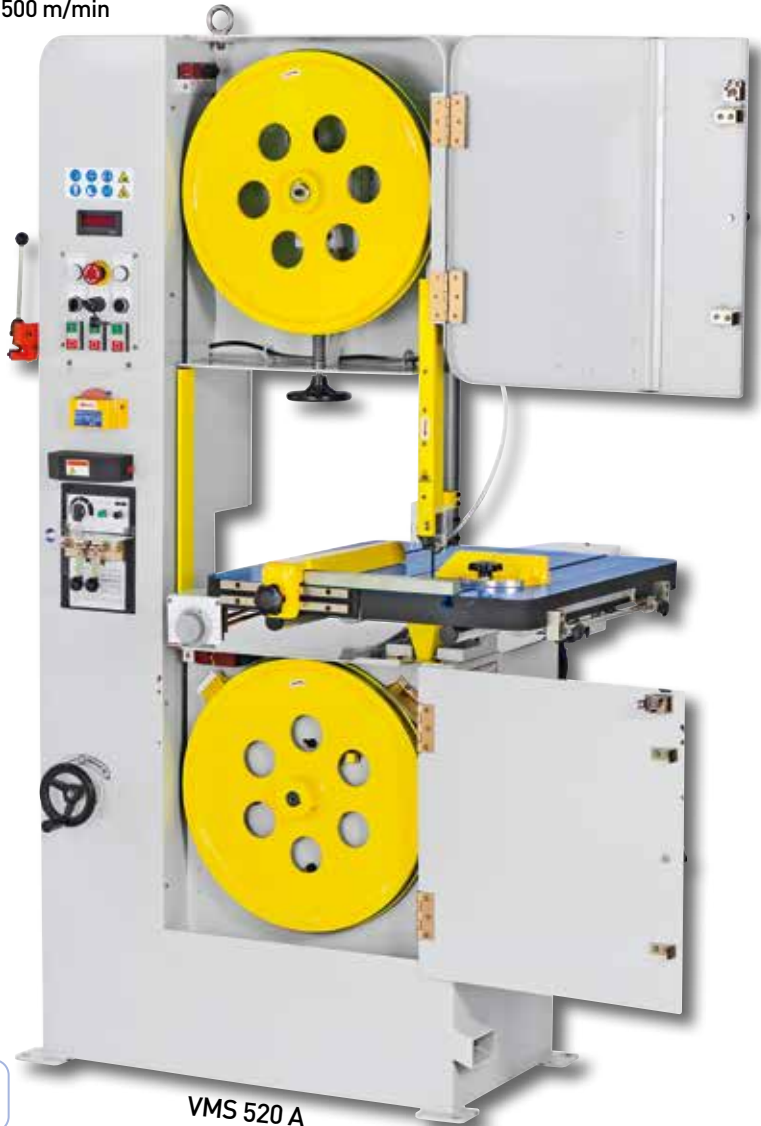
Inklusive Bandschweißeinrichtung mit Ausglühvorrichtung, Schere und Schleifstein
