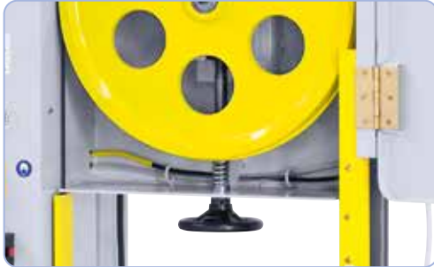
Die Einstellung der Blattspannung erfolgt mittels Handrad.
