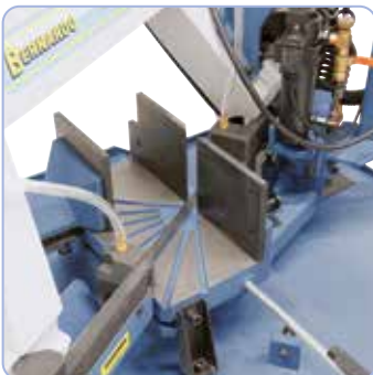
Der Sägebügel kann für Gehrungsschnitte von 90° bis 60° verstellt werden.
