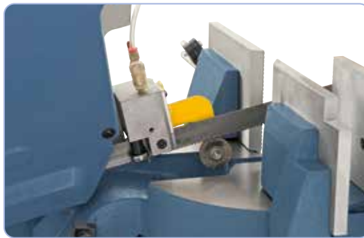
Kombinierte Rollen-Hartmetallführung verhindert schnellen Verschleiß des Sägebandes.
