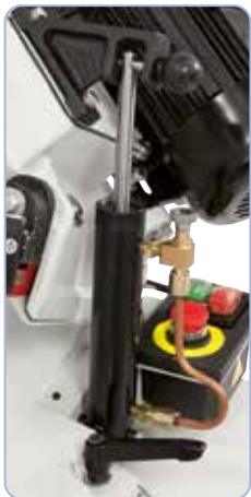
Kugelgelagerte Sägebandführung, einstellbar auf die jeweilige Werkstückbreite.
