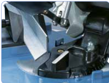
Verstellbarer Sägebügel zum Gehrungsschneiden
