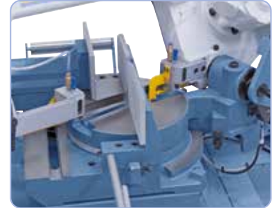
Der Sägeschlitz im Drehteller bewegt sich gleichzeitig mit dem Sägebühgel.
