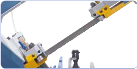
Kugelgelagerte Sägebandführung für präzise Schnitte
