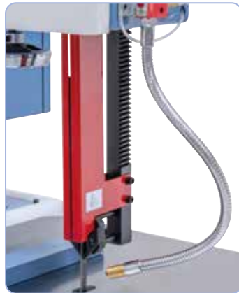
Mikrosprühsystem und Längsanschlag im Lieferumfang enthalten.
