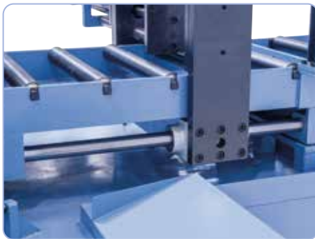
Präzisions-Führung und Hydraulikantrieb für höchste Positioniergenauigkeit des Werkstückes.
