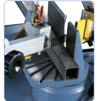
Der Sägebügel kann für Gehrungsschnitte von 90° bis 60° verstellt werden.
