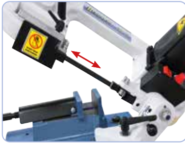
Sägebandführung kann auf die Materialbreite eingestellt werden.
