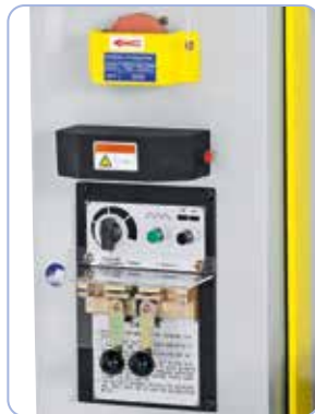
Inklusive Bandschweißeinrichtung mit Ausglühvorrichtung, Schere und Schleifstein
