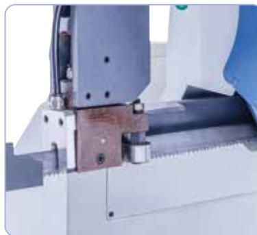
Sägebandführung über kombiniertes Rollen-Backenführungssystem mit Hartmetalleinsätzen
