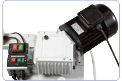
Getriebe mit gehärteter und geschliffener Schneckenwelle, das Schneckenrad ist aus Bronze
