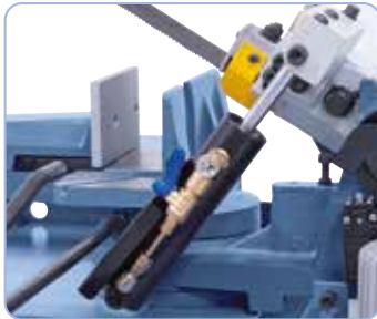
Hydraulikzylinder für stufenloses Absenken des Sägebügels.
