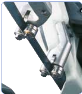
Kugelgelagerte Sägebandführung mit Schnellverstellung zum Anpassen an die Werkstückbreite garantiert ein optimales Arbeitsergebnis.
