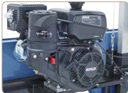
14 PS starker Benzin-Motor Kohler Command Pro CH 440 mit Seilzugstarter
