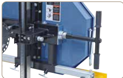
Bedienerfreundliche Sägebandspannung, leicht zugänglich
