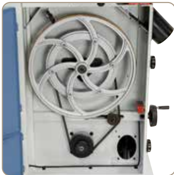
Die gewünschte Schnittgeschwindigkeit wird über einen Keilriemen am unteren Laufrad eingestellt (HBS 400 N / HBS 460 N).
