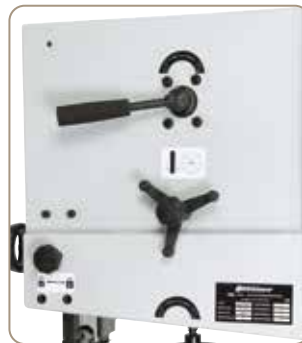
Einfacher Sägebandwechsel mit Schnellspannhebel, die Grundeinstellung des Antriebsrades wird dabei nicht verändert.
