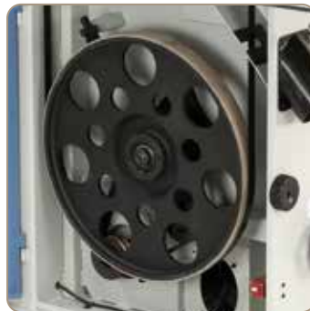
Dynamisch ausgewuchtete Laufräder aus Grauguss sorgen für einen ruhigen Lauf (HBS 500 N).
