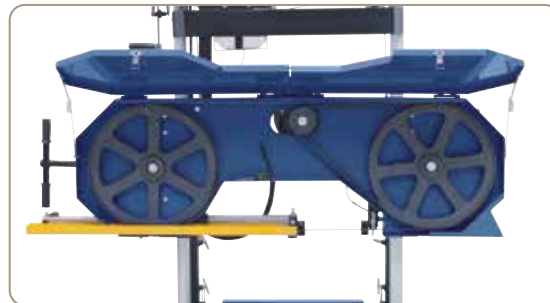
Einfacher Sägebandwechsel durch aufklappbare Abdeckungen
