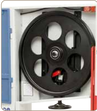
Dynamisch ausgewuchtete Laufräder aus Grauguss sorgen für einen ruhigen Lauf.
