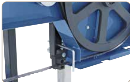
Kombinierte Rollen-Hartmetalleinsätze sorgen für eine ideale Sägebandführung und gewährleisten dadurch optimale Schnittergebnisse.
