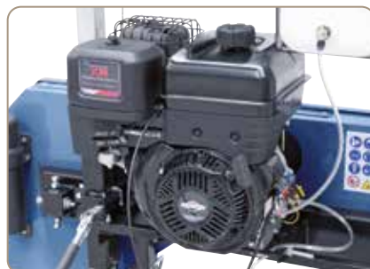
Zwei Antriebsvarianten erhältlich: 10 PS starker Elektro-Motor bzw. 14 PS starker Benzin-Motor mit Seilzugstarter
