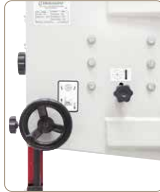
Ergonomisch angebrachte Handräder zur Einstellung der Blattspannung bzw. Schnitthöhe an der Rückseite der Maschine.
