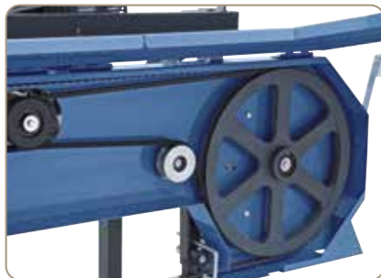
Das Antriebsrad mit Spezialgummibandage sorgt für einen ruhigen Lauf und erhöht die Lebensdauer des Sägebandes.
