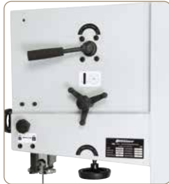
Einfacher Sägebandwechsel mit Schnellspannhebel, die Grundeinstellung des Antriebsrades wird dabei nicht verändert.
