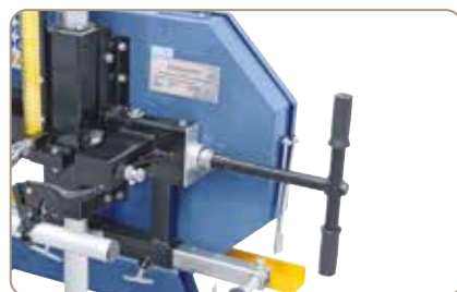
Bedienerfreundliche Sägebandspannung, leicht zugänglich
