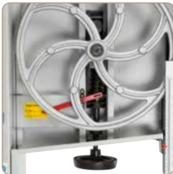
Die Einstellung der Blattspannung erfolgt mittels Handrad und wird über ein Diagramm am oberen Laufrad angezeigt.
