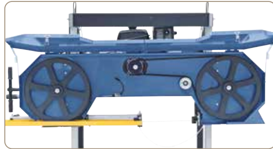
Einfacher Sägebandwechsel durch aufklappbare Abdeckungen
