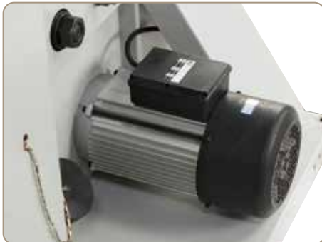
Durchzugsstarker Antriebsmotor mit Bremsfunktion, optimale Späneabfuhr durch den Absaugstutzen diam. 100 mm.
