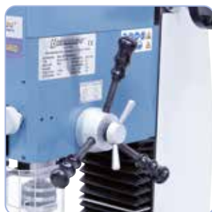
Großdimensionierter Sterngriff für leichte Pinolenzustellung beim Bohren, Handrad für Feinzustellung beim Fräsen.
