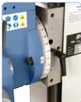
Wartungsfreie Schwalbenschwanzführung mit nachstellbarer Keilleiste.
