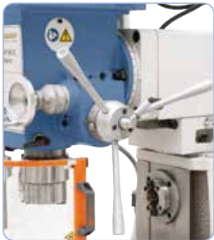
Pinolnverstellung mittels Handgriff, Feinzustellung mittels Handrad.
