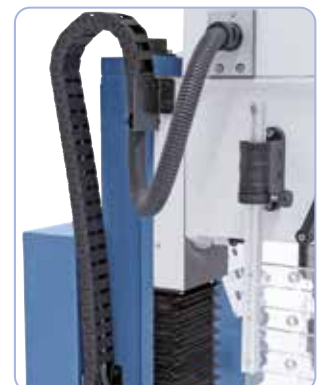
Inklusive Kabelführung über Energiekette.
