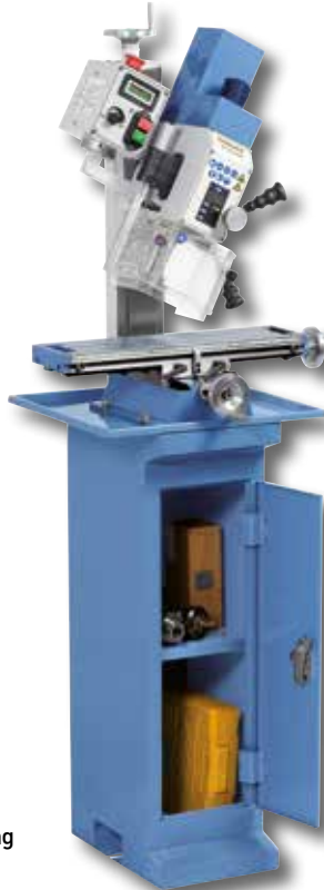
Abbildung mit Untergestell BF 1 (Option) und geschwenktem Fräskopf
