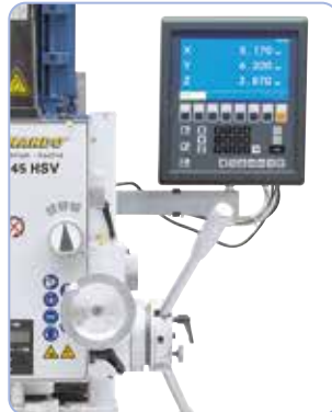
Die Digitalanzeige ES-12 V mit LCD-Display bietet vielfältige Funktionen wie z.B.: Lochkreisbearbeitung, Taschenfräsfunktion, ...
