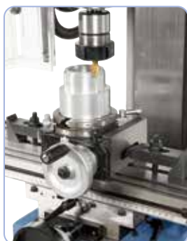
Optional lieferbarer Rundtisch für eine Vielzahl weiterer Anwendungsmöglichkeiten.
