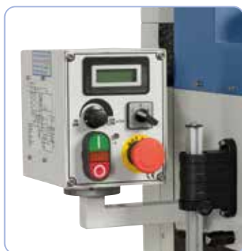
Serienmäßig mit digitaler Drehzahlanzeige und Rechts- Linkslaufeinrichtung
