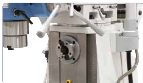
Erweiterte Anwendungsmöglichkeiten durch die Horizontalspindel
