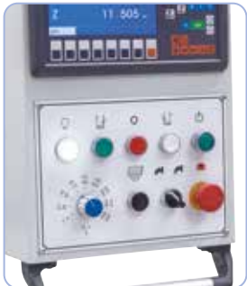
Schnelles und einfaches Einstellen der gewünschten Vorschubgeschwindigkeit direkt am Bedienpaneel.
