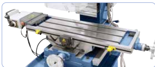
Großdimensionierter Kreuztisch mit T-Nuten und Kühlmittelrinne. Abbildung mit optionalem Frästischvorschub AL 450 D.
