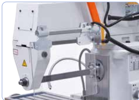
Serienmäßig mit Gegenlager und langem Fräsdorn für horizontale Fräsarbeiten.
