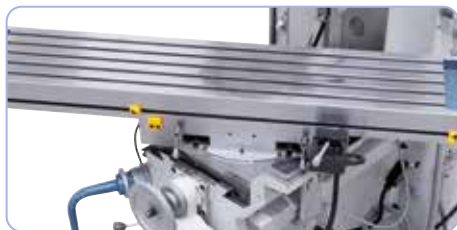
Frästisch von -45° bis +45° schwenkbar.
