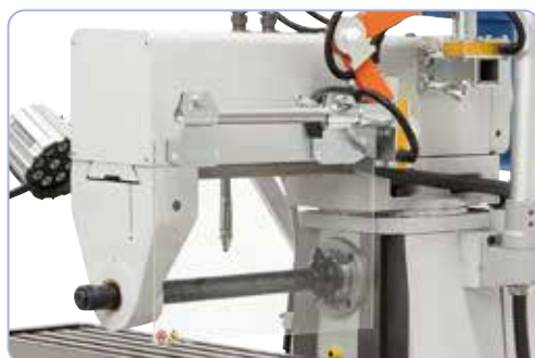
Serienmäßig mit Gegenlager und langem Fräsdorn für horizontale Fräsarbeiten.
