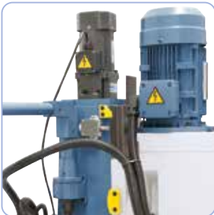
Fräskopfhöhenverstellung serienmäßig mit Hubmotor
