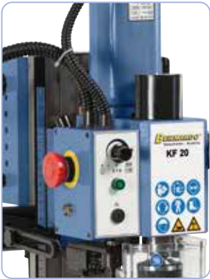
Drehzahlregelung mittels Vorgelege und elektronisch stufenlos regelbaren Gleichstrommotor
