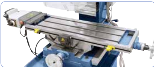
Serienmäßig mit stufenlosem Frästischvorschub in x-Achse mit Eilgang
