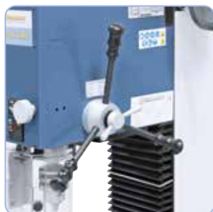
Größdimensionierter Sterngriff für leichte Pinolenzustellung beim Bohren, Handrad für Feinzustellung beim Fräsen.
