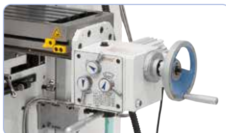
Tischlängsvorschub mit Eilgangsfunktion serienmäßig im Lieferumfang enthalten
