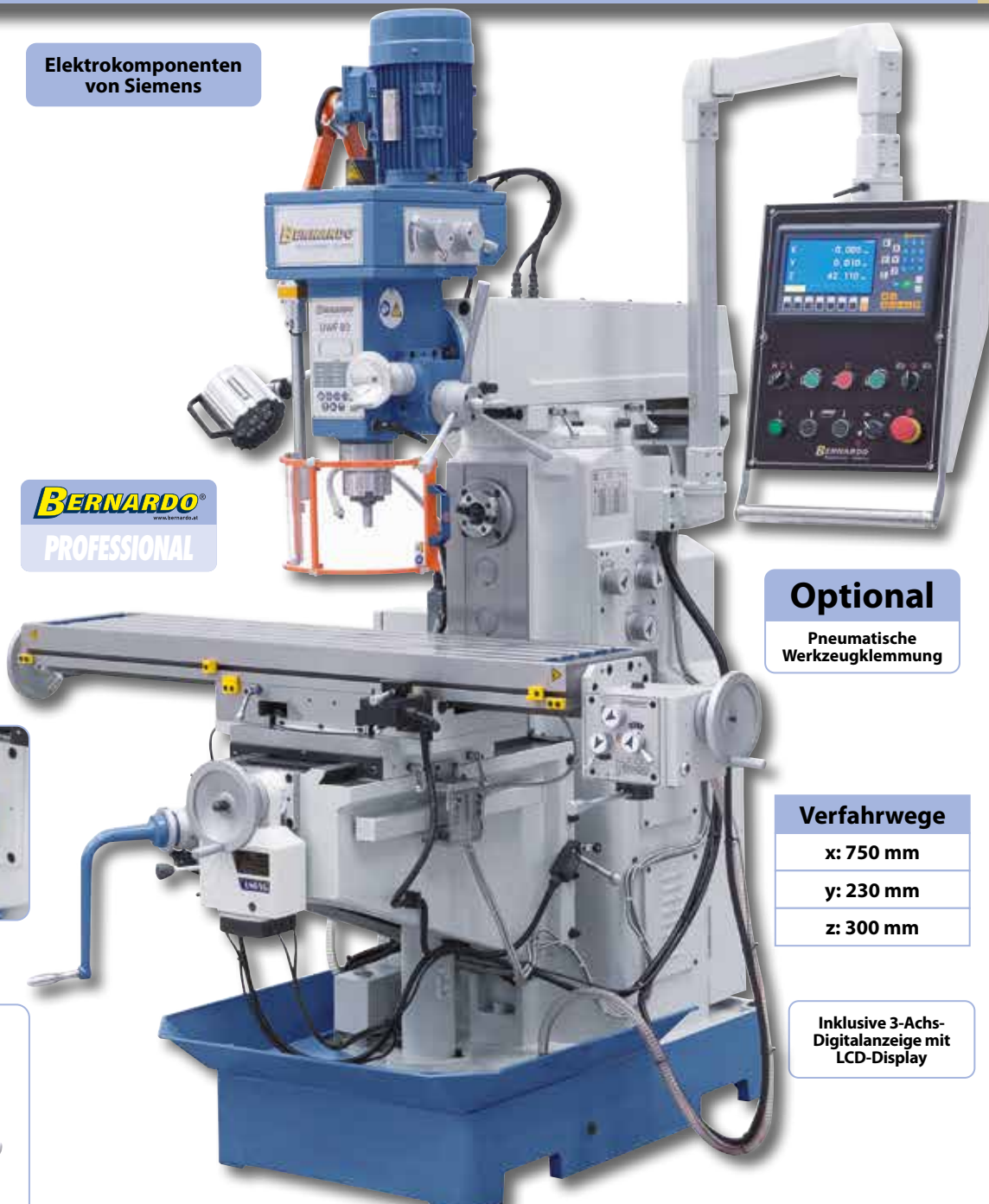
Inklusive stufenlos regelbarem Vorschub für die y-Achse.
