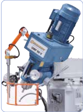
Tisch schwenkbar von -45° bis +45°
