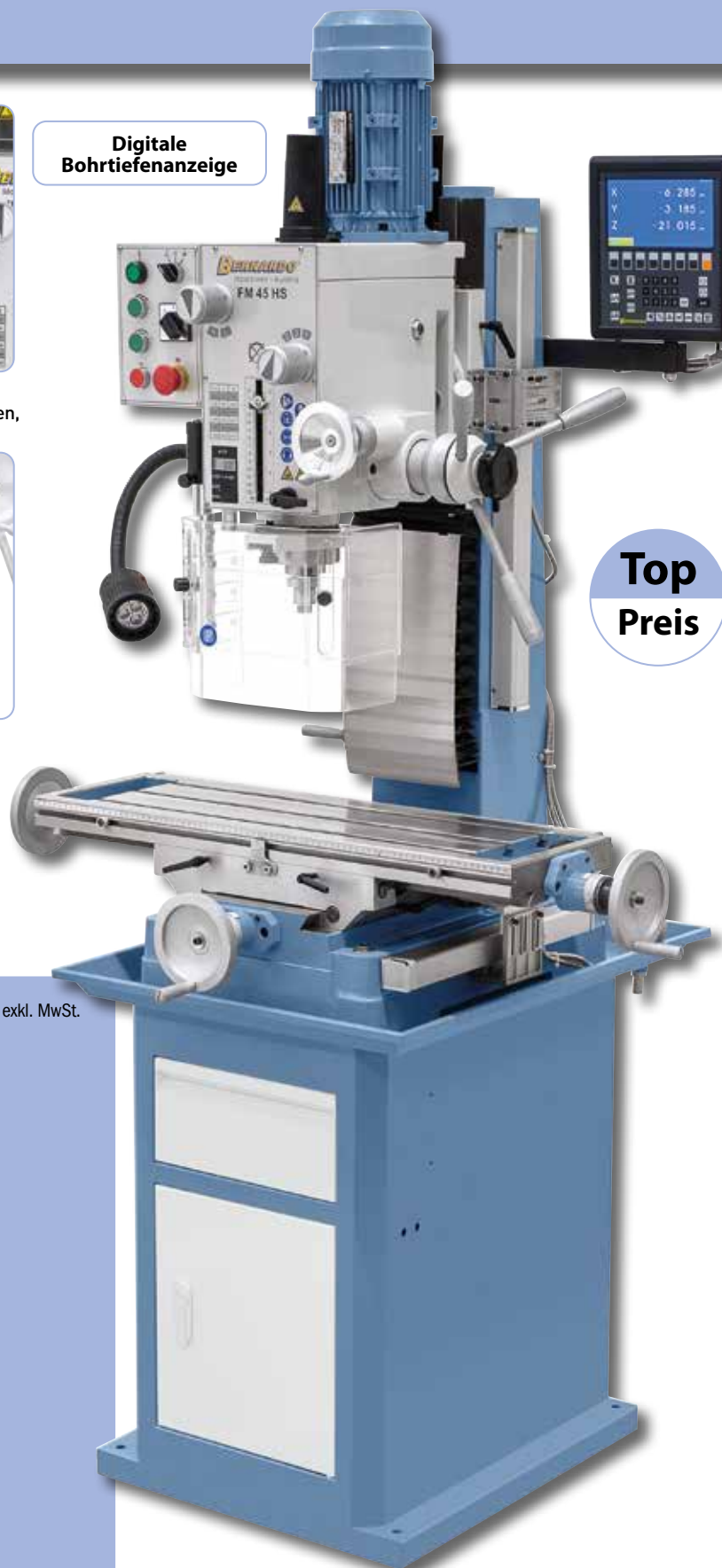
Großdimensionierte Pinole mit 125 mm Hub, serienmäßig mit digitaler Pinolenhubanzeige
