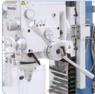
Serienmäßig mit einem 3-fachen automatischen Pinolenvorschub ausgestattet.
