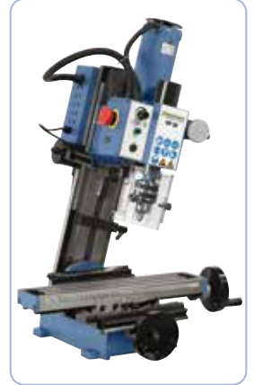
KF 20 mit geschwenktem Fräskopf für erweiterten Einsatzbereich (Standard)
