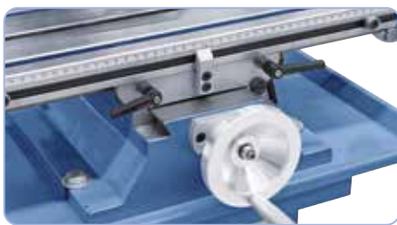
Schwalbenschwanzführung für x-, y- und z-Achse, nachstellbar über Keilleisten.
