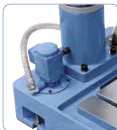
Leistungsstarke Kühlmittelpumpe im Lieferumfang enthalten.
