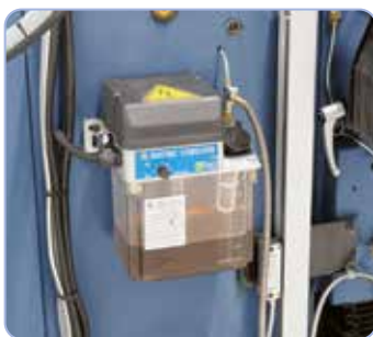
Elektrische Zentralschmierung für alle Führungsbahnen und Spindeln.
