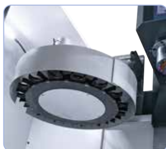
16-fach Werkzeugwechsler für kurze Umrüstzeiten
