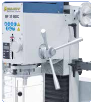
Großdimensionierter Sterngriff für leichte Pinolenzustellung beim Bohren, Handrad für Feinjustierung beim Fräsen.
