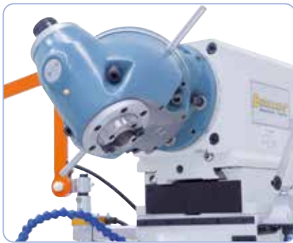
Universalfräskopf für verschiedenste Winkelpositionen verstellbar
