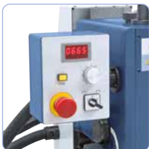
Serienmäßig mit digitaler Drehzahlanzeige und Rechts-Linkslaufeinrichtung
