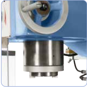
Großdimensionierte Pinole gewährleistet höchstmögliche Stabilität.
