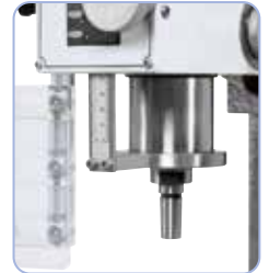
Kräftig dimensionierte Pinole mit Kegel- rollenlager für hohe Rundlaufgenauigkeit.
