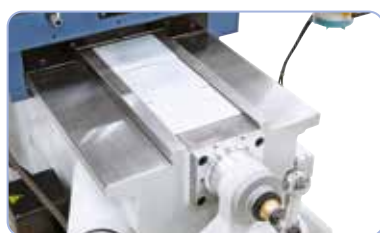
Rechteckführung in der y-Achse
