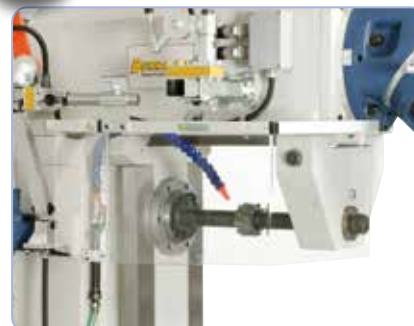
Serienmäßig mit Gegenlager und langem Fräsdorn für horizontale Fräsarbeiten.
