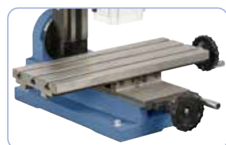
Präzise oberflächenbearbeiteter Kreuztisch mit 3 T-Nuten
