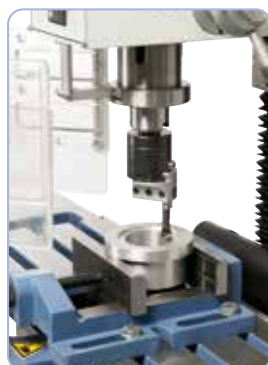
Auf Wunsch kann die Maschine mit einem Ausdrehkopf ausgestattet werden.
