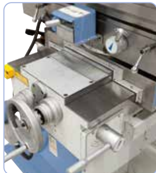
Die großdimensionierte Rechteckführung in y- und z-Achse gewährleistet eine hohe Stabilität.
