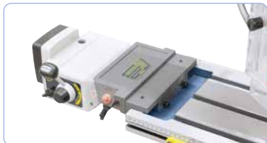
Großdimensionierter Kreuztisch mit T-Nuten und Kühlmittelrinne. Abbildung mit optionalem Frästischvorschub AL 450 D.
