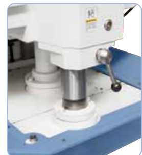
Manuelle Klemmung der z-Achse für erhöhte Stabilität.
