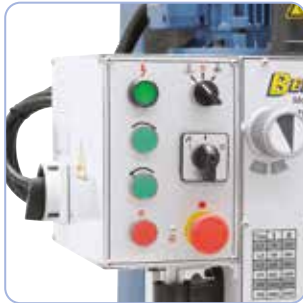
Übersichtlich angeordnete Schaltelemente (Gewindebohren, Start-Stop,...)
