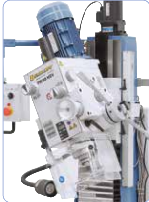
Beidseitig schwenkbarer Fräskopf von -60° bis +60°.
