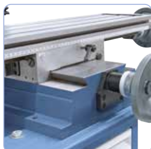
Schwalbenschwanzführung für x-, y- und z-Achse, nachstellbar über Keilleisten
