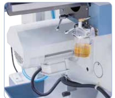
Inklusive Positioniermotor für den Frästisch in der z-Achse.
