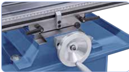
Schwalbenschwanzführung für x-, y- und z-Achse, nachstellbar über Keilleisten.
