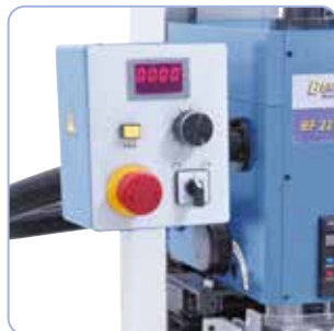
Serienmäßig mit digitaler Drehzahlanzeige und Rechts-Linkslaufeinrichtung
