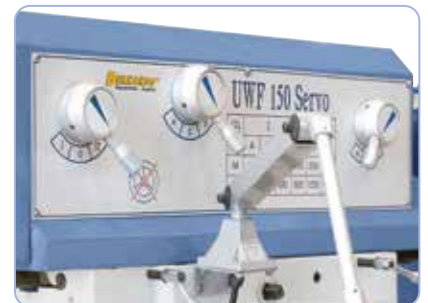
Einfache Bedienung der Schaltelemente für den Drehzahlwechsel
