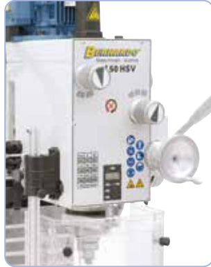
Einfacher und schneller Drehzahlwechsel mittels Getriebewahlschalter.
