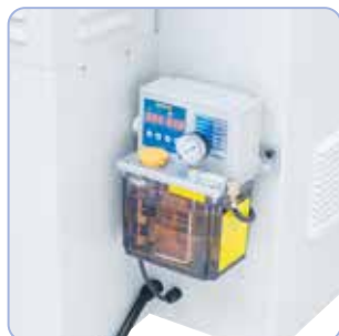
Elektrische Zentralschmierung im Lieferumfang enthalten.
