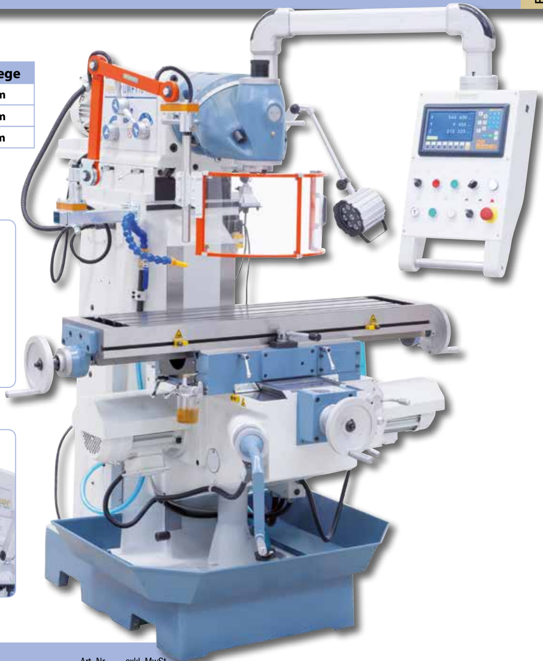
Universalfräskopf für verschiedenste Winkelpositionen verstellbar
