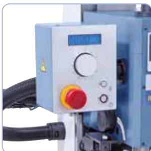
Serienmäßig mit digitaler Drehzahl- und Pinolenhubanzeige
