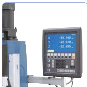
Die Digitalanzeige ES-12 V mit LCD-Display bietet vielfältige Funktionen wie z.B.: Lochkreisbearbeitung, Taschenfräsfunktion, ...
