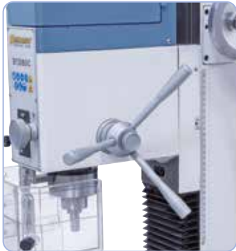
Großdimensionierter Sterngriff für leichte Pinolenzustellung beim Bohren, Handrad für Feinjustierung beim Fräsen.
