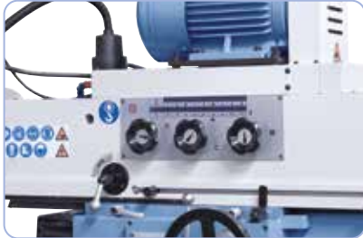
Einfach einstellbare Spindeldrehzahl am Oberarm.
