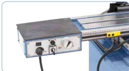
Für erhöhten Bedienkomfort optional mit stufenlos regelbarem Frästischvorschub.
