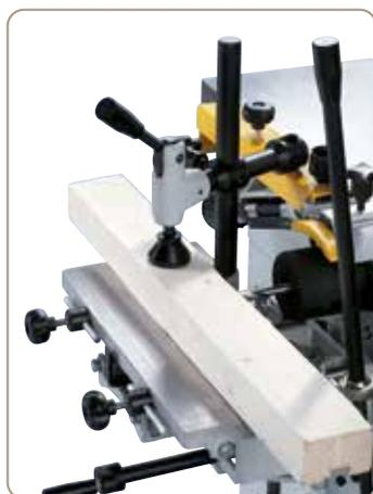
Die Langlochbohrereinrichtung ist ideal für Langlöcher, Dübel- und Schräglochbohrungen, ...
