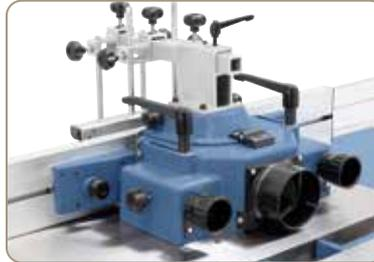
Die Aluminium-Anschlagschienen können schnell und einfach auf das jeweilige Fräszerzeug eingestellt werden und sind zusätzlich mit einer Feineinstellung ausgestattet.
