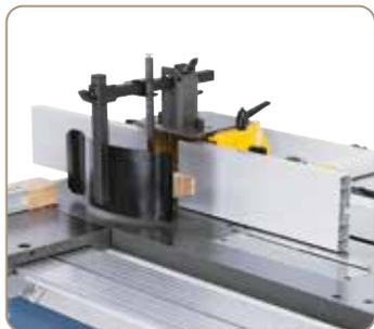
Die solide Fräuserschutzhaube kann für Werkzeuge bis 140 mm Durchmesser verwendet werden.
