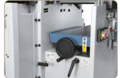
Stabiler Dickentisch aus Grauguss mit mittlerer Zentralführung und Klemmung, zum Hobeln von Werkstücken bis 225 mm Höhe.
