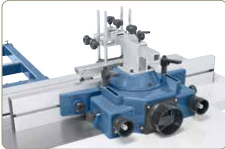
Die Fräuserschutzhaube ist mit einer Feineinstellung ausgestattet. Die Späneabfuhr erfolgt über den integrierten Absauganschluss.
