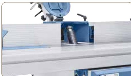
Die nach hinten schwenkbare Frässpindel hat folgende Vorteile: Optimaler Einsatz eines Vorschubapparates, ein Maximum an Sicherheit und ein sauberes Fräsbild.
