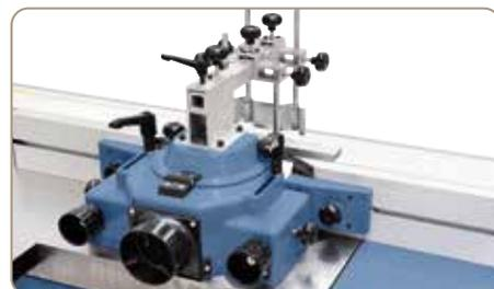
Die Aluminium-Anschlagschienen können schnell und einfach auf das jeweilige Werkstück eingestellt werden und sind zusätzlich mit einer Feineinstellung ausgestattet.
