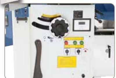
Elektronische Anzeige der eingestellten Spindeldrehzahl.
