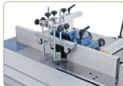
Die Fräseschutzhaube ist mit eloxierten Aluminium-Anschlagschienen ausgestattet.
