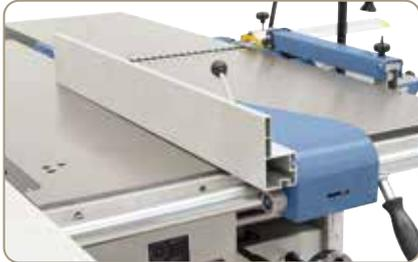
Abklappbarer Parallelanschlag mit mikro-metrischer Feineinstellung.
