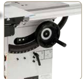
Der Sägeblattwinkel wird über eine große und leicht ablesbare Skala angezeigt.
