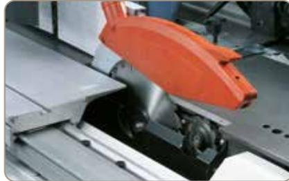
Der Sägeblattschutz mit integriertem Absaugstutzen ist am Spaltkeil befestigt.
