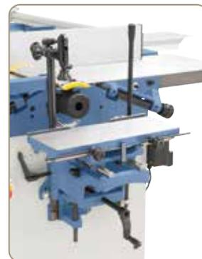
Die serienmäßige Langlochbohrereinrichtung ist ideal für Langlöcher, Dübel- und Schräglöcherbohrungen,....
