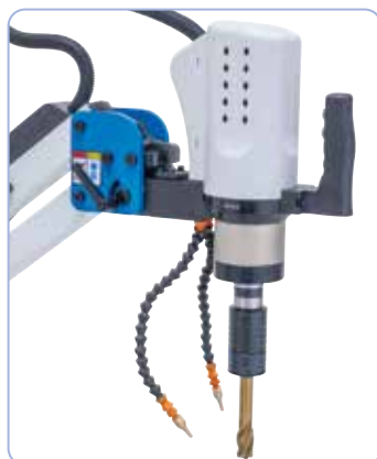
Serienmäßig mit Mikrosprühsystem und Ausblasvorrichtung.
