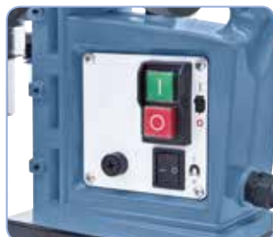
Verwechslungsfreie Anordnung der Schaltelemente.
