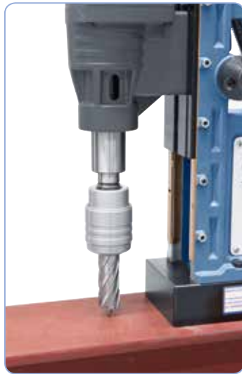
Kernbohren mit Schnellwechsellaufnahme
