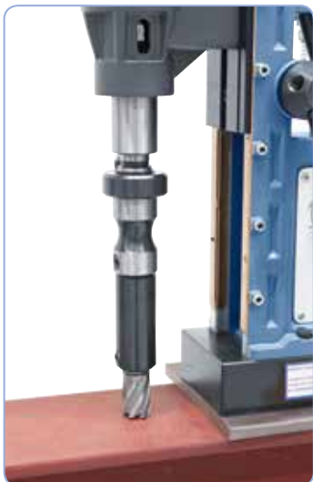
Kernbohren mit Verlängerungsadapter
