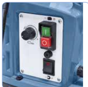
Exaktes Einstellen der Schnittgeschwindigkeit mittels Potentiometer.
