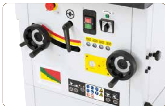
Benutzerfreundlich angebrachte Schalt- und Bedienelemente, elektronische Drehzahlanzeige mittels LED.
