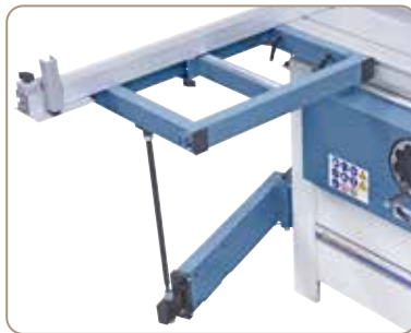
Das Aluminium-Anschlaglineal kann am Auslegertisch sowohl vorne als auch hinten montiert werden.
