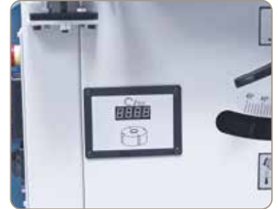
Elektronische Anzeige der eingestellten Spindeldrehzahl.
