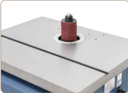
Schleifwalze diam. 75 mm im Lieferumfang enthalten.
