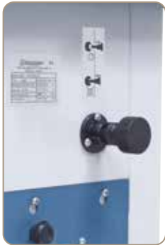
Schneller und einfacher Drehzahlwechsel mittels Keilriemen.
