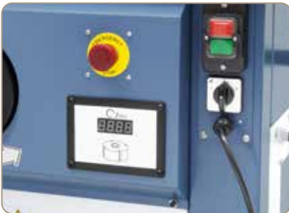
Elektronische Anzeige der eingestellten Spindeldrehzahl.
