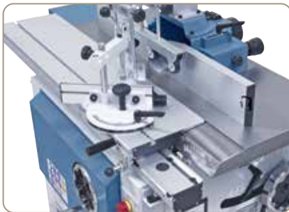
Der serienmäßige Formattisch erleichtert das Bearbeiten größerer Werkstücke.
