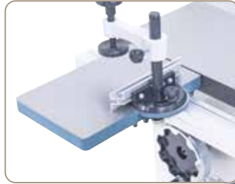
Serienmäßig mit Rolltisch für vereinfachtes Handling bei größeren Werkstücken.
