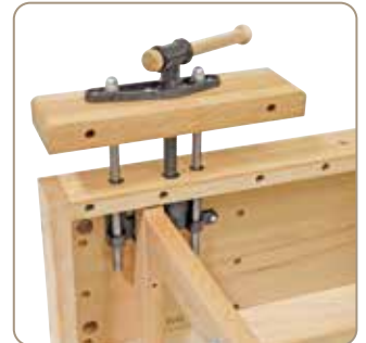
Fransk spændebakke foran med stålspindel og parallelstangstyr
