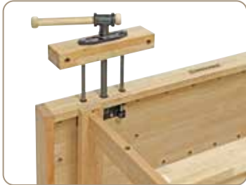
Fransk spændebakke foran med trapezgevindspindel og parallelstangstyring
