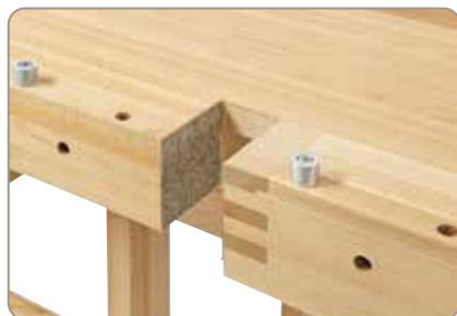
Bagspændebakke med filt puder til at beskytte skrøbelige emner
