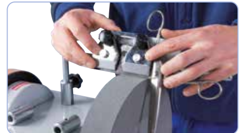
05-2055 Anordning til sakse: Optimal til lige sakse og hækkeklippere
