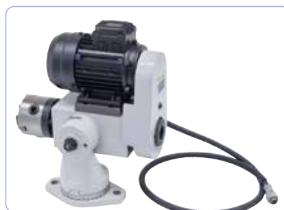
Motoriseret drivenhed med 3-kæbe-spændepatron med diam. 80 mm, perfekt til slibning af aksler (inkluderet).
