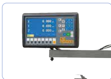
Som standard udstyret med 2-akset digitalt display
