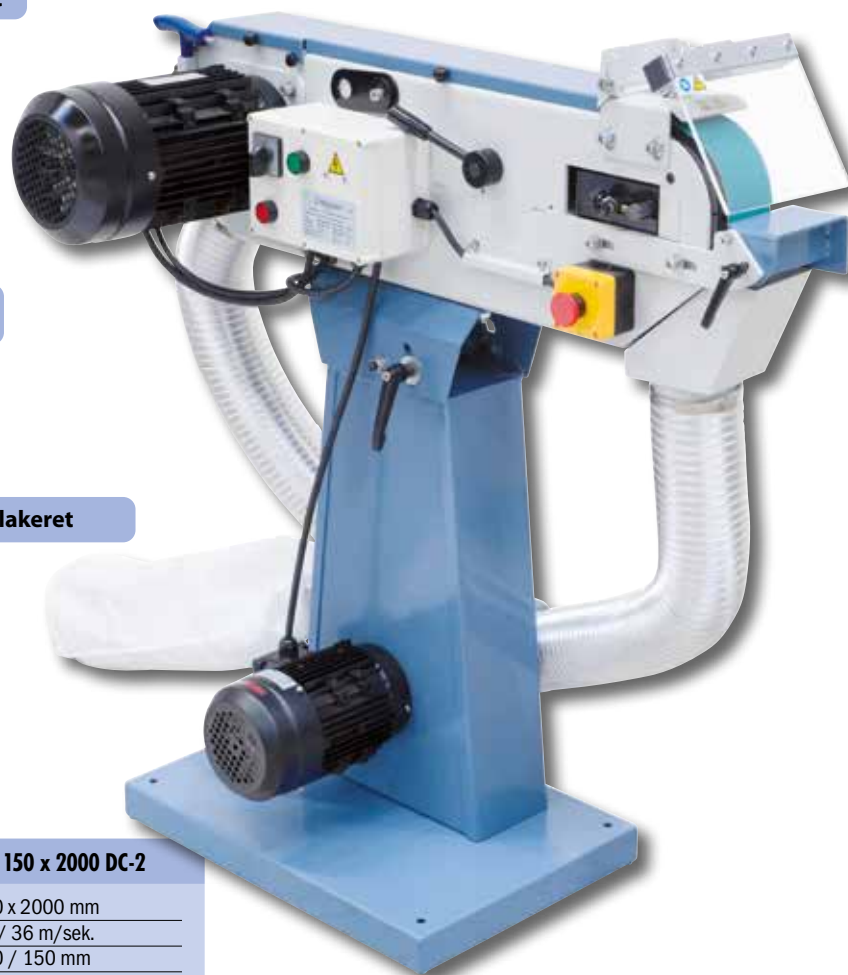
Separat knap og stor beskyttelseskærm for øget sikkerhed
