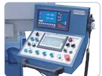
Overskuelig placering af skifteelementerne på det drejelige betjeningspanel
