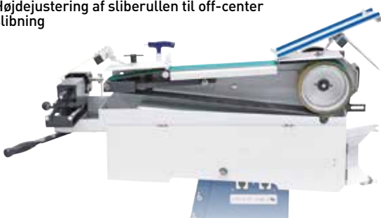
Ukompliceret skift af slibebånd takket være dækslet, der an vippes ned
