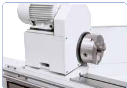
Drejeligt spindelhoved fra + 30 ° til -30 °, med trinløs hastighedsjustering
