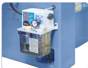
Alle føringsbaner og spindler smøres automatisk
