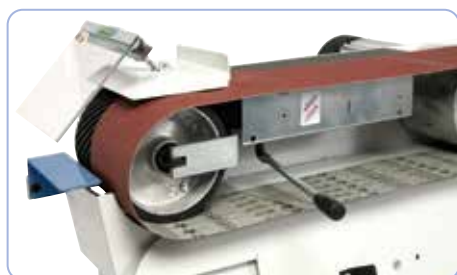
Stor kontaktskive og automatisk båndspænding
