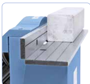
Føringsskinne i stor størrelse til sikker placering af emnet.
