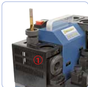
1. Reliefslibning af frivinklen Ø 2 - 13 mm 2. Reliefslibning af frivinklen Ø 8 - 32 mm
