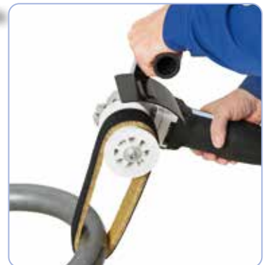
Mulighed for velcrofleece til efterbearbejdning af allerede installerede gelænder i rustfrit stål.
