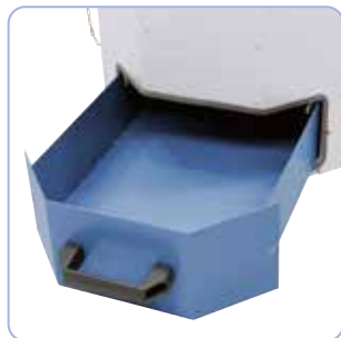
Nem bortskaffelse af slibestøv foran på maskinen
