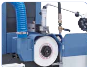
Manuel parallelafrækker med mikrometerjustering inkluderet i leveringen
