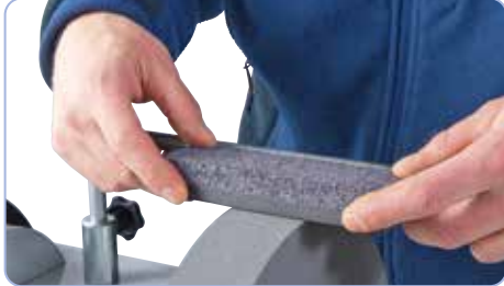
05-2050 Slibesten: Anvendes til præparering af slibeskiven (fin/grov)
