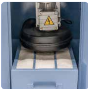
Lille pladsbehov på grund af udsugningsenhed integreret i underkonstruktionen
