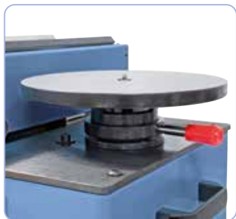
Hurtig indstilling af fasbredden ved konturfræsning ved at dreje drejeskiven.
