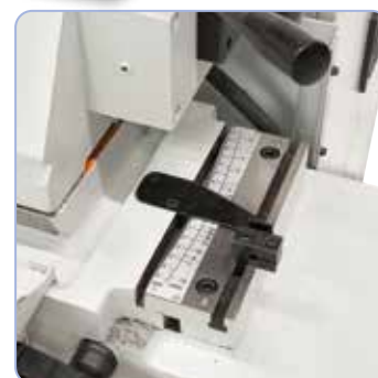
Bordet kan drejes fra +3° til -9° til konisk slibning mellem spidserne.
