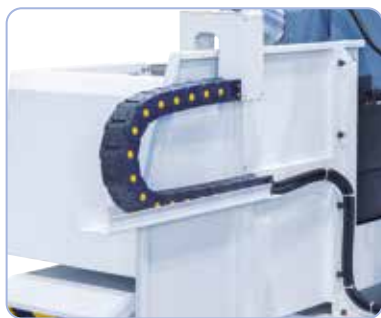
Inklusiv kabelføring via energikæde.
