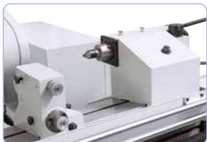
Hydraulisk pinoldok med høj nøjagtighed og stabilitet, kan flyttes ved hjælp af en fodpedal
