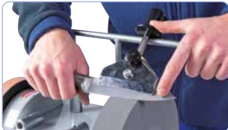
05-2057 Anordning til lange knive: Til knive fra en klingelængde på 100 mm, også egnet til træknive
