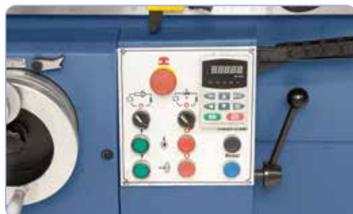
Overskueligt arrangeret og ergonomisk placeret elektronisk betjeningspanel
