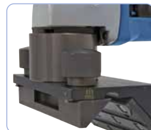
Trinløs justering af fasbredden ved hjælp af en justerbar stopskinne.
