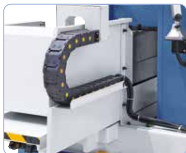
Inklusiv kabelføring via energikæde.
