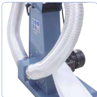
Med integreret udsugningssystem inkl. filterpose som standard
