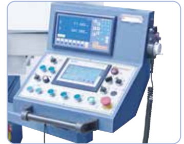
Siemens SMART panel IE V3 med berøringfølsom betjening og elektronisk håndhjul.
