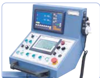
2-akset digitalt visning med LCD-display medfølger ved leveringen.
