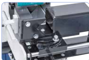
Den ønskede skærevinkel kan aflæses hurtigt og nemt ved hjælp af en skala
