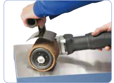
Valgfrit med en gummiluftrulle, luftpuden tilpasser sig emnets overflade.
