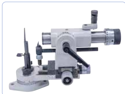
Radius- og endefræsningsenhed 50E, Slibeområde: 6 - 25 mm (tilkøb).
