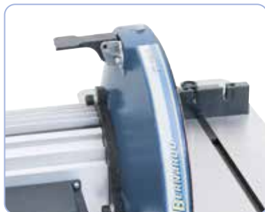
Manuel bremse stopper slibeskiven inden for få sekunder
