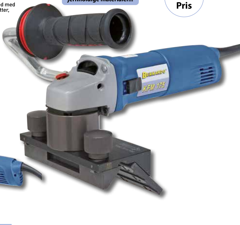
Ergonomisk håndtag, der gør arbejdet lettere, kan anvendes enten til venstre eller højre.
