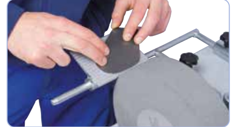
05-2056 Aflægningsbord: Optimal til slibning af diverse smådele
