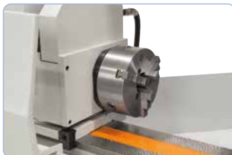
Det robuste spindelhoved kan svinges til konisk slibning op til maks. 90°.
