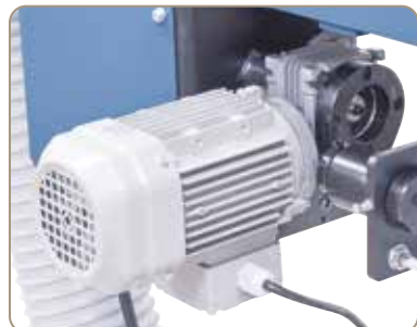
Vedligeholdelsesfri gearmotor til slibebåndets oscillation.
