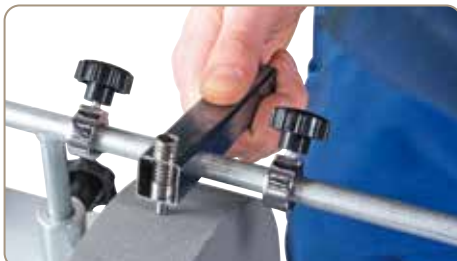
05-2058 aftrækkelig diamant-anordning: Til cirkulær og planpræcis afretning af slibeskiven
