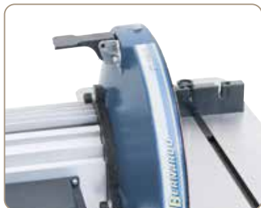
Manuel bremse stopper slibeskiven inden for få sekunder
