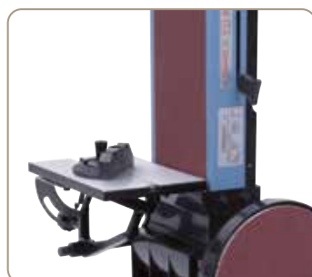
Rondelslibebord kan bruges til båndslibning.
