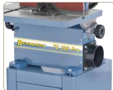
Som standard med udsugningsventilator i maskinkonstruktionen.
