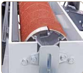
Hurtigspændesystem til fastgørelse af slibebåndet.
