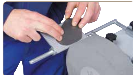
05-2056 aflægningsbord: Optimal til slibning af diverser smådele
