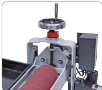
Stabilt styresystem, højdejustering ved hjælp af håndhjul.
