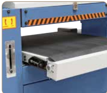
Justeringskrue til parallelkørsel af fremføringsbåndet.
