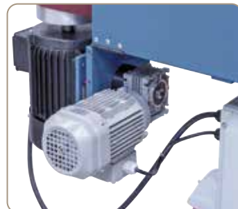
Slibebåndsoscillation med separat gearmotor.
