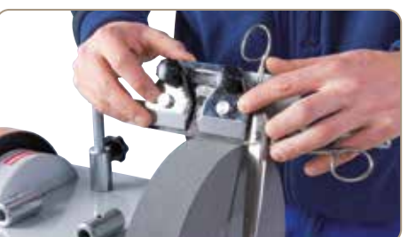
05-2055 Anordning til sakse: Optimal til lige sakse og hækkeklippere
