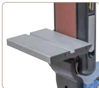
Rondelslibebord kan bruges til båndslibning.
