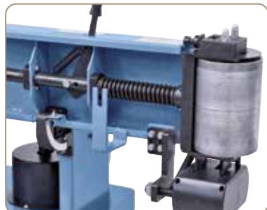
Fjederbelastet båndspænding, således automatisk udligning af båndlængdeforskelle.
