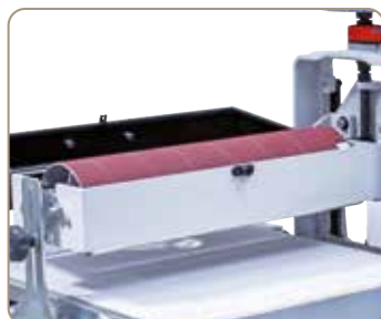
Opklappelig sugeskærm for udskiftning af slibebånd.
