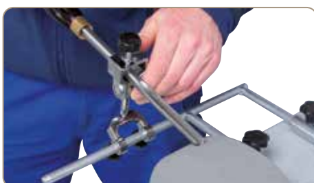
05-2052 Anordning til drejere: Værktøjsdiameter maks. 20 mm
