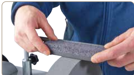
05-2050 slibesten: Anvendes til præparering af slibeskiven (fin/grov)
