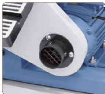
Som standard med 2 udsugningsstudser diam. 50 mm.
