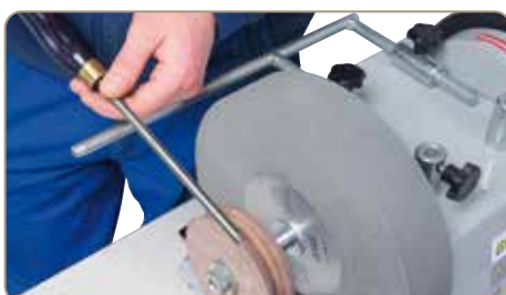
05-1809A Profileret aftrækksskive af læder: Til aftrækning og polering af indersiderne af drejere og koblen
