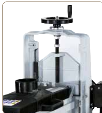
Stabilt styresystem, højdejustering ved hjælp af håndhjul.
