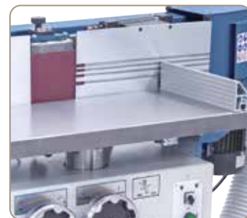
Rillet indføringslineal til finerfremspring.
