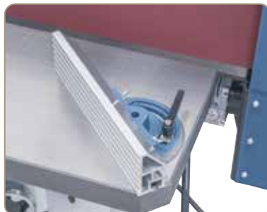
Som standard med justerbart geringsanslag og flytbar lineal.
