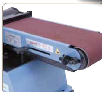
Stor planslibeflade med emnestop.
