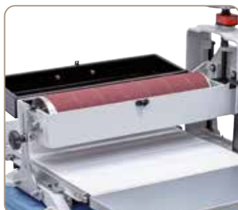
Opklappelig sugeskærm for udskiftning af slibebånd.
