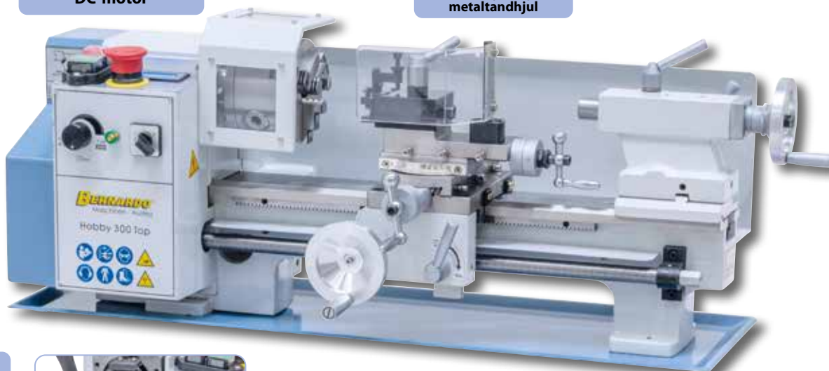
Pinoldok med MK 2 kan justeres til konisk drejning
