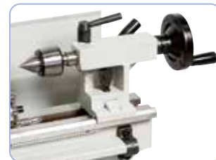
Pinoldok med MK 2 kan justeres til konisk drejning
