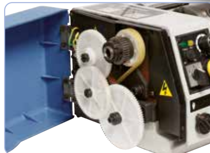
Muligt med tandhjul til gevindskæring (stigning fra 0,5 - 1,25 mm)
