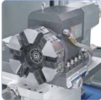
Robust værktøjsrevolver med 6 stationer.
