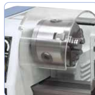
3-bakket patron 80 mm med beskyttelseskappe i henhold til CE-standard
