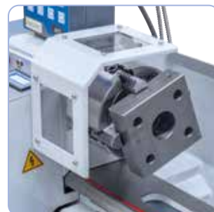
100 mm planskive (ekstraudstyr) til fastspænding af uregelmæssigt formede emner.
