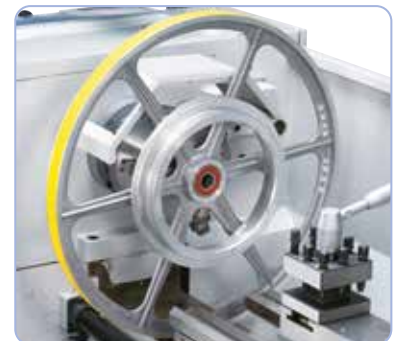
Aftagelig bro til forarbejdning af emner op til diam. 450 mm.
