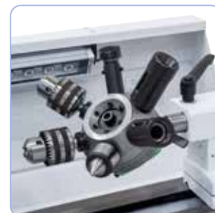
Maskinen kan udstyres med et revolverhoved, der gør maskinen økonomisk i drift
