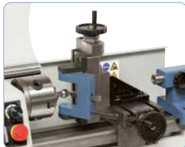
Lodret fræsestøtte med monteret kugledrejningsanordning (ekstraudstyr)
