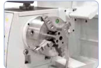
Centrisk fastspænding med 4-bakket centerpatron 200 mm, ideel til firkantede emner (ekstraudstyr).
