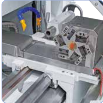
Automatisk 6-dobbelt værktøjsrevolver inkluderet i leveringen.
