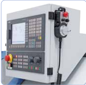
Styring Siemens 808D Avanceret som standard med mange forprogrammerede funktioner.
