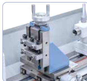
Vertikal fræsestøtte kan eftermonteres til yderligere bearbejdnings.
