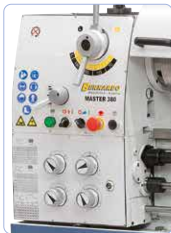
Letgående fremførings- og hastighedskontrol på gearhovedet, jævn drift takket være hærdede og slebne tandhjul, der drives i et oliebad.
