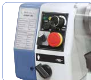
Enkel betjening, alle betjenings-elementer er centralt placeret ved spindelhovedet
