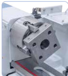
100 mm planskive (ekstra) til fastspænding af uregelmæssigt formede emner.
