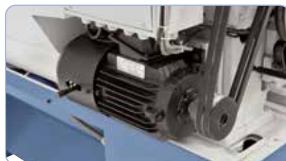
Kraftfuld drivmotor med magnetbremse i henhold til CE-standarden.
