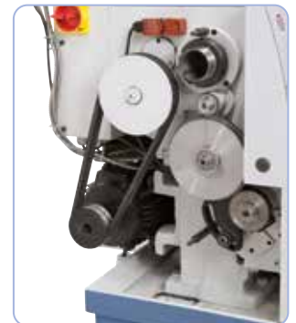
Leveringsomfang komplet med tandhjul til gevindskæring.
