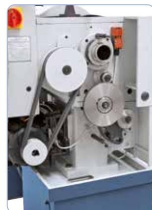
Udstyret som standard med tandhjul til gevindskæring.
