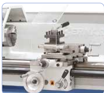
Letgående og præcis slæde med overlæde, lang levetid takket være efterjusterbare kilelister
