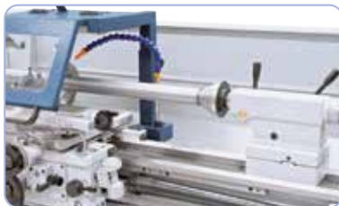
Pinol diam. 100 mm, ideel til fastspænding af rør og hule enheder (ekstraudstyr).
