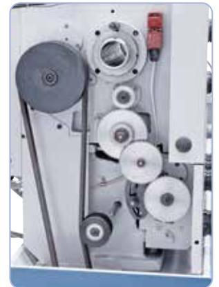
Udstyret som standard med tandhjul til gevindskæring.
