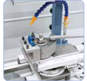
Maskinen er som standard udstyret med hurtigskiftstålholder for at effektivisere arbejdet
