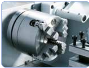
100 mm planskive (ekstraudstyr) ideel til fastspænding af asymmetriske emner.
