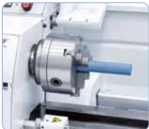
Som standard udstyret med en 38 mm spindelboring til bearbejdning af store akseldiameter
