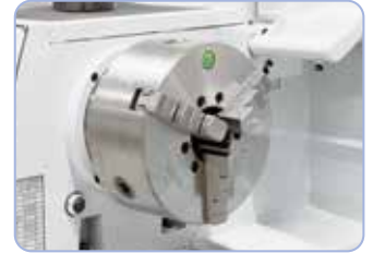
Fordel ved Bernardo-bakkepatronen DK11-200 mm / D5: Der kan leveres monoblok, grund-, vendbare bakker og topbakker
