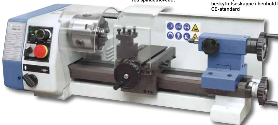
Enkel betjening, alle betjenings-elementer er centralt placeret ved spindelhovedet
