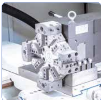
Robust værktøjsrevolver med 8 stationer.
