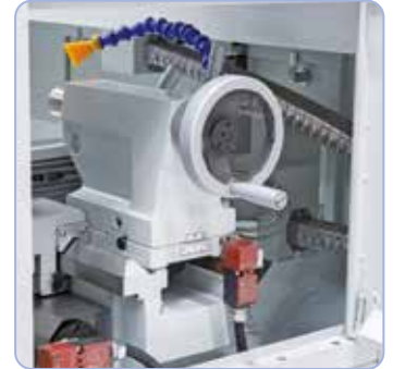
Den robuste pinoldok med pinolholder MK 4 kan justeres til konisk drejning.
