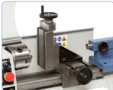
Fås som ekstraudstyr: Vertikal-fræseunderstøtning med en påspændingsoverflade på 64 x 130 mm
