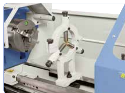
Fast brille med bronzestyling til stabilisering af lange emner
