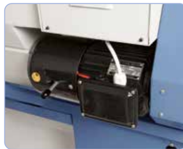
Kraftfuld drivmotor med magnetbremse i henhold til CE -standarden
