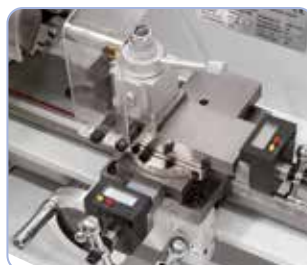
Maskinen er udstyret med hurtigskiftstålholder for at effektivisere arbejdet.
