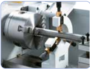
Fast brille med bronzestyring til stabilisering af lange emner.
