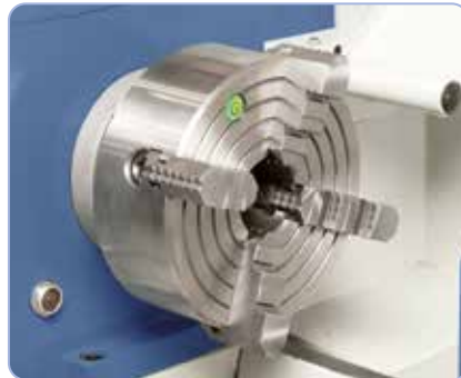
200 mm planskive (standard) ideel til fastspænding af asymmetriske emner
