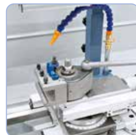
Maskinen er som standard udstyret med hurtigskiftstålholder for at effektivisere arbejdet
