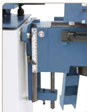
Borebordets indstillede arbejdshøjde aflæses på skalaen.
