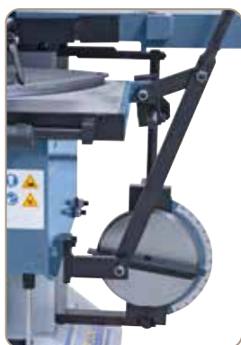
Standardmæssigt med skabelonanordning til boring af skrå slidser
