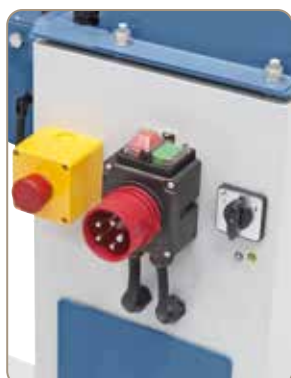
Nødstop og drejeknap på siden af maskinens konstruktion
