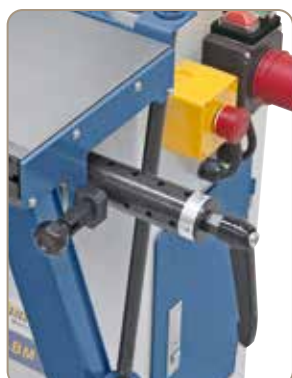
Som standard med dyvelboreanordning, gitterinddeling 16 / 20 / 22 / 25 mm.
