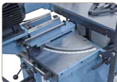
Boreaggregat kan drejes 60° til højre og venstre
