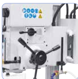
Som standard med 3 automatiske borefremføringer.
