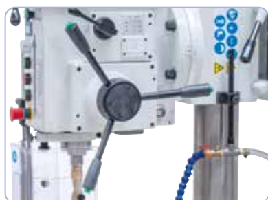
Som standard udstyret med automatisk 3-dobbelt borefremføring
