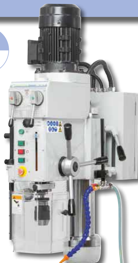
Betjeningselementer, der er placeret overskueligt og let tilgængeligt på forsiden af maskinen.
