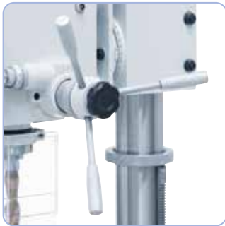
Spindelpositioneringen udføres ved hjælp af ergonomiske håndgreb
