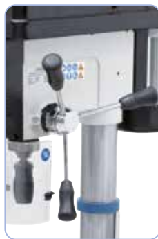
Letgående positionering vha. ergonomisk placerede håndgreb.
