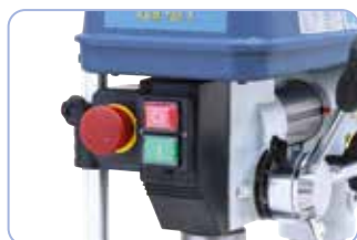
Tænd-sluk-kontakt iht. IP 54 og separat nødstop
