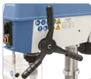
Positioneringen udføres ved hjælp af ergonomiske håndhjul
