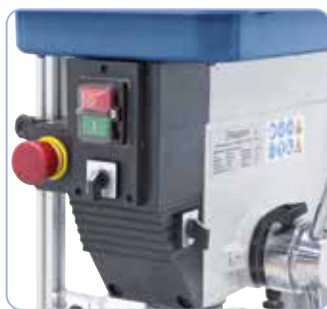
Nødstop, retningskontakt og 2-trinskontakt på forsiden af maskinen.
