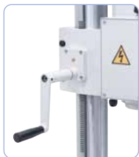
Nem højdejustering af borehoved vha. håndsving.
