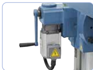
Komfortabel, motoriseret bordhøjdejustering.
