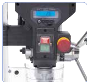
Tænd-sluk-kontakt iht. IP 54 og separat nødstop iht. CE-standard
