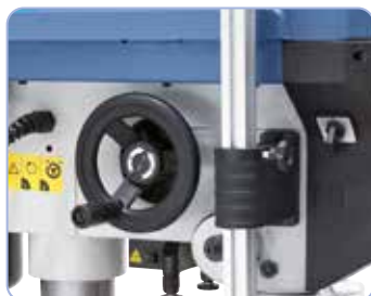
Håndhjul, der er placeret i siden, til indstilling af det ønskede omdrejningstal
