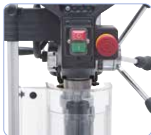
Tænd-sluk-kontakt iht. IP 54 og separat nødstop iht. CE-standard
