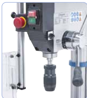
Som standard udstyret med en selvspændende borepatron 1 - 16 mm / B 16
